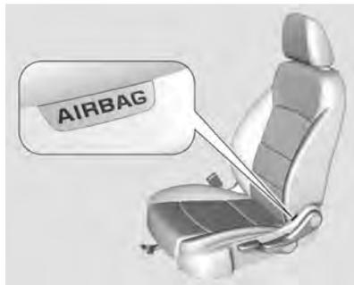
O sistema de airbags laterais consiste em um airbag em cada encosto do banco dianteiro. Isso pode ser identificado pela palavra AIRBAG.
