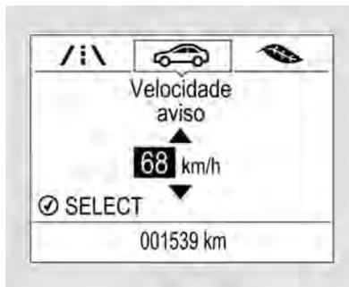
A função de advertência de velocidade é ativada quando uma determinada velocidade é atingida.
