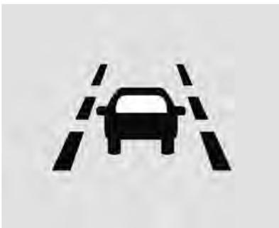
Quando o indicador de controle
