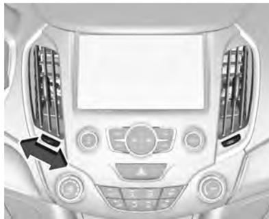
Para abrir os difusores de ar centrais, gire a rodinha do ajuste para a direita. Para abrir os difusores de ar laterais, gire a rodinha de ajuste para cima. Ajuste a quantidade de ar na saída do difusor girando a rodinha de ajuste.
