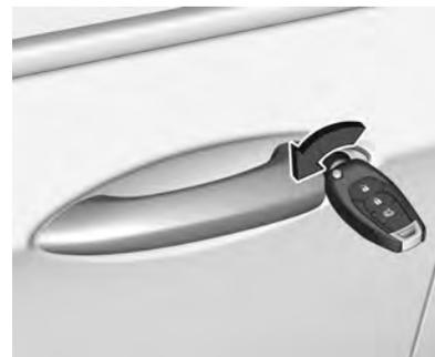
Destrave manualmente a porta do motorista inserindo e girando a chave no cilindro da trava.
