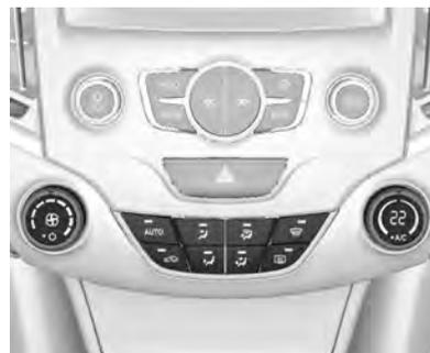
No modo automático de temperatura, a velocidade do ventilador e a distribuição de ar são regulados automaticamente.
