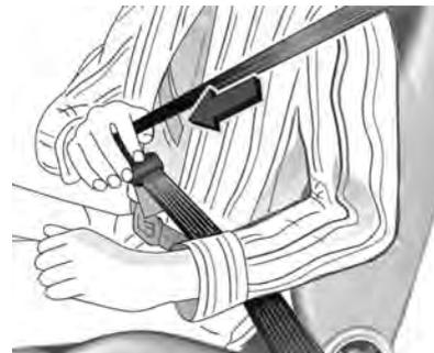
Retire o cinto do retrator, oriente-o destorcido pelo corpo e empurre a trava para dentro da fivela até ouvir um clique. Aperte o cinto abdominal regularmente ao dirigir puxando o cinto de três pontos.
