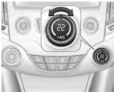
Se a temperatura mínima Lo estiver ajustada, o sistema de controle de climatização funciona para o resfriamento máximo, se o resfriamento A/C estiver ligado.
