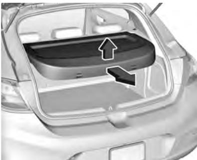
Levante a tampa na parte traseira e empurre-a para cima na parte da frente.
