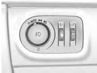
Quando a função de controle automático das luzes está ligada e o motor está a trabalhar, o sistema alterna entre luzes de circulação diurna e faróis que dependem automaticamente das condições de luminosidade e da informação dada pelo sistema do sensor de chuva.
