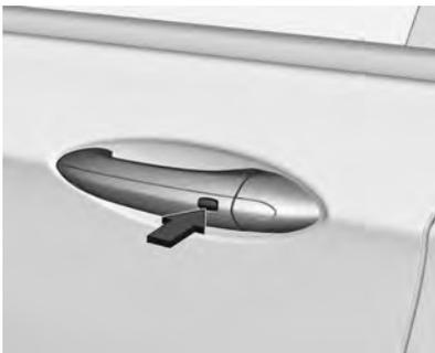
Com as portas destravadas e a chave eletrônica dentro do alcance da alavanca da porta, pressione o botão na respectiva alavanca externa da porta.
