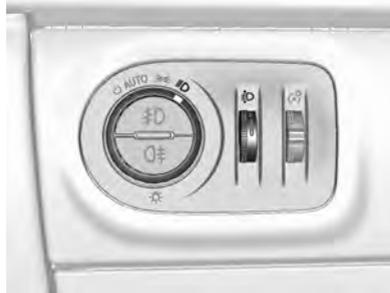
Para adaptar o alcance do farol à carga do veículo e evitar ofuscamento: gire a roda
