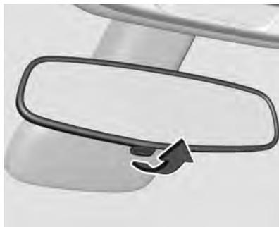
Para reduzir o ofuscamento, ajuste a alavanca na parte inferior da moldura do espelho.
