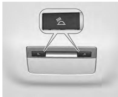
Acende junto com a luz de cortesia dianteira dependendo da posição do interruptor basculante.
