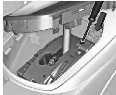
3. Insira uma chave de fenda na abertura até o ponto onde ela alcançar e mova a alavanca seletora da posição P. Se P for engatada de novo, a alavanca seletora ficará bloqueada na posição novamente. Dirija até uma Concessionária ou Oficina Autorizada Chevrolet assim que possível para verificar e consertar.
