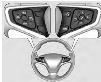
Centro de informações do motorista, alguns sistemas de assistência ao motorista, sistema de Conforto e conveniência e um telefone celular conectado podem ser operados pelos comandos no volante.
