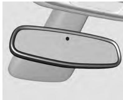
O ofuscamento por veículos que o seguem à noite é automaticamente reduzido.
