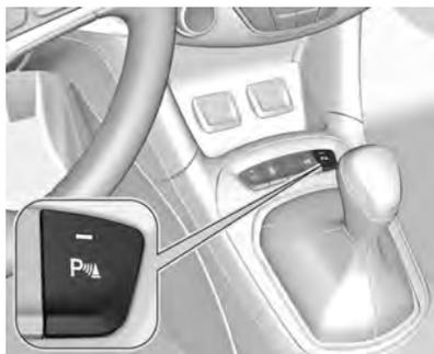
Pressione o botão do Sistema auxiliar de estacionamento **P** para desativar, o LED no botão apaga.
