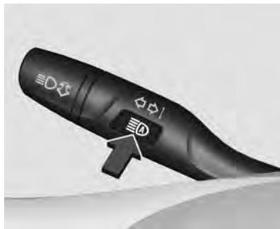
Ative a assistência para farol alto pressionando
