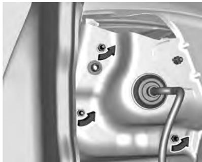
1. Retire três porcas de fixação de plástico da parte interna.
