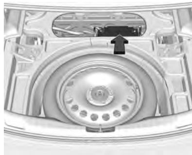
A bateria do veículo se localiza no compartimento de carga sob a tampa na frente do pneu reserva. Existem pontos de conexão para partida do motor com cabos auxiliares no compartimento do motor. Consulte *Partida com cabos auxiliares* ⇨ 272.
