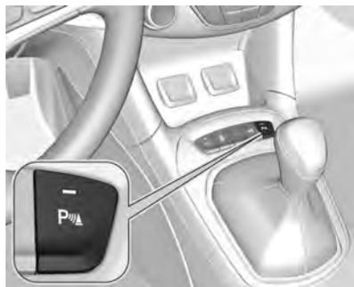
Um LED aceso no botão do Sistema auxiliar de estacionamento **P** indica que o sistema está pronto para operar.
