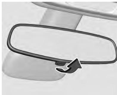
Caso equipado com espelho retrovisor manual, pressione a aba para frente durante o dia e puxe-a para visão noturna para evitar o ofuscamento pelos faróis dos veículos na traseira.
