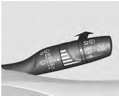
Empurre a alavanca em direção ao painel de instrumentos.
