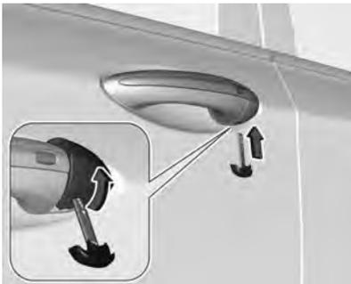
**Chave eletrônica:** para remover a tampa, pressione o botão na lateral e extraia a lâmina da chave de carcaça. Insira a chave do lado inferior da tampa na ranhura e gire a chave para cima.
