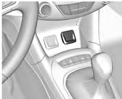
Uma tomada de energia de 12 volts está localizada no console dianteiro. Dobre a tampa para cima.
