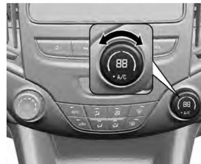
Pressione o botão A / C para ligar o resfriamento. A ativação é indicada pelo LED no botão. O resfriamento só é funcional quando o motor estiver funcionando e o ventilador do Sistema de ventilação e ar condicionado estiver ligado.
