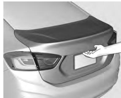
Pressione o interruptor de toque sob a moldura da tampa do porta-malas para abrir quando o veículo está destravado.
