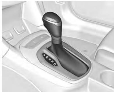
**P** : Esta posição trava as rodas motrizes. É a melhor posição para dar a partida, pois a mesma impede que o veículo se movimente com facilidade.
