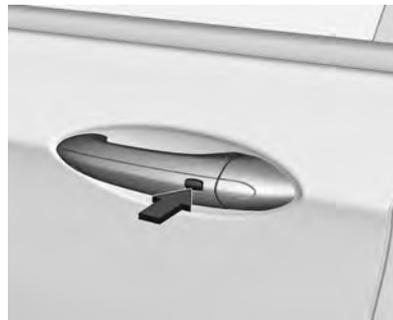
Com as portas destravadas e a chave eletrônica dentro do alcance da maçaneta da porta, pressione o botão na respectiva maçaneta externa de qualquer porta dianteira.
