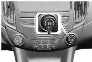
Pressione A / C para ligar o resfriamento. A ativação é indicada pelo LED no botão giratório direito. O resfriamento só é funcional quando o motor estiver funcionando e o ventilador do Sistema de ventilação e ar condicionado estiver ligado.
