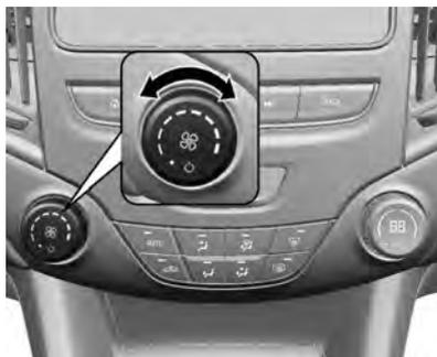
Ajuste a velocidade do ventilador desejada usando o botão giratório esquerdo. A velocidade do ventilador é indicada pelo número de segmentos acesos no botão giratório esquerdo.
