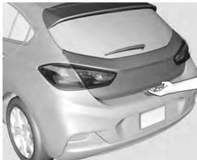
Para abrir a tampa do compartimento de carga depois de destravar, pressione o interruptor na parte inferior da tampa do compartimento de carga.
