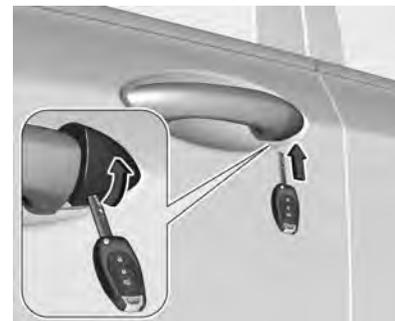
**Controle remoto:** para remover a tampa, desdobre a chave mecânica pressionando o botão no controle remoto. Insira a chave do lado inferior da tampa na ranhura e gire a chave para cima.
