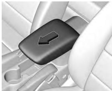
O apoio de braço pode ser deslizado 10 cm para frente. Há um porta-objetos sob o apoio de braço.
