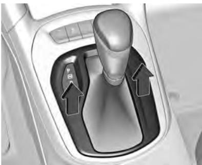
2. Pressione a alavanca seletora do console central na parte de trás para liberá-la, dobre para cima e gire-a para a esquerda.
