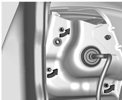
3. Retire três porcas de fixação de plástico da parte interna.
