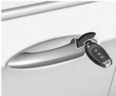
Destra manualmente a porta do motorista inserindo e girando a chave no cilindro da trava.
