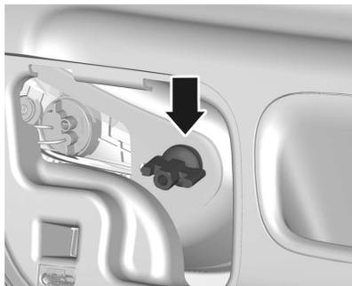
3. Retire as porcas de fixação de plástico da parte interna.
