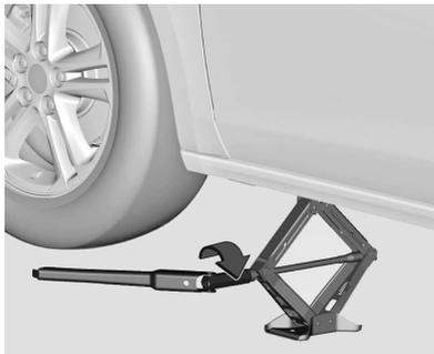
Conecte a chave de roda e, com o macaco corretamente alinhado, gire-a até que o pneu se erga do chão. Não levante mais o macaco.
