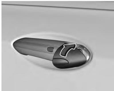
Após travar instale a tampa em cima do cilindro da trava: insira a tampa com o lado inferior nas ranhuras e gire e pressione a tampa até que engate no lado superior.
