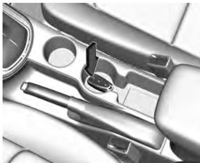
Coloque a chave eletrônica centralizada na área do transmissor no sentido longitudinal plano com botões para cima, como mostra a ilustração. Outros objetos, por exemplo, chaves, transponder, identificadores, moedas etc., devem ser removidos do console central.
