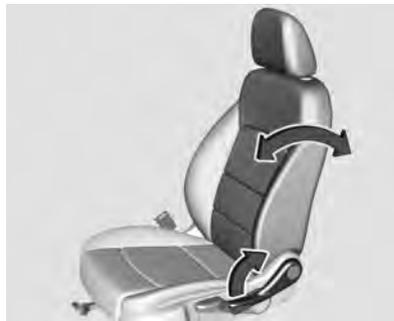
Puxe a alavanca, ajuste a inclinação e solte a alavanca. Deixe o encosto engatar de forma audível. Tente mover o banco para frente e para trás para certificar-se de que o banco esteja travado na posição.
