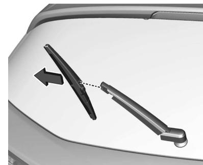
Levante a alavanca do limpador. Desengate a palheta, como mostrado na ilustração, e remova-a.
