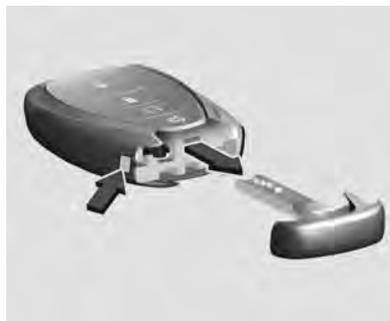
O elemento mecânico incluso na chave deve ser usado para a operação manual caso o sistema central de travamento falhe.
