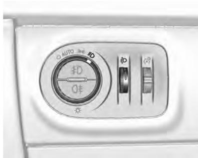
Para adaptar o alcance do farol à carga do veículo e evitar ofuscamento: gire a roda para a posição necessária.
