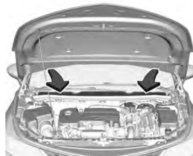
A entrada de ar em frente ao para-brisa no compartimento do motor deve estar desobstruída para permitir a entrada do ar. Remova folhas, sujeira ou neve.
