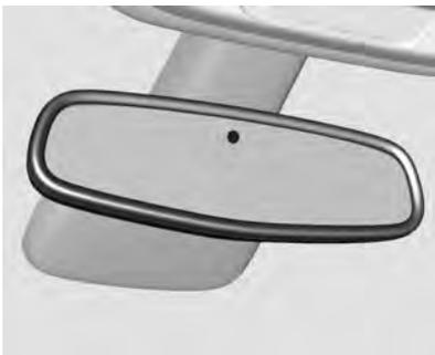
Se equipado, o regulador automático de intensidade de luz reduz o brilho dos faróis traseiros. O recurso de regulador de intensidade de luz é ativado após a partida do veículo.
