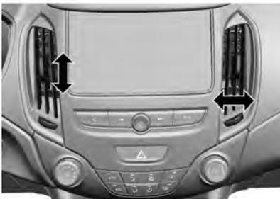
Direcione o fluxo de ar inclinando as aletas e a roda do ajustador.
