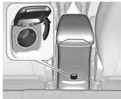
Uma tomada de energia de 12 volts está localizada no console traseiro. Dobre a tampa para cima.
