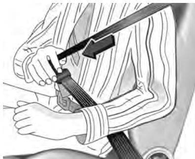
Retire o cinto do retrator, conduza-o pelo corpo, sem torcer, e empurre a lingueta de acoplamento na fivela até que encaixe. Aperte o cinto subabdominal regularmente ao dirigir puxando o cinto diagonal sobre o ombro.
