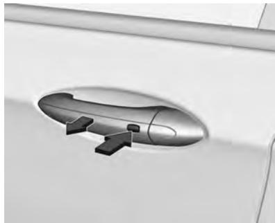
Com as portas travadas e a chave eletrônica dentro do alcance da alavanca da porta, pressione o botão na respectiva alavanca e puxe-a.
