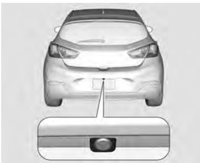
Para modelos Hatch, a câmera é montada acima da placa de licenciamento e possui um ângulo de visão de 130° para RVC analógico e 190° para RVC digital.
