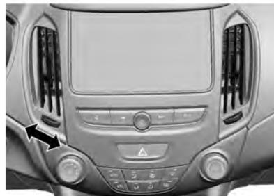
Para abrir os difusores de ar centrais, gire a rodinha do ajuste para a direita. Para abrir os difusores de ar laterais, gire a rodinha de ajuste para cima. Ajuste a quantidade de ar na saída do difusor girando a rodinha de ajuste.
