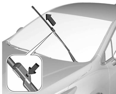
Erga o braço do limpador de para-brisa, pressione o botão para desengatar e remover a lâmina do limpador.
