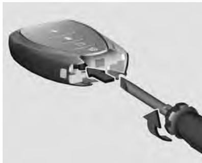
2. Insira uma chave de fenda no centro da ranhura e separe a tampa traseira da unidade eletrônica girando a chave de fenda um quarto de volta.
