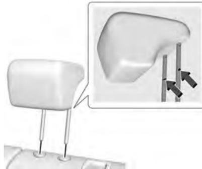
1. Insira os suportes dos apoios de cabeça nos orifícios no topo do encosto do banco. Os encaixes nos suportes devem estar virados para o lado do motorista do veículo.
