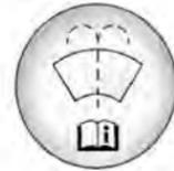
Encha com água limpa misturada com uma quantidade adequada de aditivo para limpeza de para-brisa.
