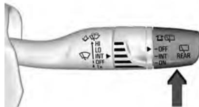
Gire a extremidade da alavanca do limpador do para-brisa para operar o limpador / lavador do vidro traseiro.
