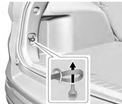
5. Direcione a extremidade do laço da faixa por uma das amarrações de carga na traseira do veículo. Em seguida, direcione o gancho pelo laço e puxe a faixa para apertar ao redor da amarração de carga.
