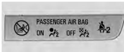
Se o veículo tiver um interruptor de desativação do airbag, ele também contará com um indicador de status do airbag do passageiro, localizado no console do teto.
