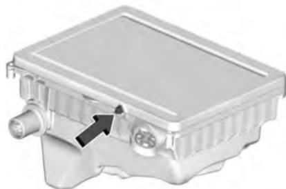
1. Alinhe o filtro de ar com o ponto indicado na base do respectivo compartimento, e instale o filtro de ar. A vedação externa do filtro de ar deve ser instalada corretamente no respectivo compartimento.
