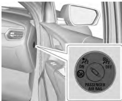
Se o painel de instrumentos possuir o interruptor mostrado na figura, então o veículo possui um interruptor de ativação-desativação do airbag que pode ser usado para desativar manualmente o airbag do passageiro externo.
