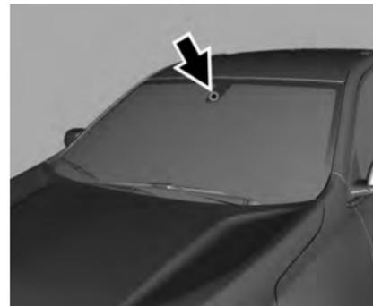
Há um sensor de luz atrás do espelho retrovisor interno. Mantenha a área do sensor limpa, caso contrário, os faróis serão ligados quando não são necessários.
