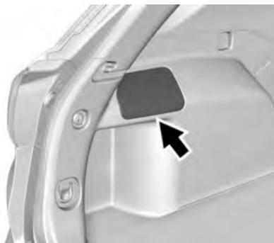
A caixa de fusíveis do compartimento traseiro fica atrás de um painel de acabamento na lateral do compartimento traseiro.
