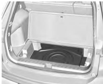
Levante o assoalho de carga e dobre-o para acessar o compartimento de carga.
