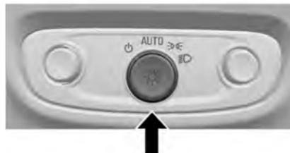
O controle das luzes externas está localizado no painel de instrumentos, no lado esquerdo da coluna de direção.
