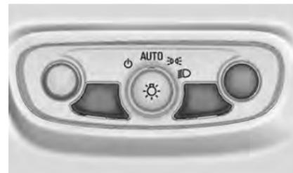
Se equipado, os interruptores dos faróis de neblina estarão localizados no painel de instrumentos à esquerda da coluna de direção, perto do interruptor de controle das lâmpadas externas. A localização dos interruptores pode variar dependendo das
