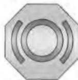
O reservatório do cilindro mestre do freio é abastecido com fluido de freios DOT 4 aprovado pela GM, conforme indicado na tampa do reservatório. Consulte *Vista geral do compartimento do motor* ⇨ 224 para ver o local do reservatório.
