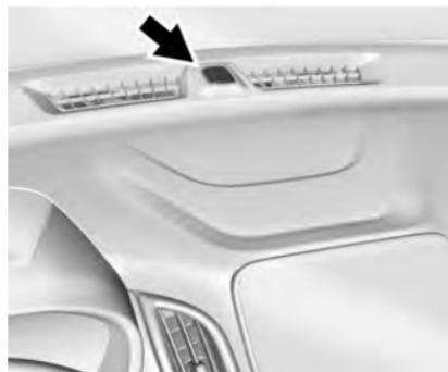
A luz indicadora, no painel de instrumentos próximo do para-brisa, indica o status do sistema:
