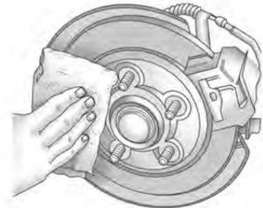
13. Remova ferrugem ou sujeira dos parafusos da roda, das superfícies de montagem e do pneu reserva.
