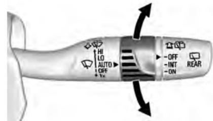
**AUTO** : Mova a alavanca do limpador do para-brisa para AUTO. Gire a faixa na alavanca do limpador para ajustar a sensibilidade.
