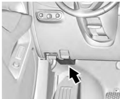
A caixa de fusíveis do painel de instrumentos se encontra embaixo do painel de instrumentos no lado do motorista.
