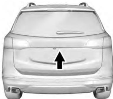
Para abrir a tampa do porta-malas, pressione a superfície tátil sob a alça da tampa do porta-malas e levante.
