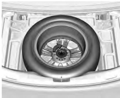
Prenda o pneu danificado com a parte interna para cima com a porca borboleta na cavidade do pneu reserva em cima da caixa de ferramentas.
