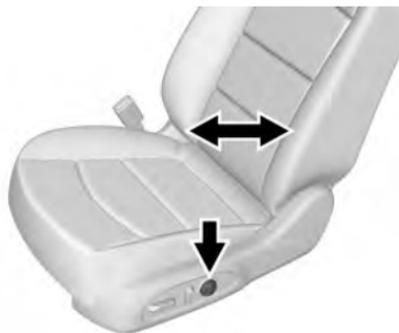
Se equipado, mantenha pressionada a dianteira ou a traseira do controle para aumentar ou diminuir o apoio da lombar.
