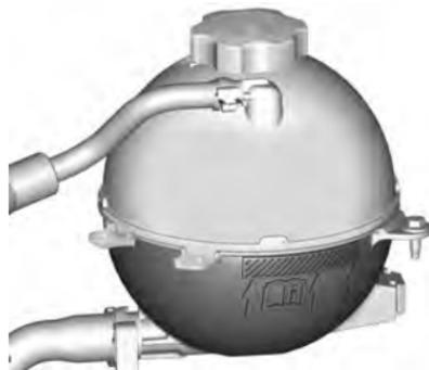
Verifique se o líquido de arrefecimento está visível no reservatório de expansão. Caso o líquido de arrefecimento contido no reservatório de expansão esteja fervendo, não faça mais nada até que o líquido esfrie. Se o líquido de arrefecimento estiver visível mas a marca do nível não estiver, adicione uma mistura na proporção de 50:50 de água limpa e potável e líquido de arrefecimento DEX-COOL, no reservatório de expansão até o ressalto superior no meio do tanque, mas
