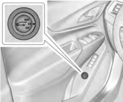
O interruptor da tampa do porta-malas está na porta do motorista. O veículo deve estar em P (Estacionamento). As lanternas traseiras piscam quando a tampa elétrica do porta-malas se move.
