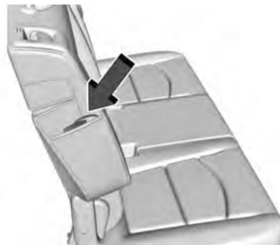
1. Remova a guia do compartimento de carga na lateral do encosto do banco.
