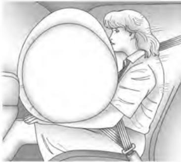
O airbag do passageiro dianteiro está no painel de instrumentos do lado do passageiro.
