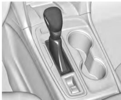
**P** : Esta posição trava as rodas dianteiras. Use P (Estacionamento) ao dar partida no motor, pois o veículo não pode se mover facilmente.
