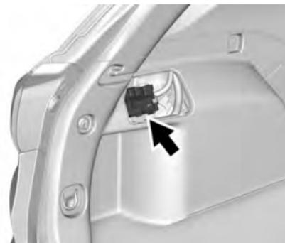
Remova a placa de acabamento para acessar a caixa de fusíveis.
