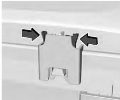
Para remover a tampa da caixa de fusíveis, aperte os grampos na tampa e levante-a na vertical.
