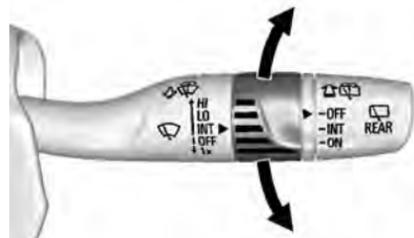
**INT** : Use para limpezas intermitentes ou sensor de chuva, se equipado e ativado. Para ajustar o ciclo de limpeza, aumente a banda para cima para limpezas mais frequentes ou para baixo para limpezas menos frequentes. Se o sensor de chuva estiver ativado, consulte “sensor de chuva” mais adiante nesta seção.
