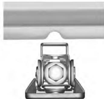
9. Posicione a cabeça do macaco no local mais próximo ao pneu furado. A localização é indicada por um entalhe na borda inferior vertical da folha de metal lateral do corpo.
