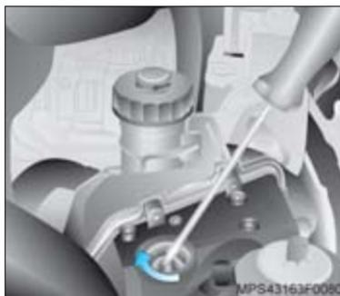
**Atenção!** Certifique-se de que as alças da tampa estejam fixadas através da chave de fenda, pois a ferramenta poderá cair no compartimento do motor.
