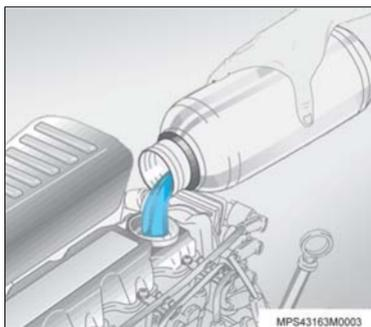
Se precisar completar o nível, use sempre o mesmo tipo de óleo utilizado na última troca. O seu veículo sai de fábrica abastecido com óleo de classificação API-SL e viscosidade SAE 5W30.
