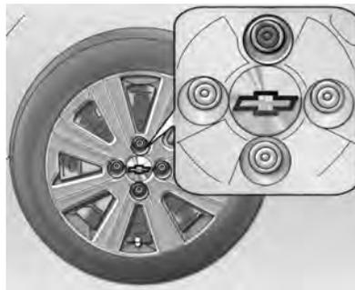
16. Instale os parafusos e aperte-os parcialmente.
