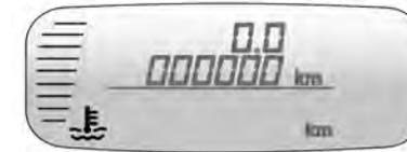
Exibe a temperatura do líquido de arrefecimento do motor.
