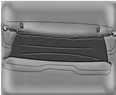
A rede de conveniência armazena objetos leves e pequenos que não ultrapassem suas medidas, não objetos pontiagudos. Antes de usá-la, certifique-se de estar presa nos quatro pontos de fixação.
