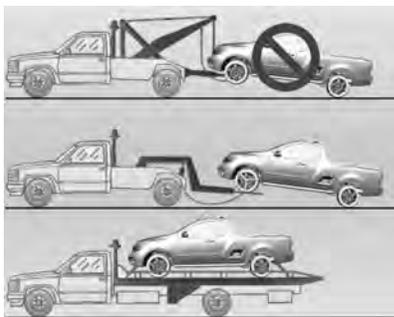
Em situações de emergência que exijam o reboque do veículo, procure, de preferência, empresas especializadas em guinchos ou a assistência oficial da rodovia, usando veículos de reboque que tenham apoio para as rodas ou plataforma para receber o automóvel.
