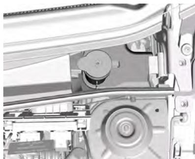
O reservatório de líquido do sistema de lavagem do para-brisa fica situado na lateral esquerda do compartimento do motor. O volume do reservatório é de aproximadamente 2,6 litros. Para uma limpeza eficiente, recomenda-se acrescentar à água um aditivo de limpeza.
