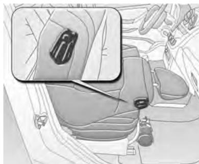
O encosto do banco do passageiro pode ser rebatido até a posição horizontal do encosto puxando a alavanca localizada na parte superior externa do encosto.
