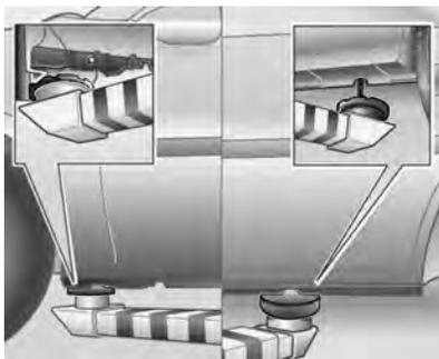
Os pontos de apoio de um elevador ou macaco devem ser posicionados somente nos locais indicados nas figuras, nas porções dianteira
