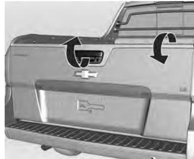
Para abrir, puxe a maçaneta central e abaixe a tampa. Para fechar, levante a tampa e pressione as extremidades superiores até ouvir um som de travamento.
