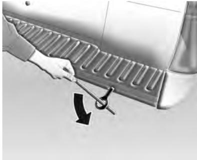
O orifício para instalar o gancho de reboque fica localizado no para-choque traseiro do veículo (lado direito).
