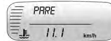
Esta mensagem é exibida e soa um alarme se o sistema de arrefecimento do motor atingiu temperaturas inseguras para operação. Pare e desligue o veículo o mais rápido possível para evitar danos graves. Esta mensagem é excluída quando o motor esfriar a uma temperatura segura de operação.
