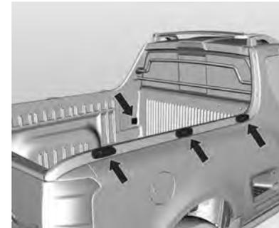
Nas porções externas e internas da caçamba, existem ganchos para encaminhar as cordas ou fixadores plásticos para imobilizar a carga.
