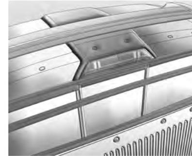
As luzes do compartimento de carga se localizam no compartimento do brake-light, para acender ou apagar pressione o botão no painel de instrumentos ao lado do botão do pisca-alerta.
