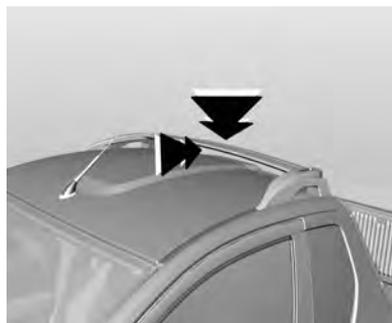
A barra do teto não foi projetada para qualquer tipo de carga e não proteger os ocupantes do veículo no caso de capotamento.
