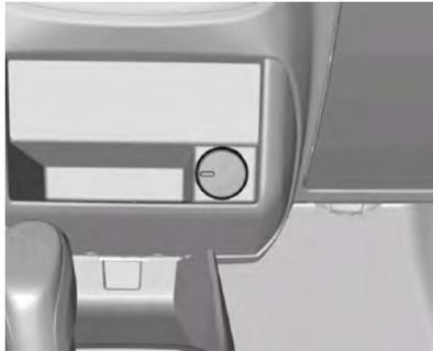
Existe apenas uma tomada de 12 V no painel central que permite a conexão de aparelhos elétricos, como carregadores de telefones celulares e outros acessórios. O fornecimento de energia máximo para os acessórios não deve exceder a 120 watts para tomada de energia.
