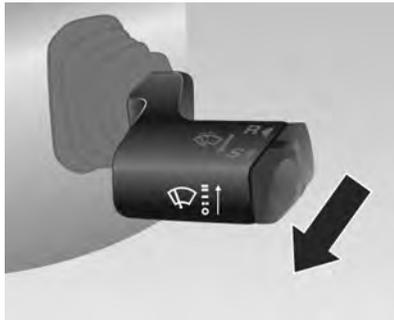
Puxe a alavanca para pulverizar água e movimentar as lâminas do limpador; quando liberada ocorrem alguns movimentos adicionais.
