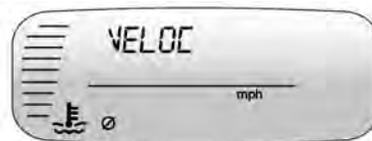
A tela de velocidade média do veículo exibe a velocidade média do veículo em milhas por hora (mph) ou quilômetros por hora (km/h).
