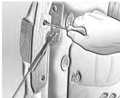
2. Solte os dois parafusos de fixação da lanterna como mostrado na figura.
