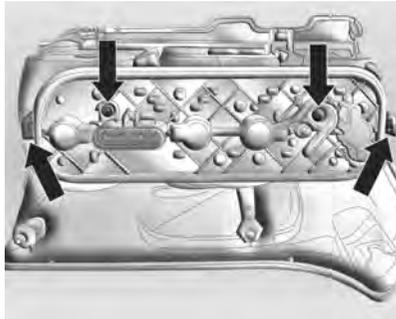
6. Solte os dois parafusos e as duas travas, como mostrado na Fig.
