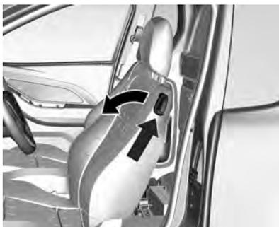
Para rebater o encosto do banco mova a alavanca de destravamento, localizada no lado superior externo do encosto, para cima e simultaneamente, puxe o encosto para frente.
