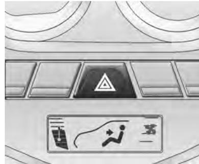
Pressione este botão localizado no painel de instrumentos próximo do sistema de controle de ventilação e ar condicionado, para fazer com que as luzes indicadoras dos sinalizadores de direção dianteiros e traseiros pisquem. Isto avisa os outros que você tem uma emergência e só deve
