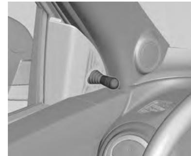
Os espelhos retrovisores externos podem ser ajustados com facilidade por meio das alavancas de ajuste no veículo. Mova a alavanca de ajuste instalada no painel da porta para executar o ajuste da posição.
