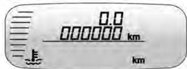
O hodômetro e o hodômetro parcial se localizam na porção superior do visor do painel de instrumentos.
