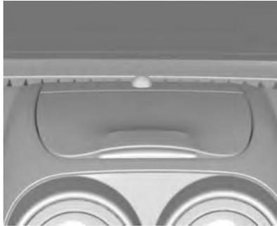
O sensor de iluminação localiza-se na parte superior do painel de instrumentos e acende/apaga o farol baixo quando o controle das luzes de lanterna está no modo AUTO.
