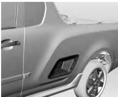
Existem dois degraus laterais para facilitar o acesso à caçamba a partir das laterais do veículo. Além desses degraus laterais, também é possível usar o para-choque traseiro para acessar a caçamba. A capacidade de carga sobre os degraus é de 120 kg.
