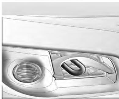
O olhal de reboque só deve ser usado para rebocar e não para recuperar o veículo.
