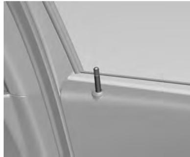
Pressione os pinos de travamento para operar as travas das portas de dentro do veículo. Se, inadvertidamente, a trava da porta do motorista se trava ao fechar, a alavanca retornará para a posição de destravamento. Isto evitará que o veículo seja travado com a chave dentro.
