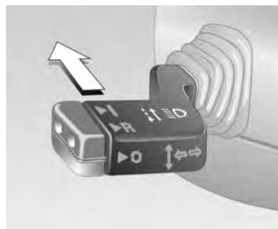
Com botão dos faróis na posição  $\equiv D$ , o farol alto é obtido empurrando-se a alavanca para a frente. Par voltar para a condição de farol baixo, a alavanca deve ser empurrada para a frente novamente.
