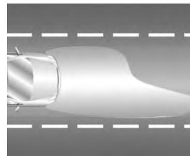
O farol baixo é projetado de forma a iluminar determinadas áreas com mais intensidade, fornecendo uma visualização da sinalização e reduzindo o efeito de ofuscamento para os motoristas que vêm na pista oposta. Essas regiões e intensidade de luz são normatizadas (as resoluções CONTRAN 227/07 e 294/08) e os faróis do seu veículo foram projetados para atender às regras de segurança e fornecer melhor desempenho de iluminação do veículo. Desta maneira,
