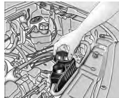
O sistema de arrefecimento do motor é abastecido com um aditivo para radiador de longa duração (etilenoglicol), cujas propriedades conferem proteção adequada contra congelamento, ebulição e corrosão.
