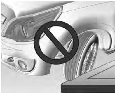
Os impactos contra as guias da calçada podem causar lesões nas rodas e pneus. Há risco de acidentes a alta velocidade devido a danos externos ocultos nos pneus. Portanto, se for preciso subir em uma guia, faça-o lentamente e no ângulo reto, se possível.
