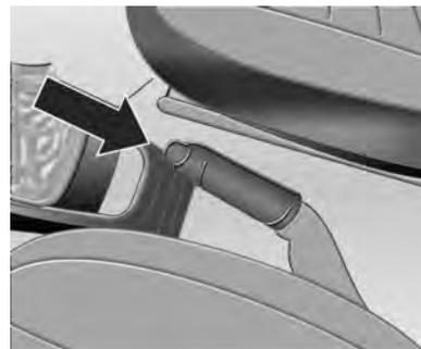
Para soltar o freio de estacionamento, puxe a alavanca ligeiramente para cima, aperte o botão na sua extremidade (seta) e empurre-a para baixo até a lâmpada indicadora (P) do painel apagar.
