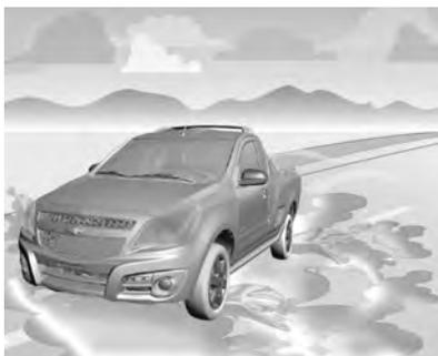
O excesso de água poderá acumular sob os pneus de modo que eles não tenham contato com a pista e isto é muito perigoso. Isto poderá acontecer se houver muita água na pista e se você estiver em alta velocidade. Quando o veículo está aquaplanando, há pouco ou nenhum contato do pneu com a pista.
