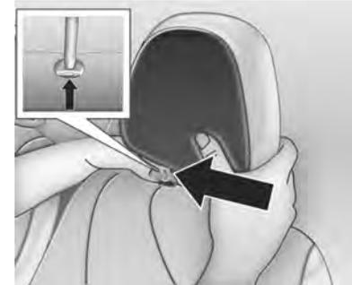
Para ajustar o apoio de cabeça, pressione o botão de destravamento (seta) e deslize o apoio de cabeça usando a mão para levantar ou abaixar. O apoio de cabeça pode ser posicionado em três alturas diferentes.
