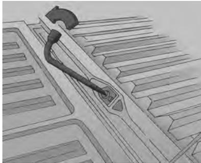
1. Instale a porção chanfrada da chave de roda (extremidade ranhurada) no eixo do sistema de elevação do pneu reserva.
