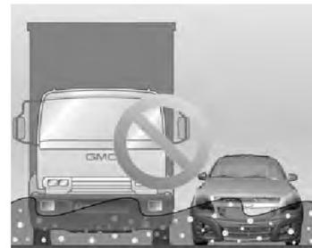
Quando for realmente preciso atravessar um trecho alagado, faça-o sempre em baixa velocidade, em torno de 10 km/h, utilizando a primeira marcha.
