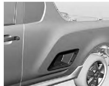
Existem dois degraus laterais que podem tornar mais fácil o acesso à plataforma de carga a partir da lateral do veículo. Além desses degraus laterais, você também pode usar o para-choque traseiro para facilitar o acesso à plataforma de carga. A capacidade de carga sobre os degraus é de 120 kg.
