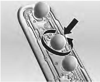
9. Retire a lâmpada queimada empurrando-a para baixo e girando-a no sentido anti-horário; insira a nova lâmpada realizando o procedimento contrário.
