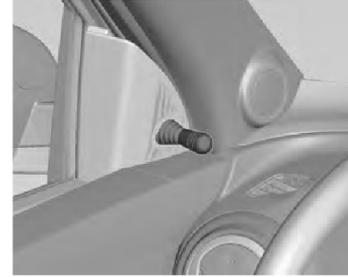
Os espelhos retrovisores externos são ajustáveis com facilidade através das alavancas de ajuste dentro do veículo. Para efetuar o ajuste de posição, mova a alavanca de ajuste instalada no painel da porta.
