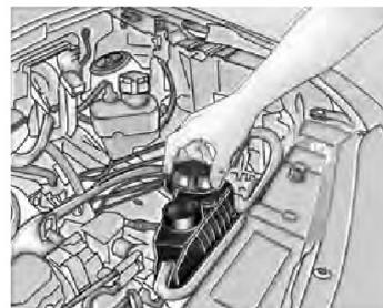
O sistema de arrefecimento do motor é abastecido com um aditivo para radiador de longa duração (etilenglicol), cujas propriedades conferem proteção adequada contra congelamento, ebulição e corrosão.
