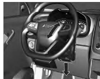
Destrave a alavanca, ajuste a altura do volante e trave-a novamente, e assegure-se de que esteja totalmente travada.
