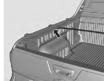
2. Coloque a outra extremidade da travessa traseira no trilho. Alinhe as extremidades da travessa com as etiquetas localizadas no parte superior do trilho.
