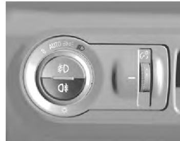
Para veículos equipados com as luzes de neblina traseiras, o botão encontra-se no controle de iluminação externa, do lado externo do painel de instrumentos.
