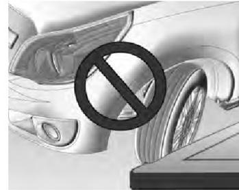
Os impactos contra as guias da calçada podem causar lesões nas rodas e pneus por dentro. Há risco de acidentes a alta velocidade devido a danos externos ocultos nos pneus. Portanto, se for preciso
