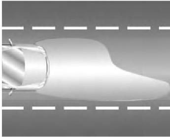
O feixe de luz do farol baixo é projetado de modo a iluminar determinadas regiões com maior intensidade, privilegiando a visualização das placas de sinalização e reduzindo o efeito de ofuscamento para os condutores de veículos no sentido contrário. Essas regiões e intensidade de luz são normatizadas (as resoluções CONTRAN 227/07 e 294/08) e os faróis do seu veículo foram projetados para atender às regras de segurança e fornecer melhor desempenho de iluminação do veículo. Portanto, eventuais
