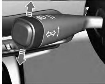
Mova a alavanca totalmente para cima ou para baixo para sinalizar uma alteração de direção.
