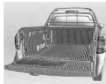
O limite de carga sobre a tampa deve ser seguido, ou a tampa e o chassi podem ser danificados.
