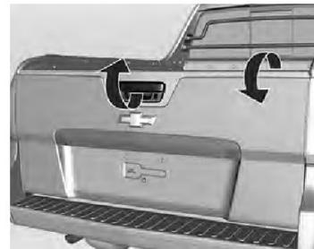
Para abrir, puxe a alavanca central e abaixe a tampa. Para fechar, levante a tampa e pressione as extremidades superiores até ouvir um ruído de travamento.
