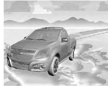
O excesso de água poderá acumular sob os pneus de modo que eles não tenham contato com a pista e isto é muito perigoso. Isto poderá acontecer se houver muita água na pista e se você estiver em alta velocidade. Quando o veículo está aquaplanando, há pouco ou nenhum contato do pneu com a pista.
