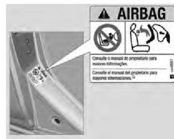
Veículos equipados com "Airbag" podem ser identificados pela palavra "Airbag" na etiqueta adesiva que está na coluna da porta dianteira direita, ela está visível quando a porta do passageiro está aberta.
