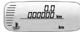
O hodômetro e o hodômetro parcial localizam-se na parte superior do visor do painel de instrumentos. O hodômetro parcial registra a
