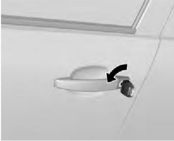
Gire a chave no sentido anti-horário para destravar as portas e o bocal de abastecimento do tanque de combustível.
