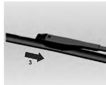
Para instalar a palheta nova, pressione-a (seta 3) até que a aba de travamento esteja travada no furo do braço.
