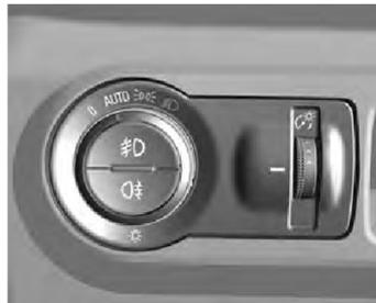
Para veículos com farol de neblina dianteiro e luz de neblina traseira e controle automático de iluminação.
