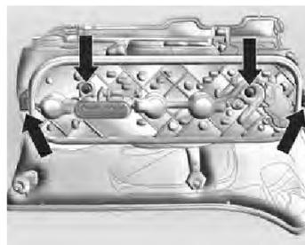
6. Solte os dois parafusos e os dois trincos, conforme mostrado na Fig.
