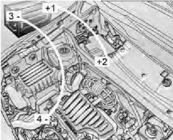
4. Conecte os terminais na sequência indicada:
