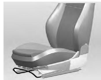
Para ajustar o banco para frente/para trás, puxe a alavanca de regulagem para cima, deslize o banco para a posição desejada e solte a alavanca travando-o.
