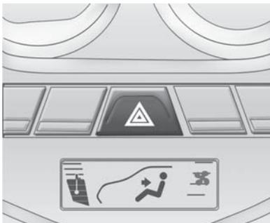
Pressione este botão, localizado no painel central próximo ao sistema de ventilação e ar condicionado, para fazer com que os sinalizadores de direção dianteiros e traseiros pisquem. Isso avisa a outras pessoas que você tem uma emergência, e deve ser usado com o veículo parado. Pressione novamente para desligar o pisca-alerta.
