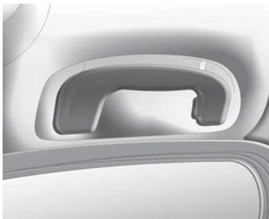
A alça de segurança é fixada no teto, acima da porta do passageiro. Para usá-la, puxe-a para baixo; voltará automaticamente à sua posição original após o uso.
