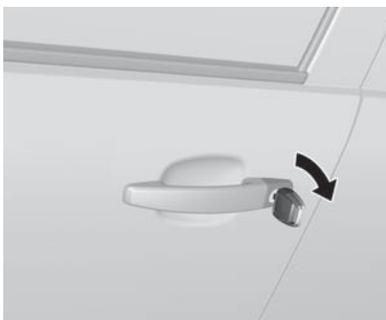
Gire a chave no sentido horário. Será acionado o travamento das portas e da tampa de acesso ao bocal de abastecimento do tanque de combustível. Caso tranque o veículo com a chave, o alarme não será ativado e os vidros não se fecharão.
