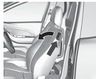
Para rebater o encosto, mova a alavanca de liberação, localizada na parte lateral superior externa do encosto, para cima e, simultaneamente, puxe o encosto de volta para frente.
