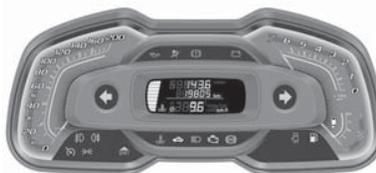
No painel de instrumentos podem ser visualizados: velocímetro, tacômetro, indicador de nível de combustível, luz de advertência da temperatura do líquido de arrefecimento do motor, sinalizadores de direção e respectivas luzes indicadoras.
