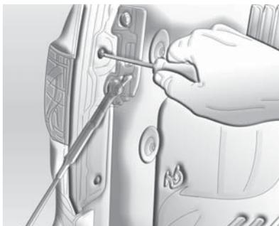
2. Solte os dois parafusos de fixação do conjunto de lâmpadas, conforme mostrado na figura.
