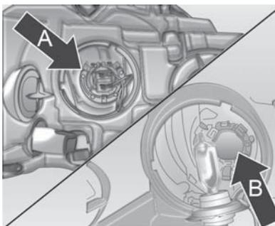
3. Retire a lâmpada com o conector (A), puxando o soquete para trás do farol.
