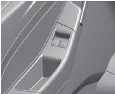
Em veículos equipados com vidros elétricos, o sistema é controlado por interruptores localizados em suas respectivas portas.
