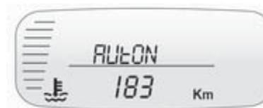
A autonomia exibe a distância aproximada que o veículo pode percorrer sem reabastecer. A estimativa da autonomia baseia-se no consumo médio de combustível do veículo no histórico recente de condução e na quantidade remanescente de combustível no tanque. A autonomia pode ser zerada mantendo o botão **R** pressionado por 2 segundos.
