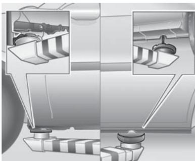
O local dos pontos de apoio de um elevador ou macaco tem de ser aplicado somente nos locais indicados na figura, nas porções dianteira e traseira, nas áreas entre o recesso para instalação do macaco e as caixas das rodas.
