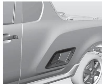
Existem dois degraus laterais que podem tornar mais fácil o acesso à plataforma de carga a partir da lateral do veículo. Além desses degraus laterais, você também pode usar o para-choque traseiro para facilitar o acesso à plataforma de carga. A capacidade de carga sobre os degraus é de 120 kg.
