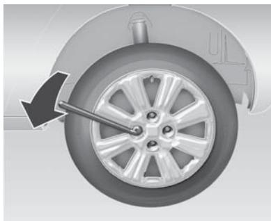
7. Com a chave de roda, afrouxe os parafusos, soltando 1/2 a 1 volta, sem retirá-los.
