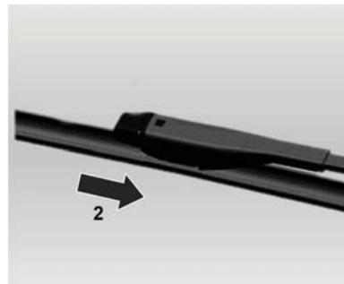
Para instalar a palheta nova, pressione-a (seta 2) até que a aba de travamento esteja travada no furo do braço.
