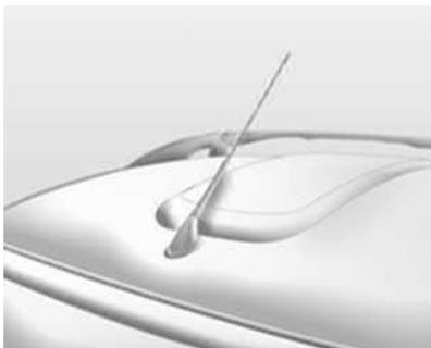
A antena do rádio localiza-se na parte dianteira do teto. Para remover, gire no sentido anti-horário. Para instalar a antena, gire-a no sentido horário.
