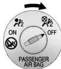
Para desativar o airbag dianteiro do passageiro, insira a chave de ignição no interruptor, pressione-a
