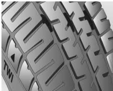
Por razões de segurança, os pneus devem ser trocados quando a profundidade dos desgastes se aproximar de 3 mm.
