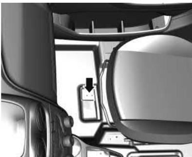
O veículo tem uma localização correta para instalar o extintor de incêndio, abaixo do banco dianteiro do passageiro, sob o tapete do piso. O extintor de incêndio e as presilhas de suporte podem ser adquiridas e instaladas em concessionárias Chevrolet.
