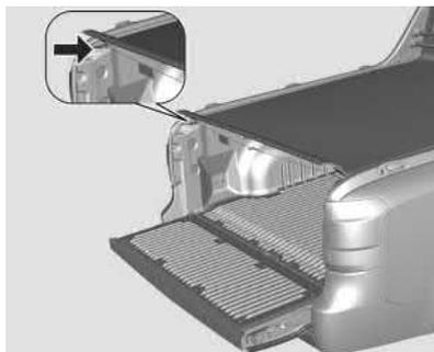
4. Estenda a capota marítima no compartimento de carga encaixando a viga traseira no suporte de trilho lateral sem travá-lo.
