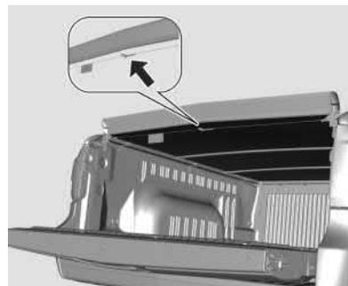
Para abrir a capota marítima, abaixe a tampa do compartimento de carga e empurre a alavanca de liberação para baixo.
