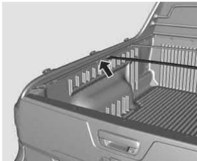
2. Coloque a outra extremidade da travessa traseira no trilho. Alinhe as extremidades da travessa com as etiquetas localizadas no parte superior do trilho.
