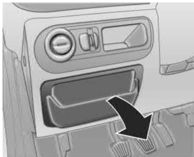
A caixa de fusíveis e a central de relés ficam localizadas abaixo do painel de instrumentos. Para acessá-las, puxe o compartimento como se vê na figura.
