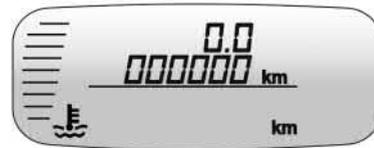
O hodômetro e o hodômetro parcial localizam-se na parte superior do visor do painel de instrumentos.
