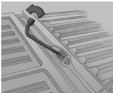
1. Coloque a parte chanfrada da chave de roda (extremidade com ranhuras) no eixo do sistema de elevação do pneu reserva.
