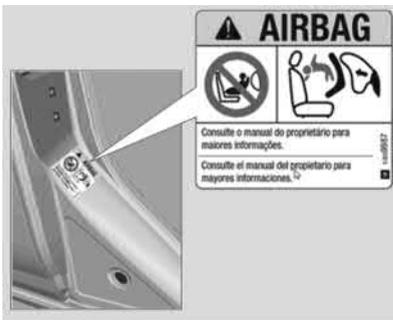
Veículos equipados com "Airbag" podem ser identificados pela palavra "Airbag" na etiqueta adesiva que está na coluna da porta dianteira direita, ela está visível quando a porta do passageiro está aberta.
