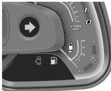
Quando a ignição está ligada, o indicador de nível de combustível mostra quanto de combustível permanece no tanque. Uma seta no indicador de nível de combustível indica em qual lado do veículo encontra-se a portinhola de abastecimento. O ponteiro indica vazio antes que o veículo esteja sem combustível, para mostrar que o tanque de combustível do veículo deverá ser abastecido imediatamente.
