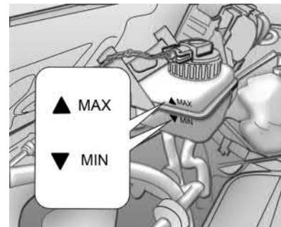
Verifique o fluido de freio mensalmente e quando a lâmpada indicadora de nível no painel de instrumentos (⚠) acender. O nível do fluido deve ficar entre as marcas MAX e MIN estampadas no reservatório.
