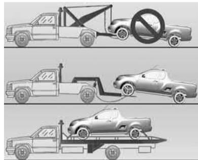
Em situações de emergência que exijam o reboque do veículo, procure, de preferência, empresas especializadas com carros-guincho ou a assistência oficial da rodovia, usando veículos de reboque que tenham apoio para as rodas ou plataforma para receber o automóvel.
