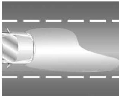
O fecho de luz do farol baixo é projetado de modo a iluminar determinadas regiões com maior intensidade, privilegiando a visualização das placas de sinalização e reduzindo o efeito de ofuscamento para os condutores de veículos no sentido contrário. Essas regiões e intensidade de luz são normatizadas (as resoluções
