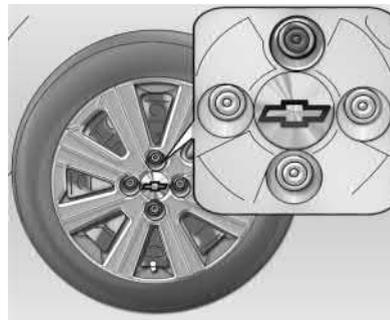
16. Instale os parafusos e aperte-os parcialmente.
