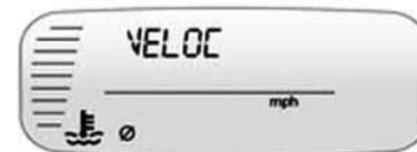
A tela de velocidade média do veículo exibe a velocidade média do veículo em milhas por hora (mph) ou quilômetros por hora (km/h).
