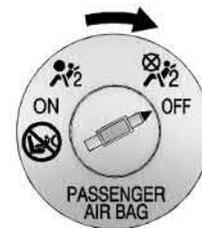
Para desativar o airbag dianteiro do passageiro, insira a chave de ignição no interruptor, pressione-a para dentro e mova o interruptor até a posição OFF (desligado). O airbag dianteiro do passageiro será desativado e não inflará em caso de colisão.
