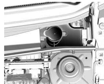
O reservatório de líquido do sistema de lavagem do para-brisa fica situado na lateral esquerda do compartimento do motor. Para uma limpeza eficiente, recomenda-se acrescentar à água um aditivo de limpeza.
