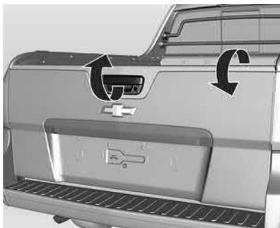
Para abrir, puxe a alavanca central e abaixe a tampa. Para fechar, levante a tampa e pressione as extremidades superiores até ouvir um ruído de travamento.
