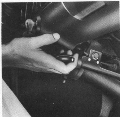
Puxando-se a alavanca, aplica-se o freio de estacionamento nas duas rodas traseiras.
