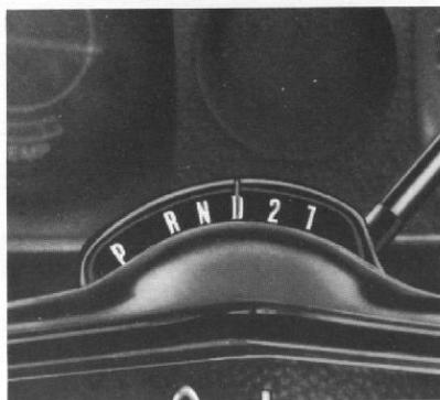
A caixa-de-mudanças automática é equipada com um dispositivo de segurança elétrico, que permite dar a partida ao motor somente quando a alavanca seletora se acha em posição "P" ou "N". Para tração de pouca velocidade e em regiões montanhosas ou na cidade, coloque a alavanca na posição "2" ou "1" para obter a redução desejada. Em qualquer destes dois regimes de trabalho, o veículo nunca funcionará em marcha direta (terceira).
