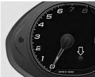
Pressione o botão de controle localizado na lente do painel de instrumentos para alternar entre o hodômetro e o hodômetro parcial.
