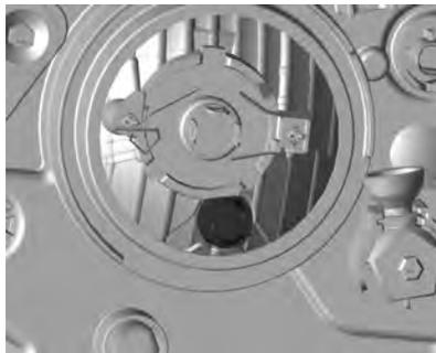
2. Remova a lâmpada do alojamento do refletor puxando-a e troque por uma nova lâmpada.
