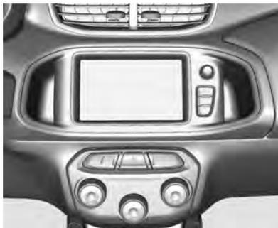
Para veículos com o sistema MyLink, existem dois porta-objetos no painel de instrumentos. Eles podem ser utilizados para guardar pequenos objetos.
