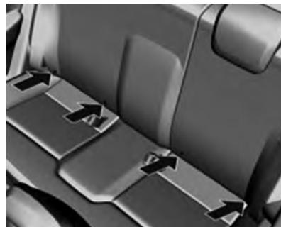
Para instalar um dispositivo de retenção para crianças equipado com pontos de ancoragem inferiores ISOFIX, siga as instruções fornecidas com o dispositivo de retenção para crianças.
