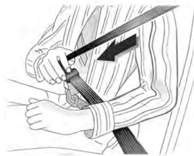
Retire o cinto da bobina, conduza-o pelo corpo, sem torcer, e empurre a lingueta de acoplamento na fivela até que encaixe. Tensione o cinto subabdominal regularmente ao dirigir puxando o cinto diagonal sobre o ombro.
