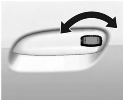
Para veículo equipado com trava elétrica das portas, gire a chave no sentido anti-horário. Todas as portas serão travadas. Para veículo sem trava elétrica das portas, gire a chave da porta do motorista no sentido anti-horário ou da porta do passageiro no sentido horário para travar essa porta.
