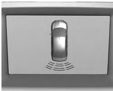
3. Apenas com o RPA, o sistema de conforto e conveniência pode ter um visor do auxiliar de estacionamento com barras que exibem a “distância para o objeto” e as informações de localização de objeto para o sistema do auxiliar de estacionamento. À medida que o objeto se aproxima, mais barras acendem e mudam de cor, passando por amarelo, âmbar e vermelho. Um obstáculo também é indicado por bipes audíveis. O intervalo entre bipes torna-se mais curto à medida que o veículo se
