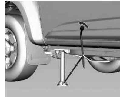
Se o pneu furado estiver na parte dianteira do veículo, posicione o macaco na parte traseira do pneu
