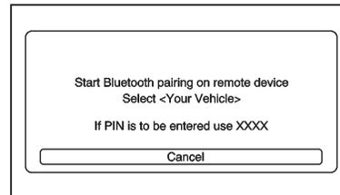
4. Quando um dispositivo é detectado, a tela muda para o modo de emparelhamento. Se o dispositivo Bluetooth não se conectar ao rádio dentro de 60 segundos, a tela expira, volta para a Lista de dispositivos Bluetooth e cancela o processo de detecção.
