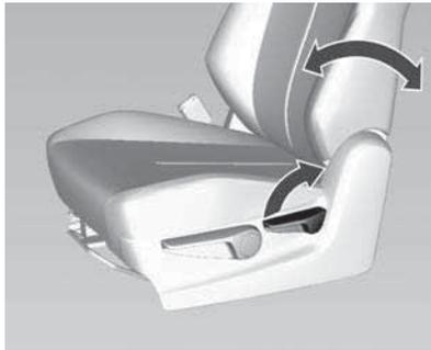
Puxe a alavanca, ajuste a inclinação e solte a alavanca. O banco deverá travar na posição.
