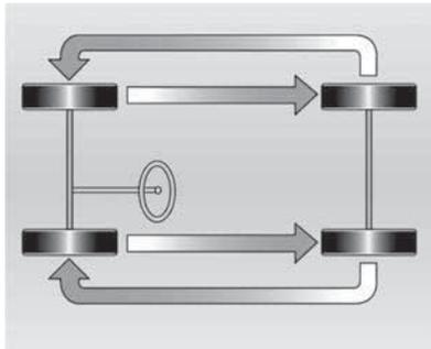
Forças diferente nos pneus dianteiros e traseiros fazem com que se desgastem de forma diferente. Esse desgaste pode causar a perda de estabilidade do veículo.
