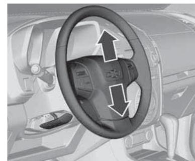
Destrave a alavanca para ajustar o volante, depois trave-a novamente e assegure-se de que esteja totalmente travada. Regule o volante apenas quando o veículo estiver parado e a coluna de direção destravada.
