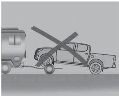
**Nota:** Se um veículo 4x2 for rebocado com as rodas traseiras no solo, a transmissão poderá ser danificada. Os reparos não serão cobertos pela garantia do veículo. Nunca reboque o veículo com as rodas traseiras no solo.
