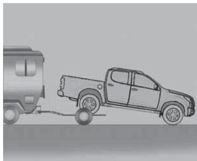
Use o procedimento abaixo para rebocar pela traseira um veículo com tração nas rodas dianteiras com o método carrinho de mão:
