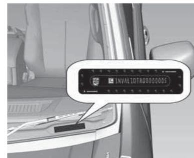
O Número de identificação do veículo (VIN) está embutido no painel de instrumentos, visível pelo para-brisa.
