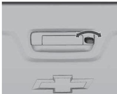
Gire a chave para destravar a tampa do compartimento de carga e puxe a maçaneta para cima.
