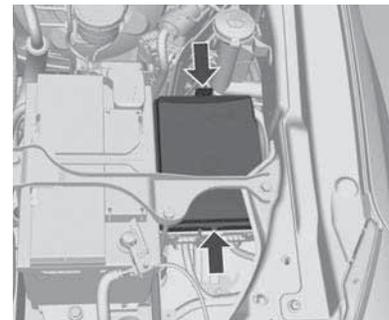
A caixa de fusíveis está na parte dianteira esquerda do compartimento do motor.
