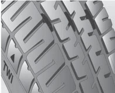
Os pneus devem ser substituídos quando a profundidade da banda de rodagem estiver desgastada até próximo de 3 mm. A figura mostra onde pode ser encontrada a profundidade da banda de rodagem.
