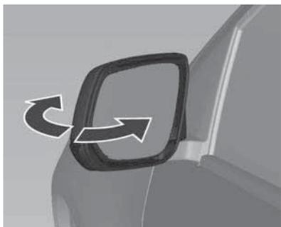
Para segurança do pedestre, os espelhos externos sairão da posição de montagem normal caso alguém colida com eles com força suficiente para isso. Reposicione o espelho ao aplicar uma leve pressão na caixa do espelho.
