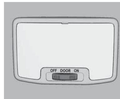
Ao entrar ou sair do veículo, as luzes de cortesia acendem automaticamente e, após um período curto, apagam novamente. Elas acendem por um curto período mesmo se a chave for removida da ignição.
