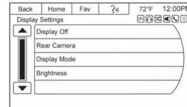
**Display Mode (Modo de exibição):** Pressione Display Mode (Modo de exibição) para alterar o segundo plano da tela. Essa configuração controla cores do mapa.
