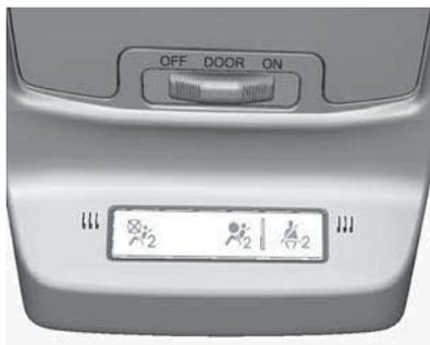
Quando o veículo é ligado, o indicador de status do airbag do passageiro LIGADO ou DESLIGADO e o símbolo para ligado e para desligado acenderá durante vários segundos enquanto é executada a verificação do sistema. Então, após vários segundos, o indicador de status LIGADO ou DESLIGADO ou o símbolo ligado ou desligado, acenderá para exibir o status do airbag do passageiro dianteiro externo.
