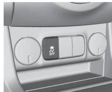
O controle de tração pode ser desligado quando a derrapagem da roda de tração é necessária; pressione o botão
