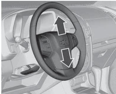
Destrave a alavanca, ajuste o volante e trave-a novamente, e assegure-se de que esteja totalmente travada.
