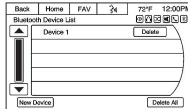
2. Pressione o botão da tela New Device (Novo dispositivo) para iniciar o processo de adicionar um novo dispositivo Bluetooth ao sistema de rádio.
