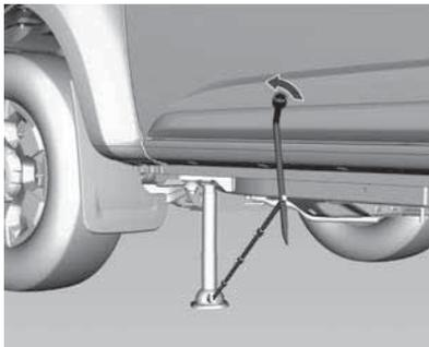
Se o pneu furado estiver na parte dianteira do veículo, posicione o macaco na parte traseira do pneu dianteiro na área fora da estrutura.
