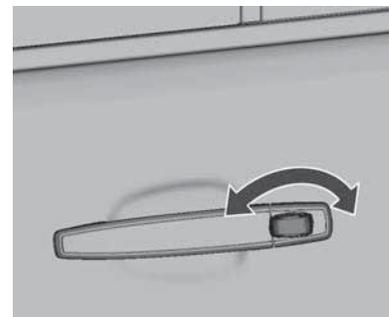
Destrave manualmente a porta do motorista girando a chave no sentido anti-horário. Ligue a ignição para desativar o sistema de alarme antifurto e pressione o botão
