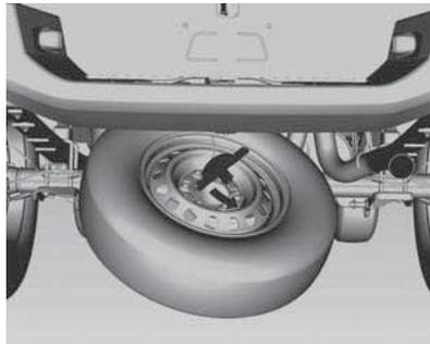
4. Incline o retedor quando o pneu estiver abaixado e deslize-o para cima pelo cabo de modo que possa ser puxado através da abertura da roda.
