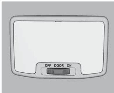
Ao entrar ou sair do veículo, as luzes de cortesia acendem automaticamente e, após um curto período, apagam novamente. Elas acendem por um curto período mesmo se a chave for removida da ignição.
