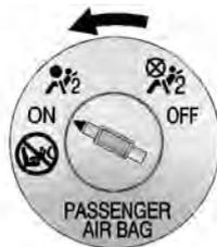
Para reativar o airbag dianteiro do passageiro, insira a chave de ignição no interruptor, pressione-a para dentro e mova o interruptor até a posição ON (ligado).
