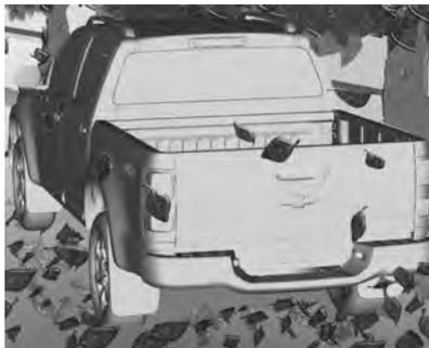
Antes de estacionar o veículo, certifique-se de que o terreno não possua qualquer material inflamável como grama, arbustos, gotas de combustível etc. O escapamento é quente e poderá causar um incêndio.
