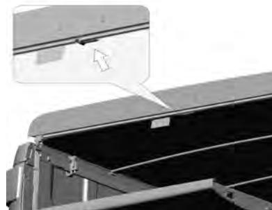
Para abrir a capota marítima, abaixe a tampa do compartimento de carga e empurre a alavanca de liberação para baixo.
