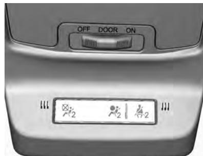
Quando o veículo é ligado, o indicador de status do airbag do passageiro LIGADO ou DESLIGADO e o símbolo para ligado e para desligado acenderá durante vários segundos enquanto é executada a verificação do sistema. Então, após vários segundos, o indicador de status LIGADO ou DESLIGADO ou o símbolo ligado ou desligado, acenderá para exibir o status do airbag do passageiro dianteiro externo.
