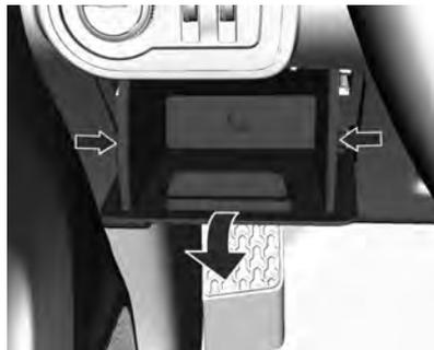
2. Pressione o compartimento de armazenamento nas laterais juntamente.
