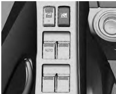
Pressione o interruptor
