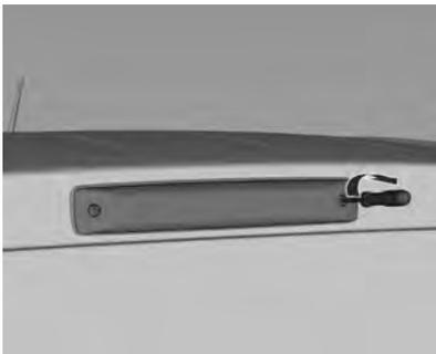
1. Remova os dois parafusos e o conjunto da lâmpada do veículo.
