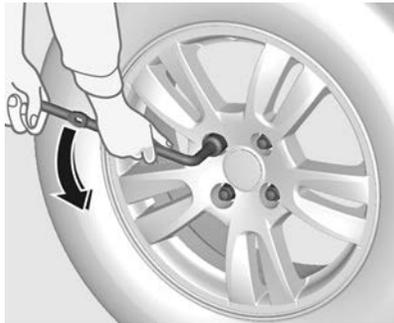
7. Com a chave de roda, afrouxe os parafusos de 1/2 a uma volta, sem removê-los.
