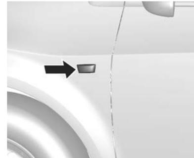
1. Empurre a lâmpada para a frente (lado do motorista) ou para trás (lado do passageiro). A seguir, gire a lâmpada para baixo e remova-a do compartimento.
