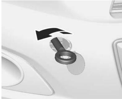
Instale o gancho de emergência, girando-o em sentido anti-horário, usando uma chave de roda até que ele fique em posição horizontal. Aperte firmemente.
