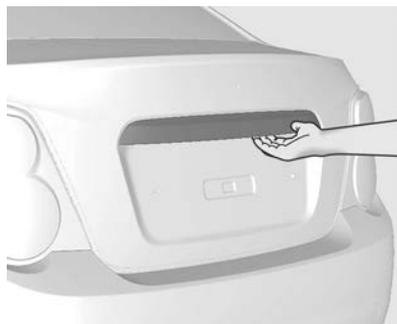
Para abrir a tampa do porta-malas, pressione o painel sensível ao toque quando a tampa estiver destravada.
