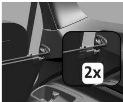
Haste de conexão e ganchos na parte de cima dos dois lados.
