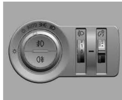
O controle das luzes externas está à esquerda da coluna da direção no painel de instrumentos.
