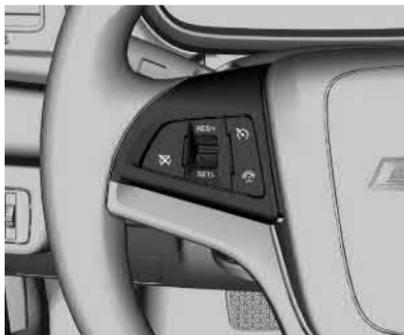
O Controle de velocidade de cruzeiro e o limitador de velocidade podem ser operados pelos controles do volante.
