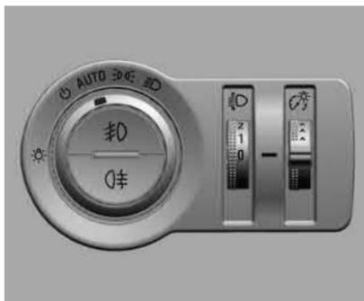
Quando a função de iluminação automática **AUTO** for ligada, o sistema liga automaticamente os faróis dianteiros e as lanternas traseiras, dependendo das condições de iluminação externa.
