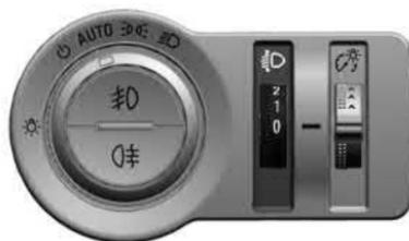
Para adaptar o alcance do farol à carga do veículo e evitar ofuscamento, gire o botão para a posição necessária.
