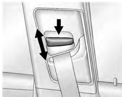
Para mover o regulador de altura do cinto diagonal, puxe o botão de destravamento para baixo e mova o regulador de altura para a posição desejada. É possível mover o regulador para cima pressionando a guia do cinto diagonal para cima.
