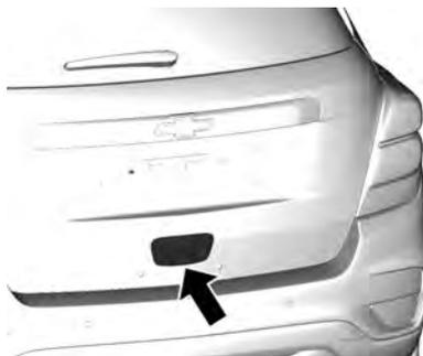
Para abrir a tampa do porta-malas, pressione
