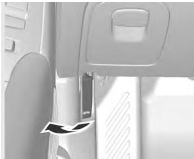
1. Puxe a alavanca de liberação do capô dentro do veículo. Ela fica localizada no lado esquerdo inferior do painel de instrumentos.
