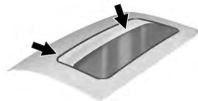
A sujeira e detritos podem se acumular na vedação do teto solar ou no trilho. Isto poderá causar um problema no funcionamento ou ruído no teto solar. Isto também poderá obstruir o sistema de drenagem de água. Abra periodicamente o teto solar e remova qualquer obstáculo ou detrito solto. Limpe a vedação do teto solar e a área de vedação usando um pano limpo, sabão suave e água. Não remova a graxa do teto solar.
