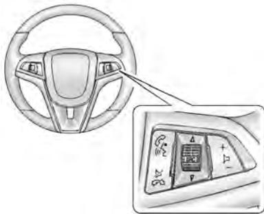
: Pressione para interagir com Bluetooth ou OnStar, se equipado. Consulte *Bluetooth (Visão geral)* ⇨ 133 ou *Bluetooth (Controles do sistema de conforto e conveniência no rádio com tela de toque)* ⇨ 134.
