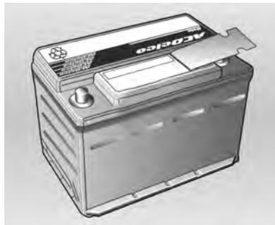
A bateria do veículo dispensa manutenção periódica. Se o veículo não for usado durante 30 dias ou mais, desconecte o cabo do pólo negativo da bateria para não descarregá-la.
