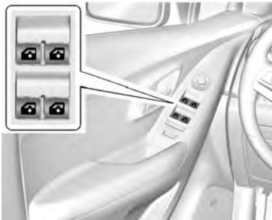
A porta do motorista também possui interruptores que controlam o vidro do passageiro e os vidros traseiros. Os interruptores funcionam quando o veículo está em ON/RUN ou ACC/ACCESSORY.
