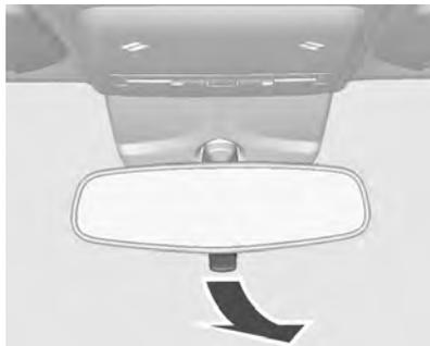
Para reduzir o ofuscamento, puxe a alavanca existente na parte inferior da moldura do espelho.
