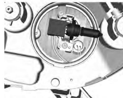
4. Desconecte o conector da fiação elétrica da lâmpada.
