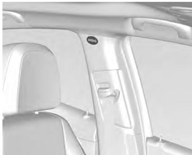
O sistema de airbag "cortina" consiste em um airbag na estrutura do teto em cada lado. Ele pode ser identificado pela palavra AIRBAG nas colunas do teto.
