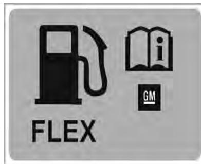
A etiqueta adesiva acima contém uma indicação do tipo de combustível e se localiza na portinhola do tanque de combustível do veículo.
