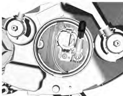
5. Instale a nova lâmpada no conjunto do farol dianteiro girando-a no sentido horário.
