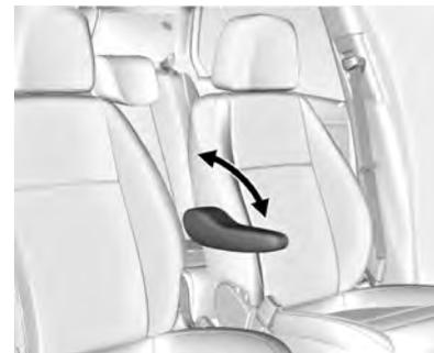
Pode existir um apoio de braço do lado interno do banco do motorista. Para levantar ou abaixar o apoio de braço, puxe-o para cima ou empurre-o para baixo.
