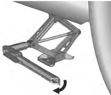
4. Gire a alavanca do macaco no sentido horário para levantar o veículo do chão o suficiente para o pneu reserva de uso temporário encaixar sob o veículo.
