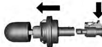
2. Desengate o soquete da lâmpada do conector da tomada pressionando o ressalto de retenção.
