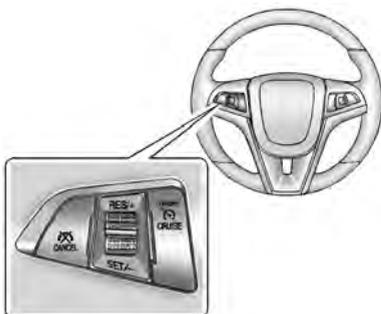
**CRUISE (On/Off)(Liga/Desliga)** : Aperte para ligar e desligar o controle de velocidade de cruzeiro.
