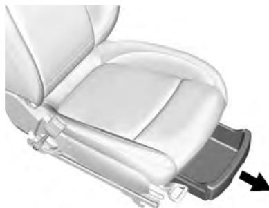
Se equipado, há um compartimento de carga sob o assento do passageiro. Levante a extremidade da bandeja para cima e puxe para frente para abrir. Empurre no sentido do assento para fechar.
