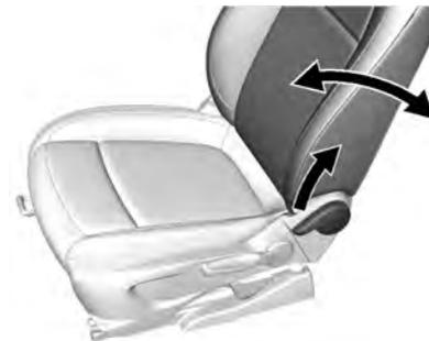
Puxe a alavanca, ajuste a inclinação e solte a alavanca. Deixe o banco engatar de forma audível.
