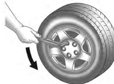
Instale a chave de roda assegurando-se de que ela esteja assentada de forma segura e afrouxe cada porca da roda meia volta.
