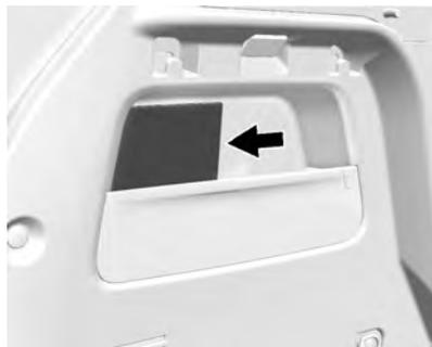
A caixa de fusíveis do compartimento de carga fica atrás de uma tampa no lado esquerdo do compartimento traseiro. Para acessar os fusíveis, remova a tampa.
