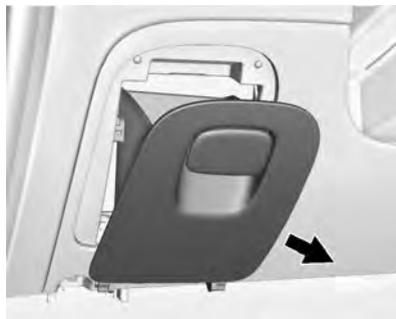
O caixa de fusíveis do painel de instrumentos fica na parte inferior do painel de instrumentos do lado do motorista. Para acessar os fusíveis, remova o compartimento de carga. Para remover o porta-objetos, pressione-o de ambos os lados e puxe-o para fora.
