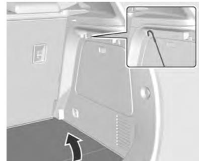
Dobre o assoalho de carga e posicione o gancho no gancho do compartimento localizado no acabamento lateral como indicado.
