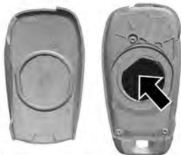
2. Remova a bateria com uma ferramenta pequena empurrando-a em direção à parte superior do transmissor.
