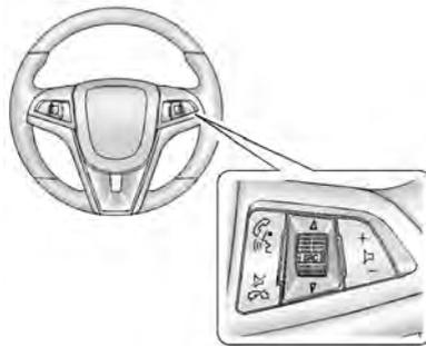
: Pressione para interagir com Bluetooth ou OnStar, se equipado. Consulte *Bluetooth (Visão geral)* ⇨ 131 ou *Bluetooth (Controles do sistema de conforto e conveniência no rádio com tela de toque)* ⇨ 132.
