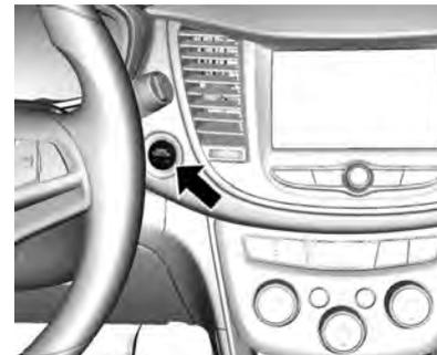
**Modo de energia acessório :** pressione o botão **Engine Start/ /Stop (Partida/parada do motor)** uma vez, sem pressionar o pedal do freio. O LED amarelo no botão acende. A trava do volante é liberada e algumas funções elétricas estão funcionando, a ignição está desligada.
