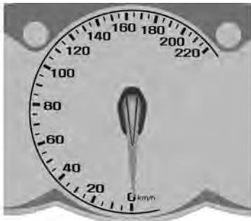
O velocímetro mostra a velocidade do veículo em quilômetros por hora (km/h) ou milhas por hora (mph).
