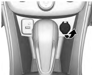
As tomadas elétricas podem ser usadas para conectar equipamento elétrico, como telefone celular ou reproduutor de MP3.
