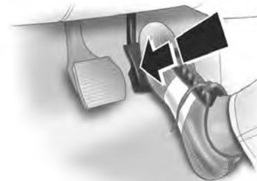
Para obter aceleração mais rápida, pressione o pedal do acelerador até o final e segure-o. A transmissão muda para uma marcha mais lenta, dependendo da velocidade do motor.
