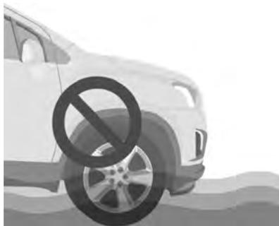
Áreas inundadas devem ser evitadas sempre, mesmo em vias urbanas pavimentadas. Além de não ser possível avaliar com precisão o estado da pista à frente, o veículo pode vir a se danificar seriamente, pois não foi projetado para essa utilização.
