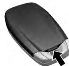
1. Separe as duas metades do transmissor inserindo uma ferramenta chata na fenda do transmissor.
