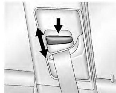
Para mover o regulador de altura do cinto diagonal, puxe o botão de destravamento para baixo e mova o regulador de altura para a posição desejada. É possível mover o regulador para cima pressionando a guia do cinto diagonal para cima.
