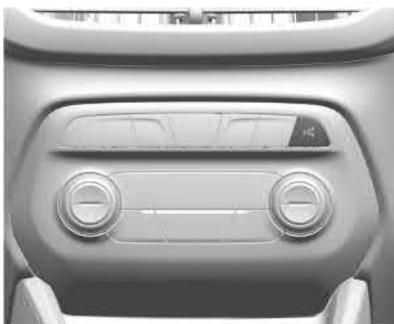
Pressione **P** para ativar o sistema para procurar uma vaga de estacionamento grande o suficiente e dentro de 1,5 m (5 pés) do veículo. A velocidade do veículo deve estar abaixo de 30 km / h (18 mph).
