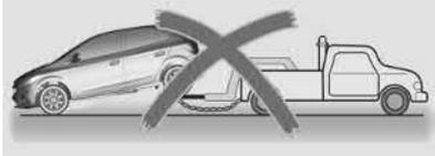
A rebocagem com duas rodas fora do solo não é adequada para este veículo.
