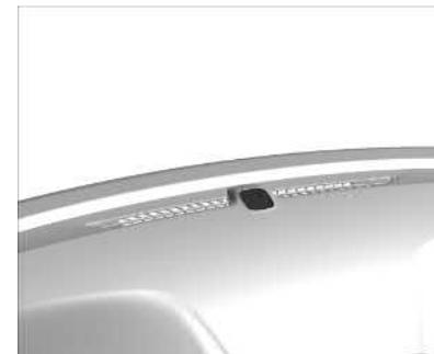
Há um sensor de iluminação na parte superior do painel de instrumentos. Não cubra o sensor.
