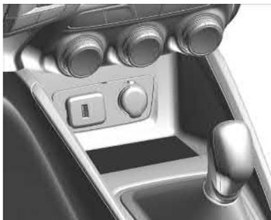
A ignição deve estar ligada em Ligado / operação, ACC / ACESSÓRIO ou a energia retida para acessórios (RAP) deve estar ativada. A função de carregamento sem fio pode não indicar corretamente o carregamento quando o veículo estiver em RAP. Consulte *Energia retida para acessórios (RAP)* ⇨ 131.
