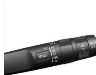
Pressione MENU para alternar entre os menus principais ou voltar de um submenu para o menu de nível superior seguinte.
