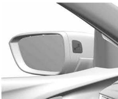
Quando a velocidade do veículo está acima de 10 km / h, o sistema de alerta de ponto cego lateral é ativado. Quando a velocidade do veículo for superior a 140 km / h, o sistema será desligado e a luz indicadora dos espelhos externos esquerdo e direito ficará esmaecida. Nesse momento, se a velocidade do veículo for reduzida, a luz indicadora do espelho apagará. Se for detectado um veículo no ponto cego nesse momento, a luz indicadora do espelho retrovisor correspondente acenderá.
