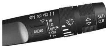
Com a ignição ligada ou em ACC / ACCESSORY, mova a alavanca do limpador do para-brisa para selecionar a velocidade do limpador.
