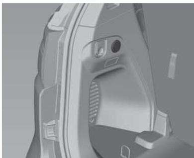
Uma tomada elétrica de 12 V está localizada no lado esquerdo do compartimento de carga.
