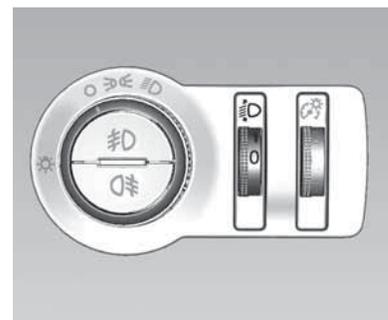
Para adaptar o alcance do farol à carga do veículo e evitar ofuscamento: gire o botão para a posição necessária.
