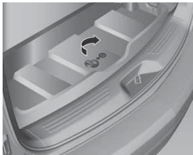
3. Girar a tampa de acesso ao pneu reserva no sentido anti-horário para remover. Levantar a aba do tapete para acessar o encaixe para o guincho.
