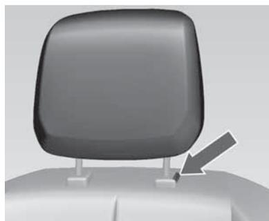
Para mover para baixo, pressione o botão e empurre o apoio de cabeça para baixo. Para ajustar a altura, puxe o apoio de cabeça para cima. Consulte *Apoios de cabeça* ⇨ 42.
