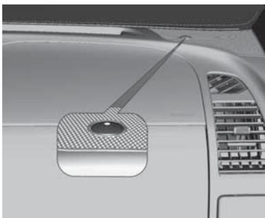
O LED de Status está integrado ao sensor na parte superior do painel de instrumentos.
