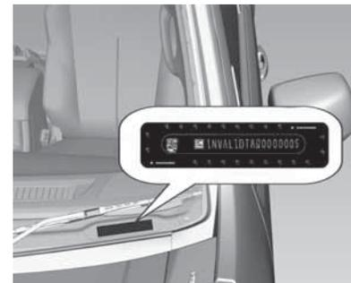
O Número de identificação do veículo (VIN) pode estar embutido no painel de instrumentos, visível pelo para-brisa.
