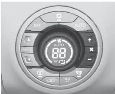
Pressione o botão + ou o botão - para aumentar ou diminuir a velocidade do ventilador. A velocidade selecionada do ventilador é indicada pelas barras no visor.
