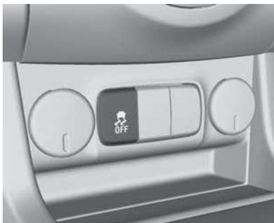
O controle de tração pode ser desligado quando a derrapagem da roda de tração é necessária; pressione o botão
