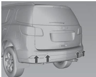
O auxiliar de estacionamento facilita o estacionamento medindo a distância entre o veículo e os obstáculos traseiros e fornecendo sinais sonoros. É o motorista, no entanto, que tem total responsabilidade pela manobra de estacionamento.
