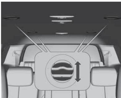
O condicionamento adicional do ar é fornecido ao compartimento traseiro de passageiros por meio dos difusores de ar superiores.
