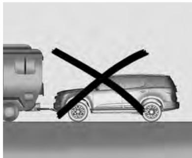
Se o veículo for rebocado com as quatro rodas no solo, os componentes da linha de transmissão poderão ser danificados. Os reparos não serão cobertos pela garantia do veículo. Não reboque o veículo com todas as quatro rodas no solo.
