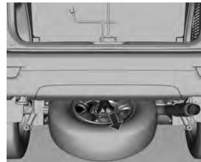
8. Incline o retentor quando o pneu estiver abaixado além do primeiro cabo e deslize-o para
