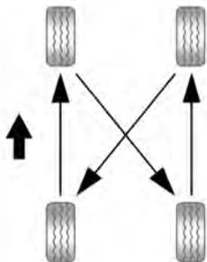
Forças diferentes nos pneus dianteiros e traseiros fazem com que eles se desgastem de forma diferente, dependendo de vários fatores, como a superfície da pista, a forma de condução, o
