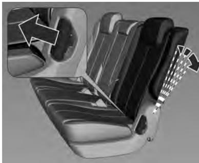
Puxe a alavanca, ajuste a inclinação, solte a alavanca e deixe o encosto encaixar.
