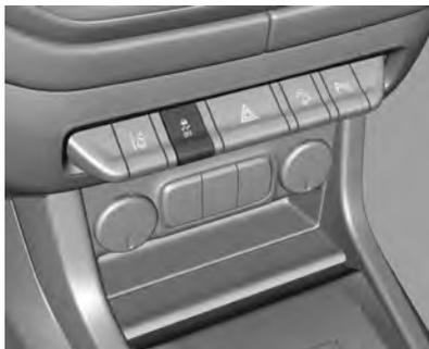
O controle de tração pode ser desligado quando a derrapagem da roda de tração é necessária; pressione o botão
