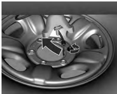
9. Remova o segundo cabo retirando o conjunto da porca na roda usando a chave de roda. Remova o cabo de segurança.
