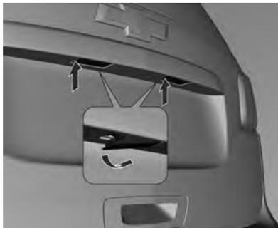
1. Insira a chave de fenda no lado esquerdo do compartimento da lâmpada, pressione para o lado e solte a mola.
