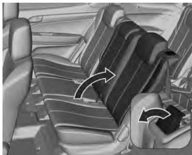
Puxe a alavanca próxima ao apoio de cabeça para cima e levante o encosto do banco até que ele encaixe.
