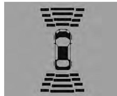
O painel de instrumentos pode ter um visor do auxiliar de estacionamento com barras que exibem a "distância para o objeto" e as informações de localização de objeto para o sistema do auxiliar de estacionamento. À medida que o objeto se aproxima, mais barras se acendem.
