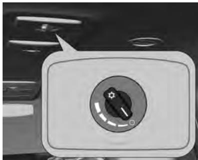
O ventilador do ar condicionado traseiro auxilia o fluxo do ar para o compartimento traseiro de passageiros por meio dos difusores de ar traseiros.
