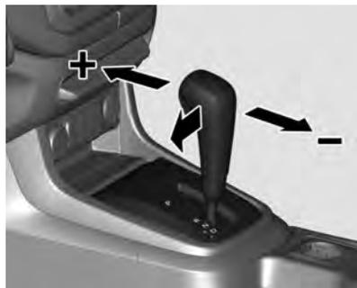
Mova a alavanca seletora para fora da posição **D** para a esquerda e, a seguir, para a frente ou para trás.
