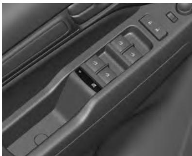
Pressione o interruptor
