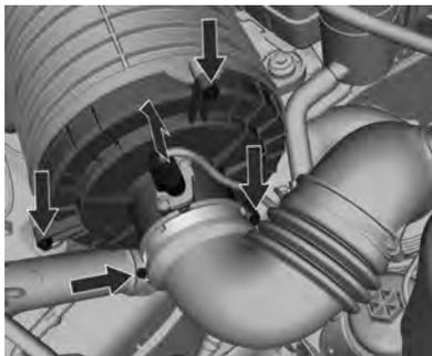
Para substituir o filtro de ar do motor, solte a braçadeira e remova o duto de saída do limpador de ar. Desconecte o sensor de ar, desatarraxe os 3 parafusos e remova o alojamento do filtro.
