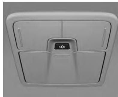
Ao entrar ou sair do veículo, as luzes de cortesia acendem automaticamente se o botão for pressionado e, após um curto período, apagam novamente. Elas acendem por um curto período mesmo se a chave for removida da ignição.
