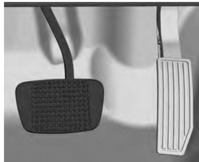
Ao pressionar o pedal do freio, as luzes correspondentes acendem nas lanternas externas e na luz de freio central.
