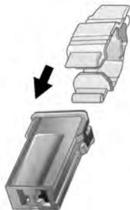
Coloque o extrator de fusível sobre os vários tipos de fusíveis pela parte superior ou pela lateral e remova o fusível.
