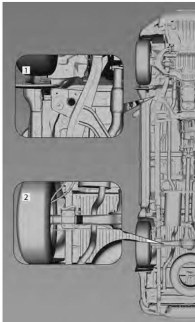
A figura mostra onde deverão ser instalados os suportes para um guincho ou macaco.
