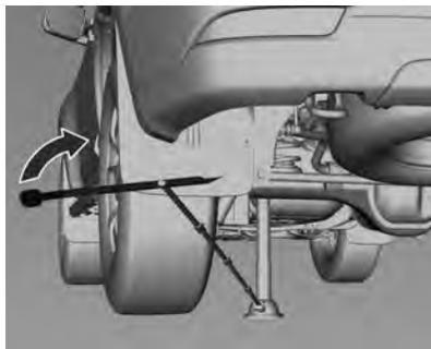
Se o pneu furado estiver na parte traseira, posicione o macaco sob o eixo traseiro o mais próximo possível do amortecedor.
