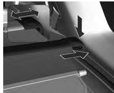
Insira o lado direito da tampa do compartimento de carga no orifício e, a seguir, o lado esquerdo da tampa no compartimento para engatar.
