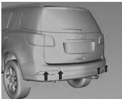
O auxiliar de estacionamento facilita o estacionamento medindo a distância entre o veículo e os obstáculos e fornecendo sinais sonoros. É o motorista, no entanto, que tem total responsabilidade pela manobra de estacionamento.
