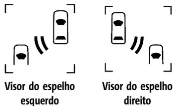
Quando o veículo é ligado, o visor do SBZA dos espelhos laterais acenderão brevemente para indicar que o sistema está funcionando. Quando o veículo estiver em uma marcha superior, o visor do espelho lateral direito ou do esquerdo acenderá ao detectar um veículo em movimento naquele ponto cego. Se a seta for ativada na mesma direção de um veículo detectado, esse visor piscará para fornecer aviso extra indicando a não mudança de pista.
