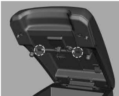
Use o percurso mostrado acima para evitar esmagar o cabo auxiliar quando o apoio de braço do console estiver abaixado, ao usar o cabo.
