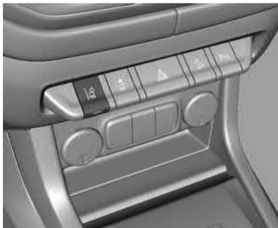
Se equipado, o LDW pode ajudar a evitar colisões resultantes de saídas de pista não intencionais. Ele pode fornecer um alerta se o veículo estiver cruzando a pista sem usar as luzes indicadoras dos sinalizadores de direção. O LDW usa a câmera para detectar as marcações da pista em velocidades de 60 km / h ou maiores.
