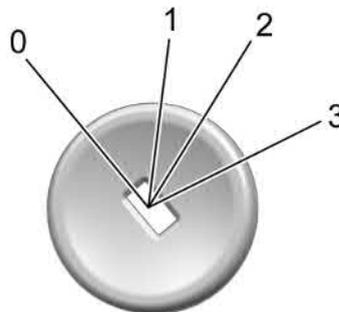
0. Desligamento do motor / TRAVAR / DESLIGAR
