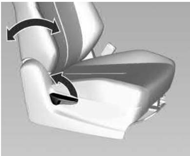
Puxe a alavanca, ajuste a inclinação e solte a alavanca. O banco deverá travar na posição. Tente mover o banco para frente e para trás para certificar-se de que o banco esteja travado na posição.
