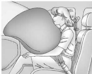
O airbag do passageiro dianteiro externo está no painel de instrumentos do lado do passageiro.
