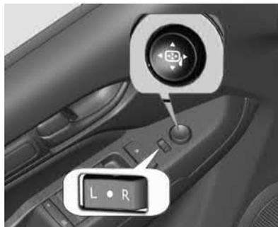
Mova o seletor para L (esquerda) ou R (direita) para escolher o espelho do lado do motorista ou do passageiro. Mova o espelho para a direção desejada pressionando o interruptor de quatro posições.
