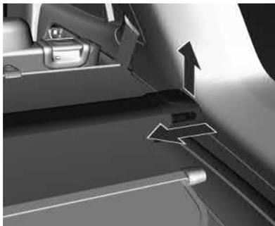
Abra a tampa do compartimento de carga. Puxe a barra em um dos lados da tampa em direção ao centro do veículo, levante-a e remova a tampa das guias laterais.
