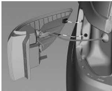
2. Remova o conjunto da lanterna puxando para fora da carroceria. Remova o conector elétrico.
