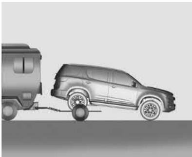
Use o procedimento abaixo para rebocar pela traseira um veículo com tração nas quatro rodas com o método carrinho de mão:
