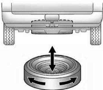
7. Certifique-se de que o pneu esteja armazenado seguramente. Empurre, puxe e tente girar o pneu. Se o pneu se mover, use a chave de roda para apertar o cabo ou a corrente.
