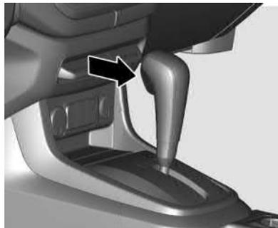
**P** : Posição estacionamento, as rodas estão travadas, só engate quando o veículo estiver parado e o freio de estacionamento acionado
