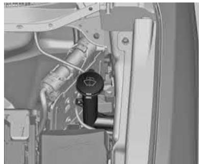
Encha com água limpa misturada com uma quantidade adequada de aditivo para limpeza de para-brisa.
