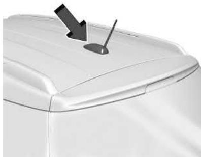
Para remover a antena do teto, gire-a no sentido anti-horário. Para instalar a antena do teto, gire-a no sentido horário.
