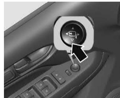
Pressione seletor (interruptor L / R) para a posição central, depois pressione o interruptor de quatro posições para dobrar o espelho eletricamente. Pressione novamente para desdobrar.
