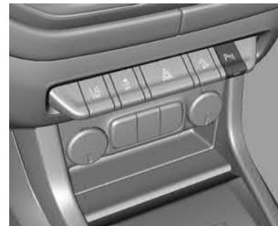
O botão **P** do painel de instrumentos é usado para ligar ou desligar o Assistente de estacionamento dianteiro e traseiro. O indicador LED próximo ao botão acende quando as funções estiverem ligadas e apaga quando as funções estiverem desligadas.
