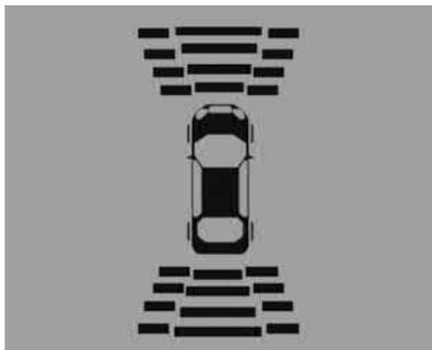
O painel de instrumentos pode ter um visor do assistente de estacionamento com barras que exibem a "distância para o objeto" e as informações de localização de objeto para
