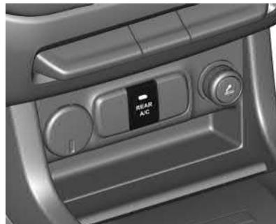
O sistema de ar-condicionado traseiro é operado com o botão **REAR A / C**.
