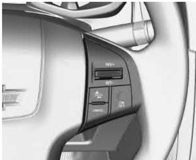
O Controle de velocidade de cruzeiro e o Alerta de colisão frontal podem ser usados pelos controles no volante.
