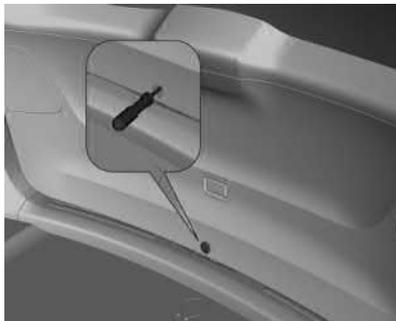
Para abrir a tampa do porta-malas em caso de interrupção do fornecimento de energia, remova a cobertura do acabamento interno da área da trava central. Empurre uma ferramenta adequada para dentro o máximo possível e gire-a no sentido horário para abrir a tampa do porta-malas.
