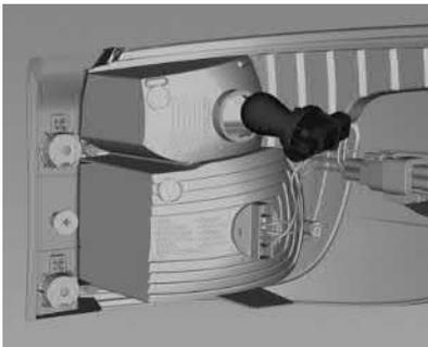
5. Remova o suporte da lâmpada. Pressione ligeiramente a lâmpada no soquete, gire no sentido anti-horário e remova a lâmpada.
