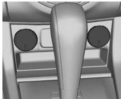
Existem tomadas elétricas de 12V localizadas no painel dianteiro.
