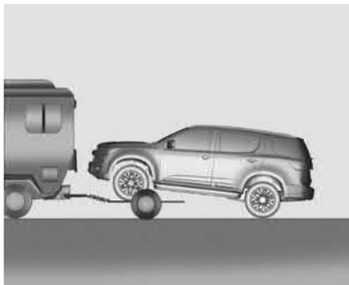
Use o procedimento abaixo para rebocar pela dianteira um veículo com tração nas quatro rodas com o método carrinho de mão:
