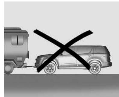
Se o veículo for rebocado com as quatro rodas no solo, os componentes da linha de transmissão poderão ser danificados. Os
