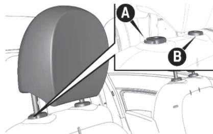
Para retirar o encosto de cabeça, acionar o botão da esquerda **A** e da direita **B** e levantar o encosto de cabeça até liberá-lo da terceira trava. Soltar os botões e puxar para cima até a total retirada do apoio de sua haste.
