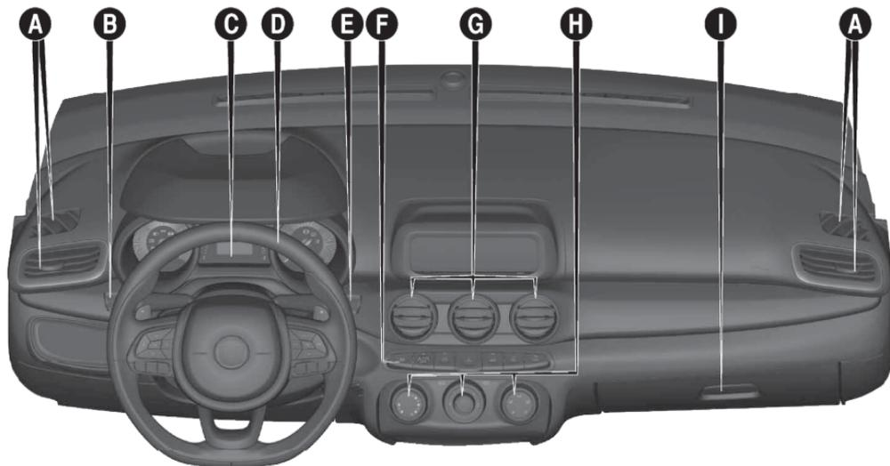
A- Difusores de ar laterais B- Alavanca esquerda (comando de farol alto/baixo e luzes de direção) C- Quadro de instrumentos D- Volante E- Alavanca direita (comando de limpeza/lavagem dos vidros) F- Botões de comando G- Difusores de ar centrais H- Comandos do ar-condicionado I- Porta-luvas
