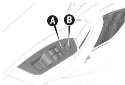
Para fechar ou abrir o retrovisor pelo comando da porta é necessário manter o seletor de retrovisor **A** na posição central e apertar o comando de ajuste **B** selecionado para a direita.
