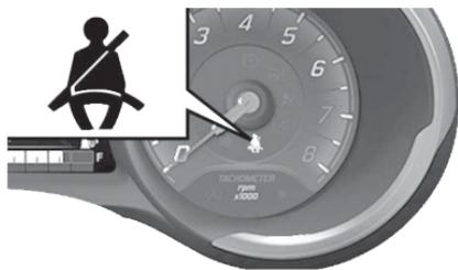
Com o veículo parado, se o cinto de segurança do lado do condutor for desafivelado, a luz permanece acesa com luz fixa.
