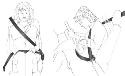
A correia do cinto de segurança não deve estar torcida. A parte superior deve passar no ombro e atravessar diagonalmente o tórax. A parte inferior deve aderir à bacia e não ao abdômen do ocupante. Não utilizar dispositivos (molas, fechos, etc.) que impeçam o contato dos cintos de segurança com o corpo dos ocupantes.
