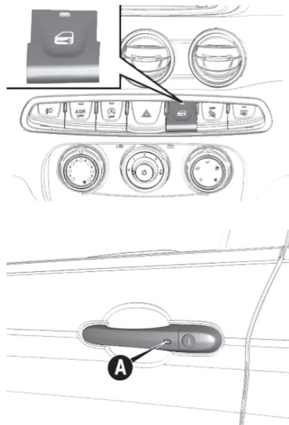
Se, no interior do veículo, for detectada uma das chaves eletrônicas e nenhuma outra chave eletrônica habilitada for detectada no exterior do veículo, a função Passive Entry destrava automaticamente todas as portas do veículo, emite três sinalizações acústicas e aciona os indicadores de direção.
