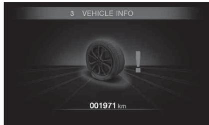
O sistema iTPMS assinala ao condutor a eventual presença de uma condição de pressão de enchimento diferente da condição no momento do reset. Se esta descer abaixo do
