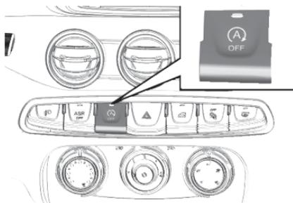
A ativação/desativação do sistema Start&Stop é indicada por uma mensagem exibida no display e/ou
