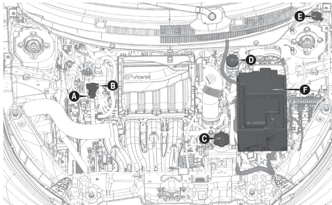
A. Vareta de controle do nível do óleo do motor – B. Tampão / Abastecimento do óleo do motor – C. Líquido de arrefecimento do motor – D. Líquido dos freios – E. Líquido do lavador do para-brisa – F. Bateria
