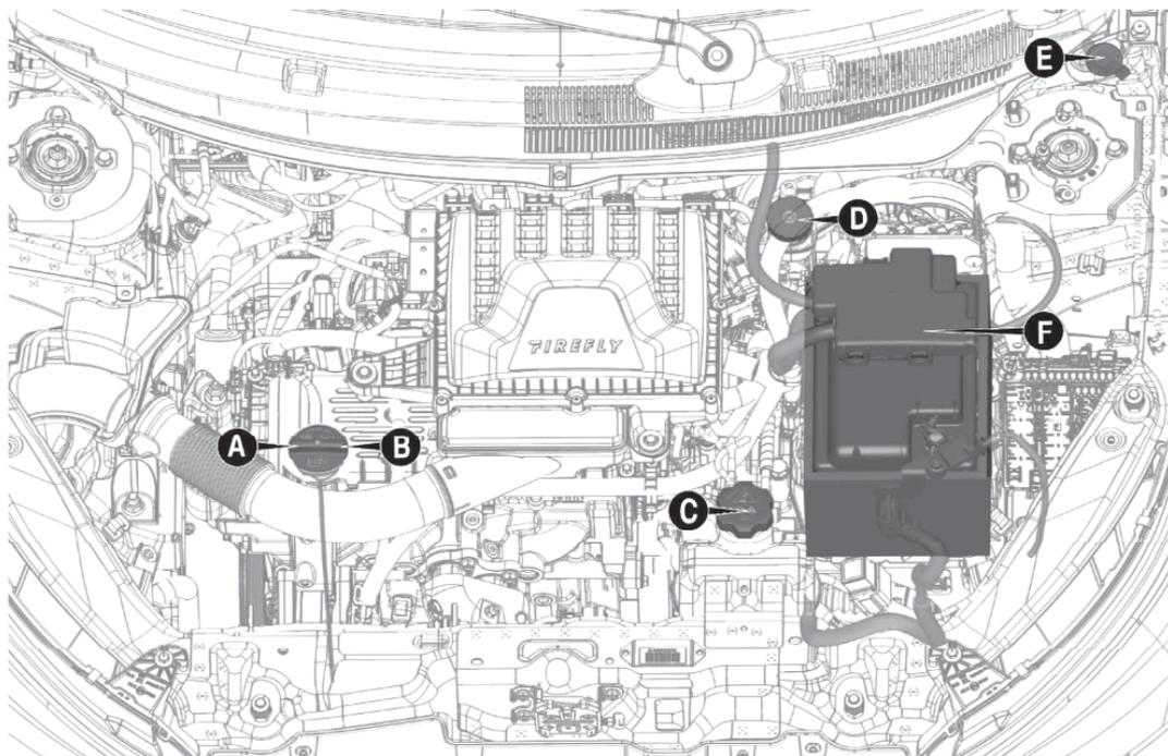
A. Vareta de controle do nível do óleo do motor – B. Tampão / Abastecimento do óleo do motor – C. Líquido de arrefecimento do motor – D. Líquido dos freios – E. Líquido do lavador do para-brisa – F. Bateria
