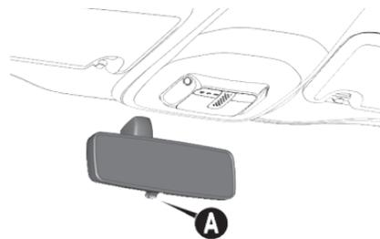
O espelho retrovisor interno é equipado com um dispositivo contra acidentes que o desprende em caso de choque.
