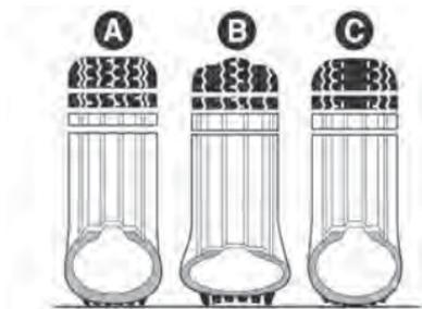
**A** - pressão normal: banda de rodagem gasta de modo uniforme.
