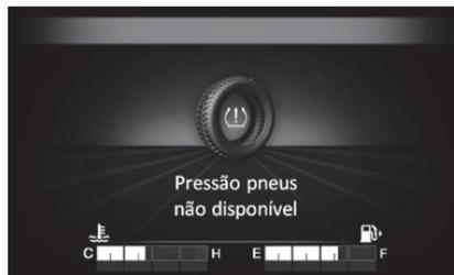
Se o sistema detectar que um ou mais pneus estão com pressão abaixo da condição inicial de monitoramento do sistema (realizada após a calibração e reset), deverá
