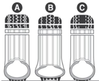
**A** - pressão normal: banda de rodagem gasta de modo uniforme.
