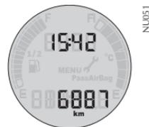
Ao ligar o veículo (chave de ignição em **MAR**), será visualizado os dados presentes antes do último desligamento. Se o display apresentava dados do hodômetro total antes do desligamento (Chave em **STOP**), então, este permanecerá no display.
