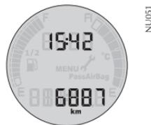
Ao ligar o veículo (chave de ignição em **MAR**), será visualizado os dados presentes antes do último desligamento. Se o display apresentava dados do hodômetro total antes do desligamento (Chave em **OFF**), então, este permanecerá no display.
