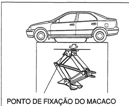
10. Posicione o macaco no ponto de apoio próximo ao pneu que vai ser substituído. Gire o suporte da alavanca no sentido horário até a parte superior do macaco encostar no ponto de apoio. Certifique-se que a tira do ponto de fixação do macaco está assentado no chanfro do macaco.
