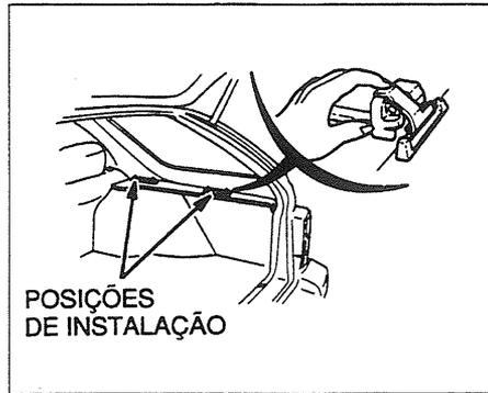
Para remover a unidade de estojo da capa, pressione a lingüeta da extremidade direita do estojo e puxe-o para fora do suporte e, em seguida, puxe a extremidade oposta para fora do seu suporte.
