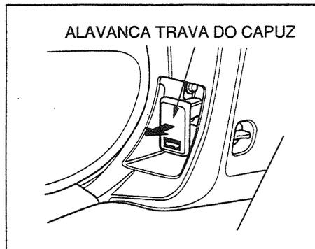
1. Posicione a alavanca do câmbio em P ou ponto morto e acione o freio de estacionamento. Puxe a alavanca da trava do capuz, localizada sob o painel no lado do motorista. O capuz se levantará levemente.
