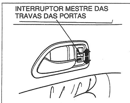
Há um interruptor mestre de controle de travas das portas na porta do motorista. Todas as portas podem ser travadas e destravadas através do interruptor mestre. Pressione o interruptor para baixo para travar e pressione-o para cima para destravar as portas.
