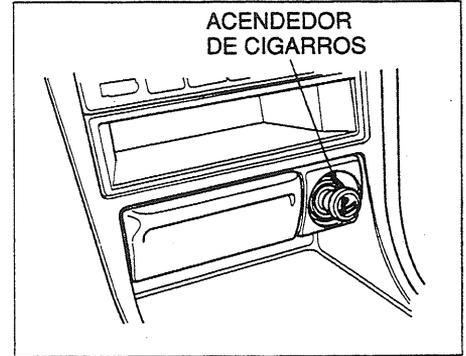
O interruptor de ignição deve estar nas posições (I) ou (II) para funcionar o acendedor de cigarros. Pressione o acendedor para aquecê-lo. Ele irá se soltar automaticamente quando o elemento tornar-se quente. Não mantenha o aquecedor pressionado com o dedo. Isso pode superaquecê-lo e poderá danificar o elemento incandescente e o aquecedor.
