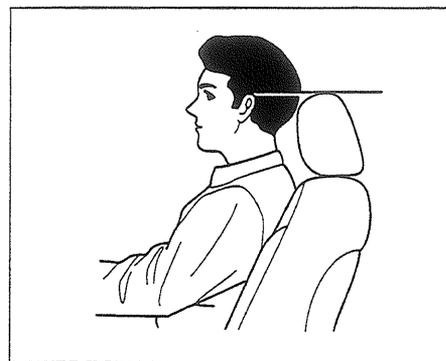
O apoio de cabeça ajuda a proteger a cabeça e o pescoço durante a colisão traseira. Para uma melhor proteção, a superfície superior do apoio de cabeça deve estar na altura da parte superior das suas orelhas. Para maiores informações sobre o ajuste do apoio de cabeça, consulte a página 49.
