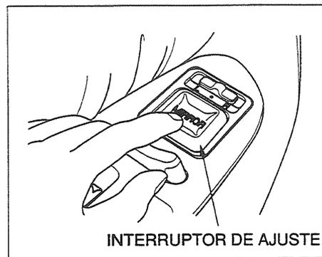
3. Pressione a extremidade apropriada do interruptor de ajuste para mover o espelho para direita ou esquerda, para cima ou para baixo.
