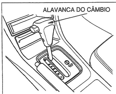
A alavanca de câmbio possui sete posições. Ela deve estar na posição P ou N para dar partida no motor. Quando estiver parado com a alavanca de câmbio nas posições D4, D3, 2, 1 ou R, pressione o pedal do freio firmemente e mantenha seu pé fora do pedal do acelerador.
