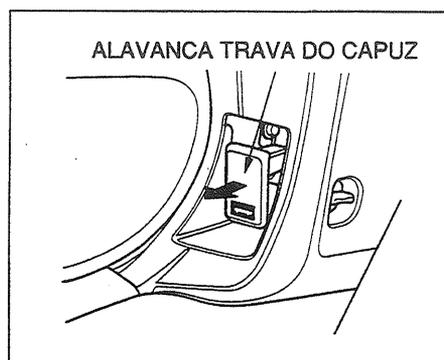
1. Posicione a alavanca do câmbio em P ou ponto morto e acione o freio de estacionamento. Puxe a alavanca da trava do capuz, localizada sob o painel no lado do motorista. O capuz se levantará levemente.
