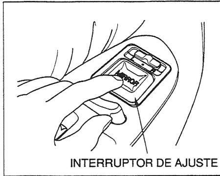
3. Pressione a extremidade apropriada do interruptor de ajuste para mover o espelho para direita ou esquerda, para cima ou para baixo.
