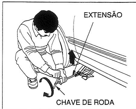
11. Usando a chave de rodas como manivela, levante o automóvel até o pneu ficar totalmente suspenso.
