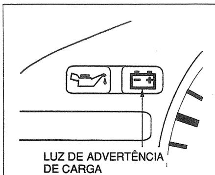
A luz de advertência do sistema de carga deve apagar-se após a partida do motor. Se a luz de advertência acender-se com o motor em funcionamento, o alternador não está carregando a bateria.
