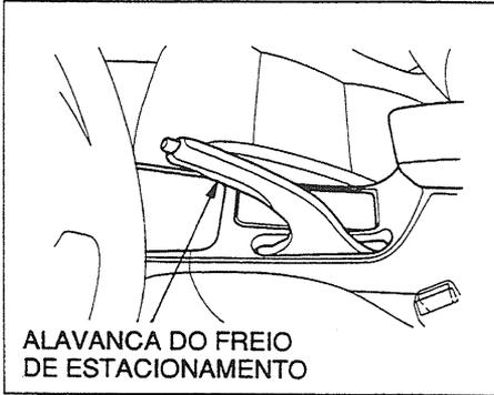
Para acionar o freio de estacionamento, puxe a alavanca totalmente para cima. Para soltá-lo, puxe a alavanca ligeiramente para cima, pressione o botão e abaixe a alavanca. A luz de advertência no painel irá apagar-se quando o freio de estacionamento estiver totalmente solto.
