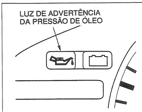
A luz de advertência da pressão de óleo nunca deve acender-se quando o motor está em funcionamento. Se esta luz acender-se com o motor em funcionamento, desligue o motor o mais rápido possível.
