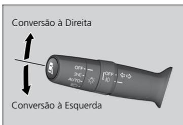
Os sinalizadores de direção podem ser usados quando o modo de alimentação for definido para o modo **LIGADO**.
