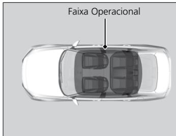
Se a bateria do controle remoto de acesso sem chave estiver com pouca carga, o motor pode não dar partida ao pressionar o botão **ENGINE START/STOP**. Se o motor não der partida, consulte
