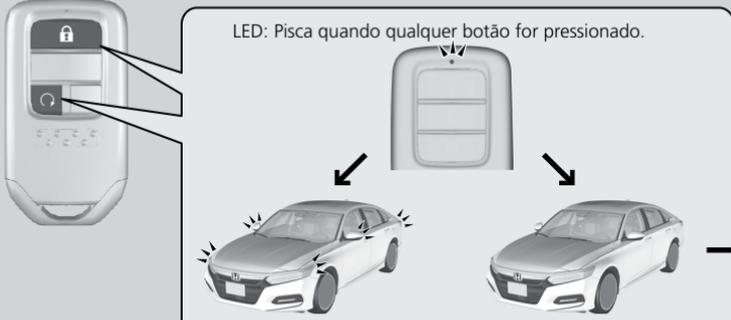
As luzes dos sinalizadores de direção piscam seis vezes, se o motor entrar em funcionamento com sucesso.
