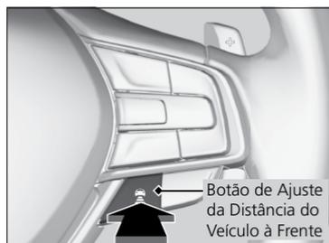
Pressione o botão (Definição da distância do veículo à frente) para alterar a distância definida do ACC com LSF, do veículo detectado à frente.
