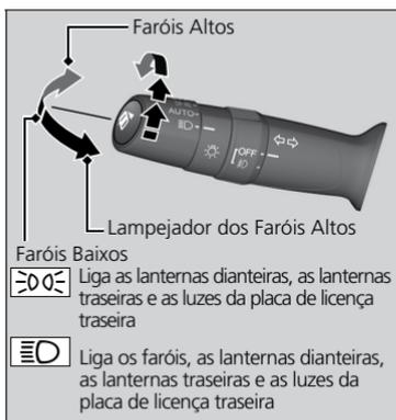
Ao girar o interruptor das luzes, as luzes se acendem e se apagam, independentemente da definição do modo de alimentação.
