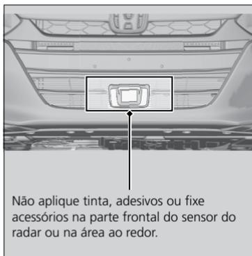
O sensor do radar está na parte inferior do para-choque dianteiro.
