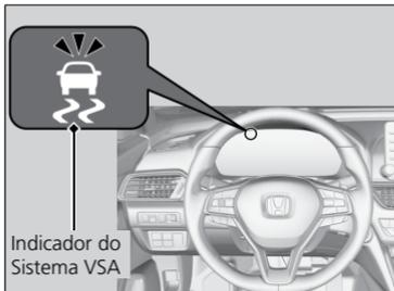
Quando o sistema VSA for ativado, nota-se que o motor não responde ao acelerador.
