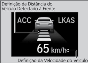
Quando o ACC com LSF começar a funcionar, o ícone do veículo, as barras da distância definida do veículo detectado à frente e a velocidade definida, aparecem na interface de informações ao motorista.
