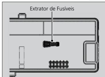
Seu veículo possui um extrator de fusíveis na parte interna da tampa da caixa de fusíveis no compartimento do motor.
