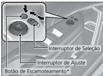
Os espelhos retrovisores externos podem ser ajustados quando o interruptor de ignição\* está na posição **LIGADA** \*<sup>1</sup>.
