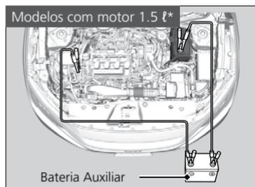
6. Conecte o segundo cabo auxiliar ao terminal (-) da bateria auxiliar.
