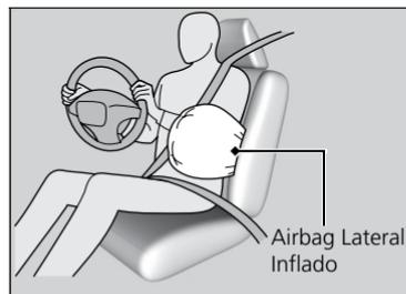
Quando os sensores detectam um impacto lateral de moderado a severo, a unidade de controle sinaliza ao airbag lateral do lado do impacto para inflar imediatamente.
