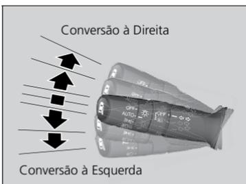
Os sinalizadores de direção podem ser usados quando o interruptor de ignição\* está na posição **LIGADA III**\*1.
