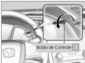
Quando as lanternas estiverem ligadas e o interruptor de ignição\* estiver na posição **LIGADA** \*1, você pode usar o botão de controle de iluminação para ajustar a iluminação do painel de instrumentos.
