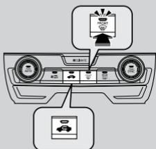
Ao pressionar o botão
