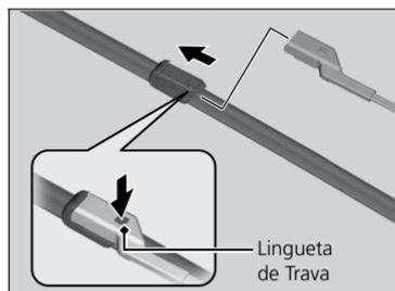
4. Pressione a lingueta de trava e, em seguida, deslize a palheta para fora da haste do limpador.
