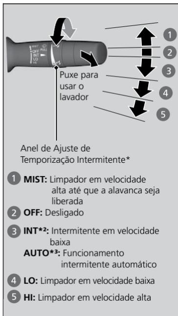
Os limpadores e lavadores do para-brisa podem ser usados quando o interruptor de ignição\* estiver na posição **LIGADA III** \*1.
