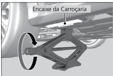
2. Gire a extremidade do suporte do macaco no sentido horário, como indicado na figura, até a base superior do macaco encostar no encaixe da carroçaria.
