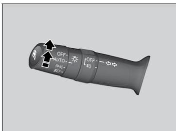
O controle de iluminação automática pode ser usado quando o interruptor de ignição\* estiver na posição **LIGADA** **II** \*1.
