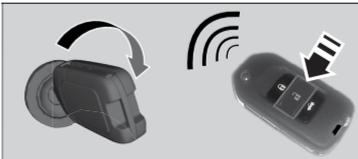
O aquecimento começa ao girar o interruptor de ignição para a posição **LIGADA** (II) ou ao destravar a porta do motorista com o controle remoto.
