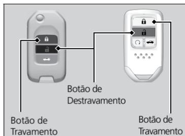
**Para abrir:** Pressione o botão de destravamento e, em seguida, dentro de 10 segundos, pressione-o novamente e mantenha-o pressionado.
