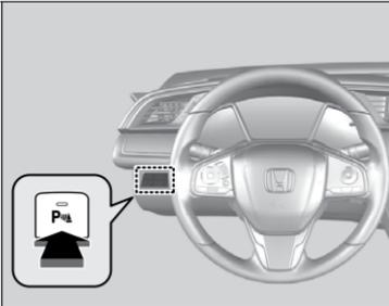
Com o interruptor de ignição\* na posição **LIGADA** **II**\*1, pressione o botão do sistema do sensor de estacionamento para ligar ou desligar o sistema. O indicador no botão acende quando o sistema esta ligado.
