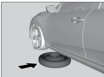
6. Coloque o estepe temporário (lado da roda para cima) embaixo da carroçaria do veículo, próximo ao pneu a ser substituído.
