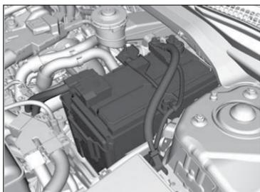
3. Abra a cobertura da caixa de fusíveis do terminal ⊕ da bateria do veículo.
