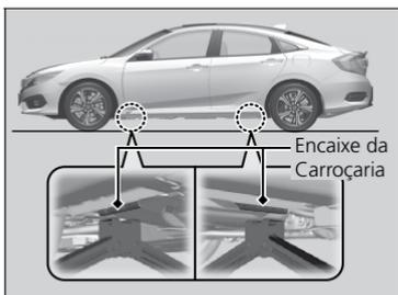
1. Coloque o macaco sob o encaixe da carroçaria mais próximo ao pneu a ser substituído.
