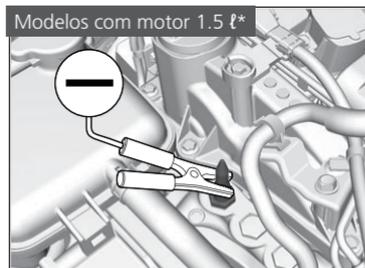
7. Conecte a outra extremidade do segundo cabo auxiliar ao parafuso de fixação do motor (ponto terra), como mostrado. Não conecte esse cabo em qualquer outra parte do motor.
