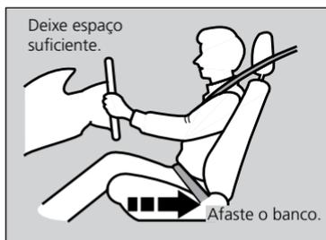
Ajuste o banco do motorista o mais atrás possível de maneira a manter total controle do veículo. Deve ser possível sentar-se ereto, bem atrás no banco e também pressionar adequadamente os pedais sem inclinar-se para a frente, além de segurar confortavelmente o volante de direção. Ajuste o banco do passageiro dianteiro da mesma maneira, para que fique o mais afastado possível do airbag dianteiro no painel de instrumentos.
