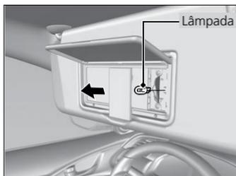
1. Usando uma chave de fenda, levante a borda da lente para removê-la.
