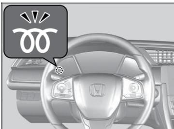
4. Certifique-se de que o indicador de pré-aquecimento esteja apagado, antes de girar o interruptor de ignição.
