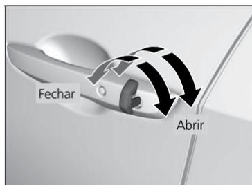
**Para abrir\*:** Destrave a porta do motorista com a chave. Dentro de 10 segundos após retornar a chave à posição central, gire a chave na direção de destravamento e segure-a nesta posição.
