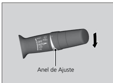
Ao movimentar a alavanca dos limpadores para baixo, para a posição **AUTO**, os limpadores do para-brisa funcionam uma vez e entram no modo automático.
