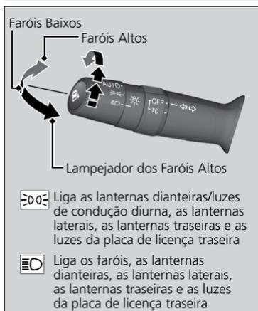
Ao girar o interruptor das luzes, as luzes se acendem e se apagam, independentemente da definição do modo de alimentação\* e da posição do interruptor de ignição\*.
