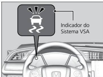
Quando o sistema VSA for ativado, nota-se que o motor não responde ao acelerador. Também é possível notar alguns ruídos provenientes do sistema hidráulico. O indicador também piscará.
