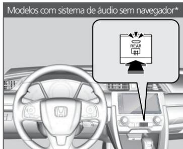
O desembaçador do vidro traseiro desliga automaticamente após 10 - 30 minutos, dependendo da temperatura externa.
