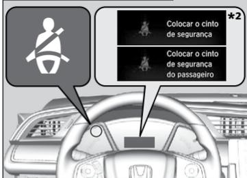
O seu veículo monitora o uso do cinto de segurança do motorista e do passageiro dianteiro. Se o interruptor de ignição\* estiver na posição **LIGADA** \*<sup>1</sup> e o motorista não estiver usando o cinto de segurança, um bipe soará e o indicador piscará. Se o motorista não colocar o cinto de segurança antes do bipe parar, o indicador permanecerá aceso.
