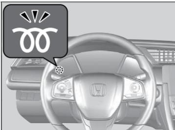
O indicador de pré-aquecimento se acende e, em algumas situações poderá piscar, durante este período de aquecimento. Certifique-se de que o indicador de pré-aquecimento se apagou antes de girar o interruptor de ignição para a posição **PARTIDA** (III). Não pressione o pedal do acelerador durante a partida.
