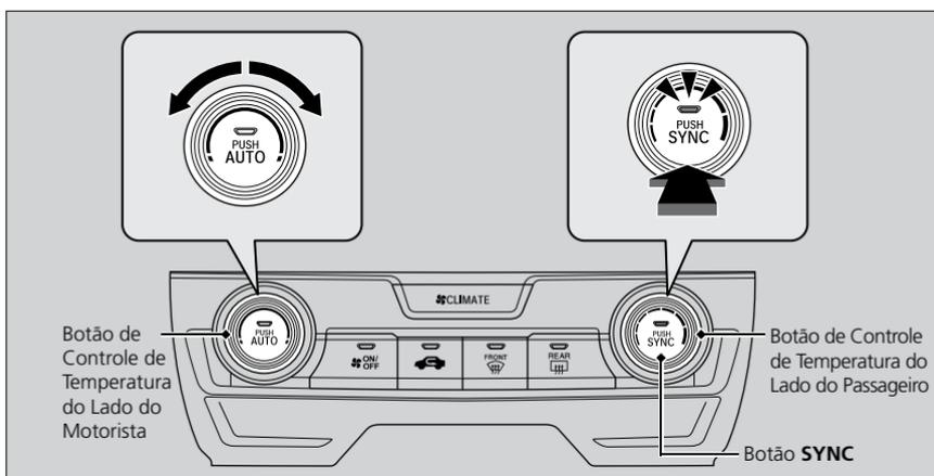
Pode-se ajustar a temperatura sincronizadamente para os lados do motorista e do passageiro no modo sincronizado.
