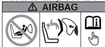
**NÃO** coloque um sistema de proteção infantil voltado para trás no banco equipado com airbag.
