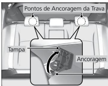
Existe um ponto de ancoragem atrás de cada posição externa. Um sistema de proteção infantil instalado com cinto de segurança, que seja equipado com trava, pode usá-lo para segurança adicional.
