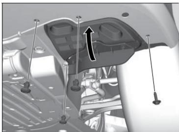
1. Remova as presilhas usando uma chave de fenda, remova o parafuso e empurre o protetor interno para cima.
