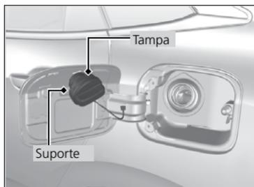
7. Coloque a tampa do tanque de combustível no suporte.
