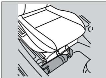
Caso deseje instalar o extintor de incêndio, o local ideal para sua instalação é sob o assento dianteiro, no lado do passageiro dianteiro, fixado à carroçaria do veículo.
