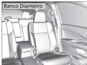
Ao substituir os cintos de segurança, use os pontos de fixação mostrados nas ilustrações. O banco dianteiro tem um cinto de segurança de três pontos.
