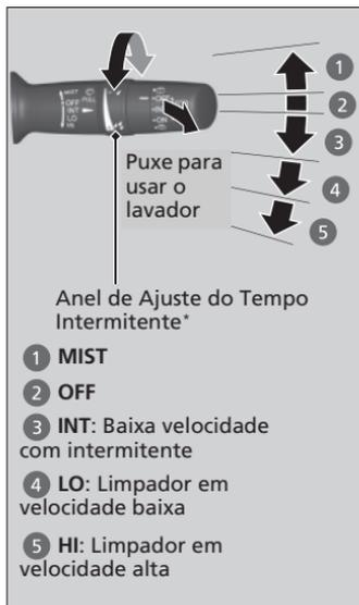
Os limpadores e lavadores do para-brisa podem ser usados quando a chave de ignição estiver na posição LIGADA **II**.
