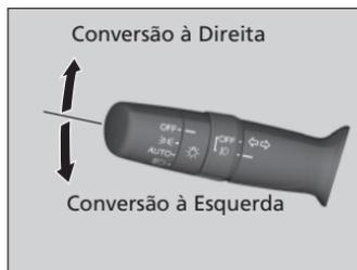
Os sinalizadores de direção podem ser usados quando a chave de ignição estiver na posição LIGADO **II**.
