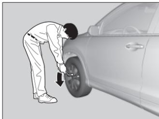
7. Solte cada uma das porcas de roca aproximadamente uma volta usando a chave de roda.
