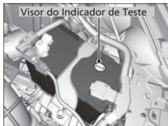
Verifique mensalmente a condição da bateria. Inspeccione o visor do indicador de teste e verifique os terminais se há corrosão nos terminais.
