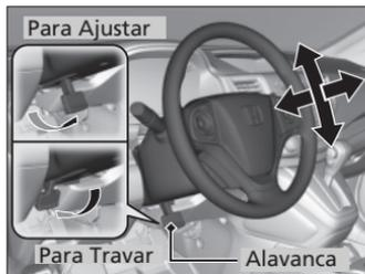
1. Puxe a alavanca de ajuste do volante de direção.
