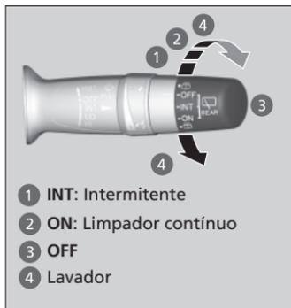
Os limpadores e lavadores do para-brisa podem ser usados quando a chave de ignição estiver na posição LIGADO **II**.
