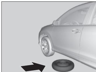
6. Coloque o pneu sobressalente (lado da roda para cima) embaixo da carroceria do veículo, próximo ao pneu que precisa ser substituído.
