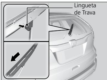
2. Pressione a lingueta de trava e deslize o suporte da palheta para fora da haste do limpador.
