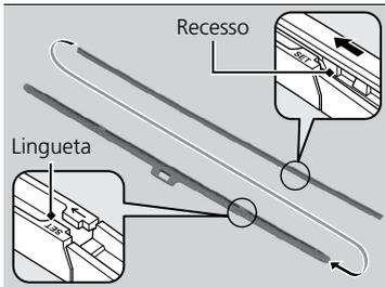
**4.** Deslize a borracha da palheta do limpador para fora do suporte, puxando a extremidade da lingueta para fora.
