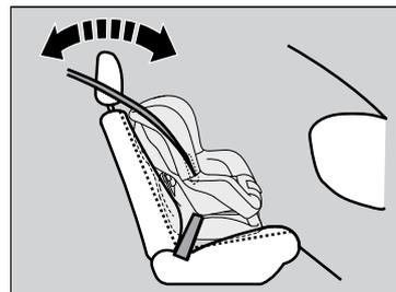
►► Instalação de um Sistema de Proteção Infantil com Cinto de Segurança de Três Pontos (Universal\*1)
