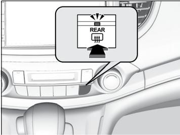
O desembaçador do vidro traseiro desliga-se automaticamente após 10 - 30 minutos, dependendo da temperatura externa. No entanto, com temperaturas externas de 0°C ou menos, ele não desligará automaticamente.
