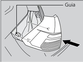
5. Reinstale o conjunto da lanterna traseira, deslizando-o na guia existente na carroçaria.
