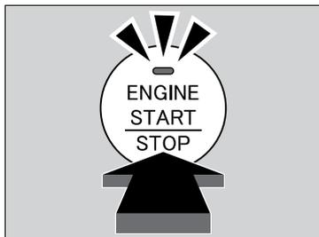
2. Pressione o pedal de freio e pressione o botão **ENGINE START/STOP** dentro de 10 segundos, após o alerta sonoro soar e o indicador alterar de piscando para aceso.
