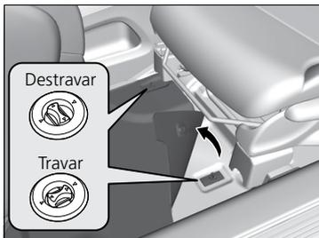
O tapete do motorista é fixado às ancoragens do assoalho, impedindo que escorregue para a frente. Para remover o tapete para limpeza, gire os botões de ancoragem para a posição de destravamento, como indicado na figura. Ao reinstalar o tapete após a limpeza, posicione-o corretamente e gire os botões de ancoragem para a posição de travamento, como indicado na figura.
