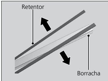
4. Remova os retentores da borracha da palheta do limpador e instale-os na nova borracha da palheta.
