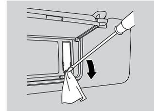
1. Usando uma chave de fenda, levante a borda da lente para removê-la.
