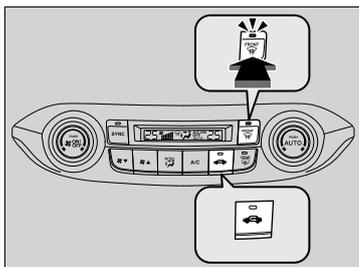
Ao pressionar o botão
