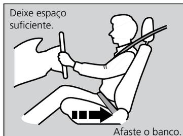
Ajuste o banco do motorista o mais atrás possível de maneira a manter total controle do veículo. Deverá ser possível sentar-se ereto, bem atrás no banco e também pressionar adequadamente os pedais sem inclinar-se para a frente, além de segurar confortavelmente o volante de direção. Ajuste o banco do passageiro dianteiro da mesma maneira, para que fique o mais afastado possível do airbag dianteiro no painel de instrumentos.
