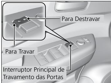
Pressione o interruptor principal de travamento das portas, conforme indicado, para travar ou destravar todas as portas e a tampa traseira.
