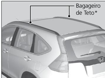
Os veículos equipados com bagageiro de teto podem transportar carga desde que o peso total (bagagem + acessório do bagageiro) não exceda 75 kg e sejam distribuídos uniformemente.
