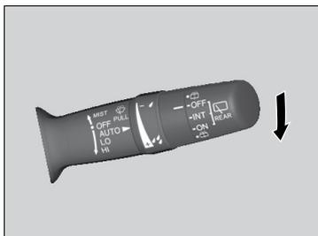
Ao movimentar a alavanca para a posição **AUTO**, os limpadores do para-brisa funcionam uma vez e entram no modo automático.
