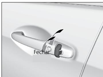
**Para fechar:** Trave a porta do motorista com a chave embutida. Gire duas vezes a chave em até 10 segundos e mantenha-a totalmente à esquerda na segunda vez. Solte a chave quando o vidro estiver na posição desejada. Se os vidros pararem no meio do percurso, repita o procedimento.
