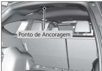
Existem três pontos de ancoragem, localizados no teto, para os bancos traseiros.
