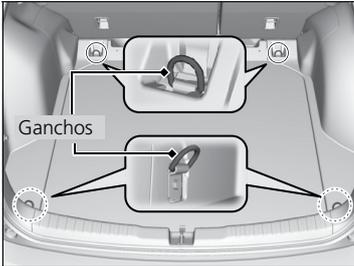
Os ganchos de amarração das bagagens no assoalho do compartimento de bagagem podem ser usados para instalar uma rede para proteção de objetos.
