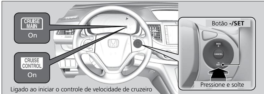
Ao atingir a velocidade desejada, pressione o botão **[-/SET]** e solte o pedal do acelerador. No momento em que o botão **[-/SET]** for liberado, a velocidade será fixada e o controle de velocidade de cruzeiro será acionado. O indicador **CRUISE CONTROL** se acenderá.
