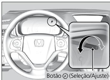
Quando o modo de alimentação estiver no modo **LI-GADO** e as luzes externas estiverem ligadas, é possível usar o botão de controle de iluminação para ajustar a iluminação do painel de instrumentos.
