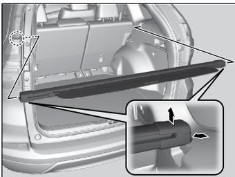
A cobertura do compartimento de bagagens pode ser usada para ocultar itens no compartimento de bagagem ou protegê-los da luz solar.
