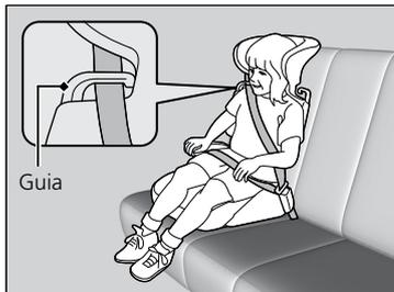
Instale no assento de elevação o encosto de cabeça compatível e ajuste-o ao banco do veículo de acordo com as instruções do fabricante desse sistema de proteção infantil. Certifique-se de que o cinto de segurança esteja passado adequadamente pela guia no ombro do encosto e que o cinto não toque nem cruze o pescoço da criança.
