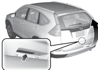
Pressione o botão de abertura da tampa traseira para destravar e abrir a tampa traseira, quando você estiver carregando o controle remoto de acesso sem chave.
