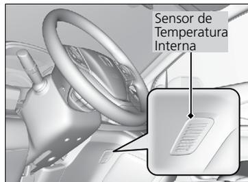
O sistema de controle de climatização está equipado com um sensor solar e um sensor de temperatura interna. Não cubra nem derrame líquidos nesses sensores.
