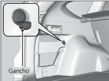
Os ganchos para bagagem em ambos os lados do compartimento de bagagem podem ser utilizados para pendurar itens leves.
