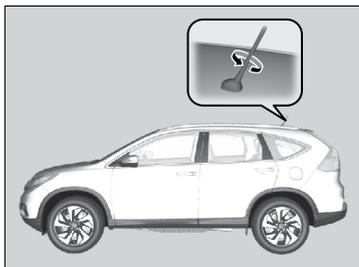
O seu veículo está equipado com uma antena removível na parte traseira do teto.
