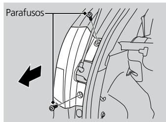
1. Remova os parafusos, usando uma chave Philips.
