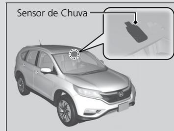
Não coloque a alavanca dos limpadores na posição **AUTO**, ao limpar o para-brisa ou dirigir em um lava-rápido. Se a alavanca do limpador estiver na posição **AUTO** e o modo de alimentação estiver no modo **LIGADO**, o sensor de chuva poderá reagir à sua mão ou água e os limpadores podem funcionar automaticamente.
