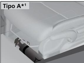
Caso deseje instalar o extintor de incêndio, o local ideal para sua instalação é sob o assento dianteiro, no lado do motorista (Tipo A\*1) ou sob o assento dianteiro, no lado do passageiro dianteiro (Tipo B\*1).
