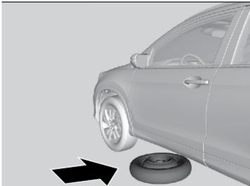
6. Coloque o estepe (lado da roda para cima) embaixo da carroçaria do veículo, próximo ao pneu a ser substituído.
