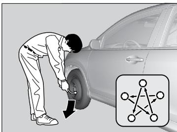
5. Abaixue o veículo e remova o macaco. Aperte as porcas da roda na ordem indicada pela figura. Aperte as porcas duas ou três vezes nessa ordem.
