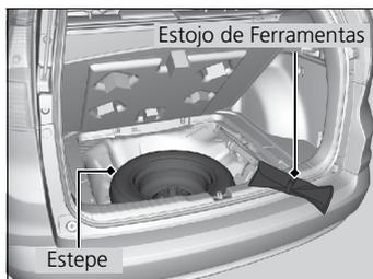
2. Retire o estojo de ferramentas do compartimento de bagagem. Retire a chave de roda e a barra da alavanca do macaco do estojo de ferramentas.
