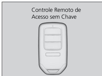
Use o controle remoto de acesso sem chave para ligar e desligar o motor, travar e destravar todas as portas e abrir a tampa traseira. Os botões do controle remoto de acesso sem chave travam e destravam as portas e a tampa traseira.
