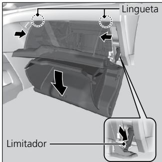
2. Desencaixe as duas linguetas pressionando cada painel lateral, e em seguida, pressione o limitador para baixo.
