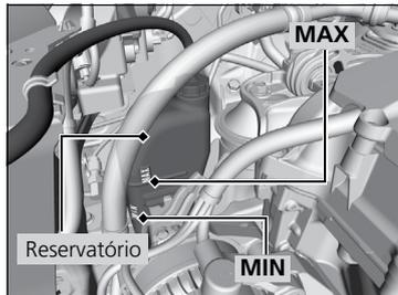
1. Depois que o motor tiver esfriado, inspecione o nível do líquido de arrefecimento e verifique se há vazamento nos componentes do sistema de arrefecimento.
