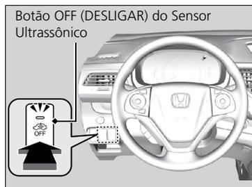
Para desligar o sistema do sensor ultrassônico, pressione o botão (Desligar) do sensor ultrassônico com o modo de alimentação no modo **ACESSÓRIOS** ou **VEÍCULO DESLIGADO**.
