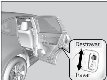
Deslize a alavanca na coluna da porta traseira para a posição travada e feche a porta.
