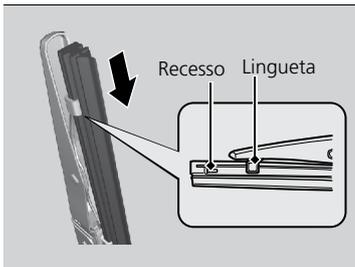
5. Deslize a borracha da palheta do limpador sobre o suporte, até que o recesso existente na borracha da palheta se encaixe na lingueta da palheta.
