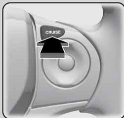
**CRUISE MAIN** acende no painel de instrumentos. O controle de velocidade de cruzeiro está pronto para uso.
