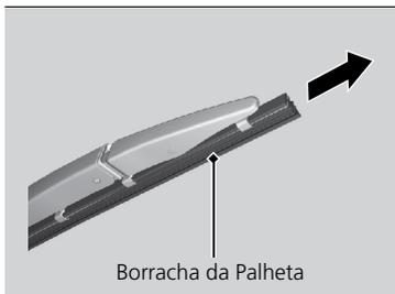
3. Deslize a borracha da palheta do limpador para fora a partir da extremidade com o recesso.
