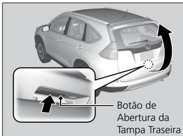
Ao destravar todas as portas ou pressionar o botão de abertura da tampa traseira no controle remoto de acesso sem chave, a tampa traseira é destravada.
