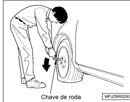
7. Solte os quatro parafusos, 1/2 volta, com a chave de roda.
