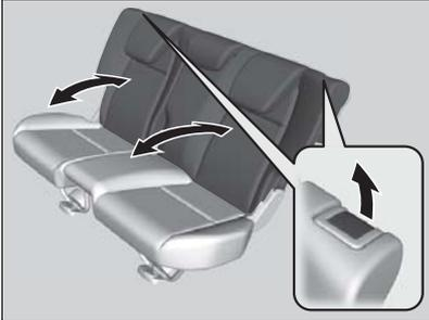
Puxe a alavanca superior direita para alterar o ângulo da metade direita do encosto e a alavanca superior esquerda para alterar o ângulo da metade esquerda.
