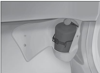
O extintor de incêndio está localizado sob o painel de instrumentos, no lado do passageiro dianteiro, fixado à carroçaria do veículo.
