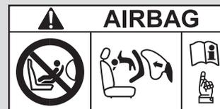
**NÃO coloque um sistema de proteção infantil voltado para trás no banco equipado com airbag. Se for inevitável a instalação de um sistema de proteção para criança voltado para trás no banco do passageiro dianteiro, você deve desativar manualmente o sistema de airbag do passageiro dianteiro, usando a chave de ignição. → P.40**
