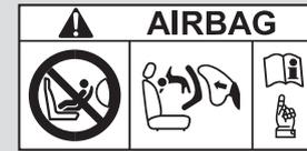
**NÃO coloque um sistema de proteção infantil voltado para trás neste banco equipado com airbag. Se for inevitável a instalação de um sistema de proteção para criança voltado para trás no banco do passageiro dianteiro, você deve desativar manualmente o sistema de airbag do passageiro dianteiro, usando a chave de ignição.** → P.40
