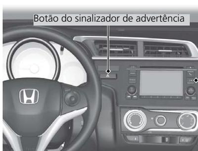
Pressione o botão localizado à esquerda do sistema de áudio, no painel de instrumentos, para acionar o sinalizador de advertência. Todos os sinalizadores externos e luzes indicadoras no painel de instrumentos piscarão, enquanto o sinalizador de advertência permanecer acionado. Para desligar, pressione o botão novamente.
