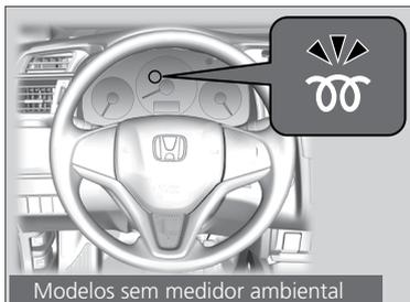
4. Certifique-se de que o indicador de pré-aquecimento tenha se apagado e então coloque o interruptor de ignição na posição **PARTIDA**
