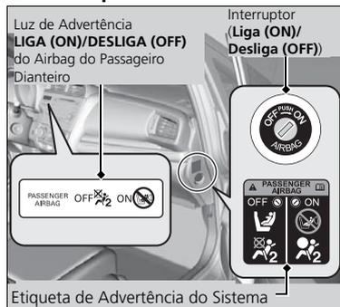
Quando o interruptor **LIGA (ON)/DESLIGA (OFF)** do airbag do passageiro dianteiro estiver em:
