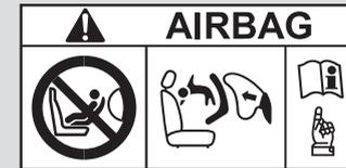
**NÃO coloque um sistema de proteção infantil voltado para trás no banco equipado com airbag. Se for inevitável a instalação de um sistema de proteção para criança voltado para trás no banco do passageiro dianteiro, você deve desativar manualmente o sistema de airbag do passageiro dianteiro, usando a chave de ignição. ➔ P.43**
