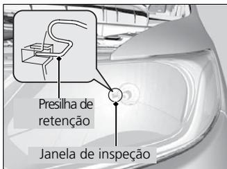
5. Reinstale a presilha de retenção. Enganche a extremidade da presilha na fenda.
