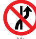
R-8a Proibido mudar de faixa ou pista de trânsito da esquerda para direita
