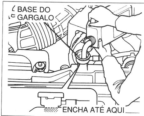
6. Misture a solução recomendada com igual quantidade de água destilada ou água de baixo teor mineral. Verifique a capacidade do sistema de arrefecimento. Capacidade: 8,7 litros
