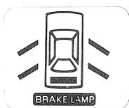
A lâmpada apropriada deste painel acenderá quando a porta do compartimento de bagagens ou outras portas não estiverem fechadas corretamente. Se a luz do freio não estiver funcionando, a indicadora BRAKE LAMP acenderá quando acionar o pedal do freio com o interruptor de ignição ligado (posição II).
