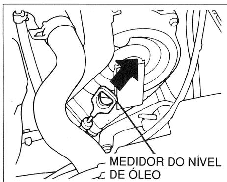
Verifique o nível do óleo do motor, toda vez que for abastecer o tanque de combustível, com o automóvel estacionado em um local plano. Espere pelo menos dois minutos após desligar o motor antes de efetuar a verificação do nível de óleo.
