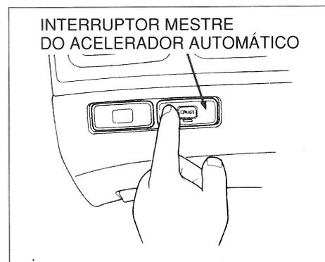
1. Pressione o interruptor mestre do Acelerador Automático no painel de instrumentos. A luz indicadora do mesmo acenderá.
