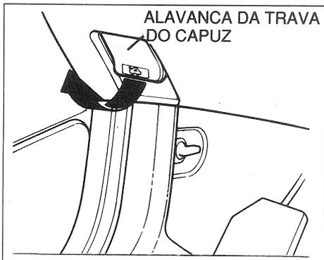
1. Posicione a alavanca do câmbio em P ou ponto morto e acione o freio de estacionamento. Puxe a alavanca da trava do capuz, localizada sob o painel no lado do motorista. O capuz levantará levemente.
