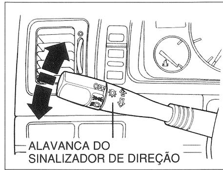
Mova a alavanca do sinalizador para baixo para sinalizar uma conversão à esquerda e mova-a para cima para sinalizar uma conversão à direita. As lâmpadas apropriadas do indicador e do sinalizador acenderão intermitentemente. A alavanca retornará automaticamente à sua posição original quando o volante da direção retornar à sua posição normal.
