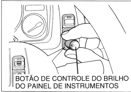
Um botão, localizado no lado direito do painel de instrumentos, controla a intensidade das luzes do painel de instrumentos. Puxe o botão para fora e gire-o para ajustar a intensidade das luzes do painel. Em seguida, pressione-o de volta.
