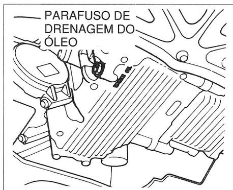
1. Ligue o motor e aqueça-o até a temperatura normal de funcionamento e desligue-o.
