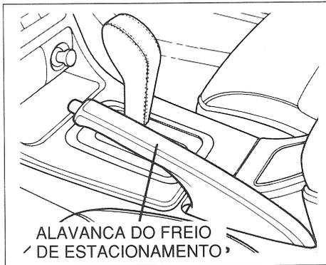
Para acionar o freio de estacionamento, puxe a alavanca totalmente para cima. Para soltá-lo, puxe a alavanca ligeiramente para cima, pressione o botão e abaixe a alavanca. A luz de advertência no painel irá apagar quando o freio de estacionamento estiver totalmente solto.
