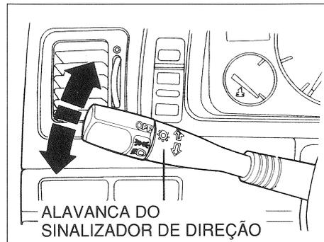
Mova a alavanca do sinalizador para baixo para sinalizar uma conversão à esquerda e mova-a para cima para sinalizar uma conversão à direita. As lâmpadas apropriadas do indicador e do sinalizador acenderão intermitentemente. A alavanca retornará automaticamente à sua posição original quando o volante da direção retornar à sua posição normal.
