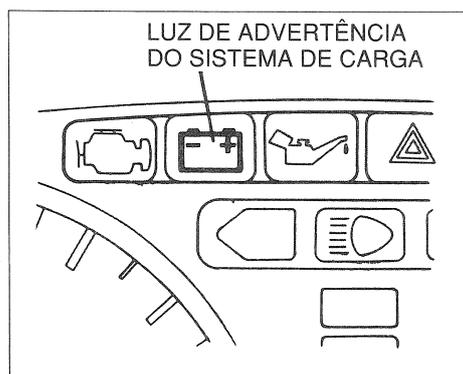
A luz de advertência do sistema de carga deve apagar-se após a partida do motor. Se a luz indicadora acender com o motor em funcionamento, o alternador não está carregando a bateria.
