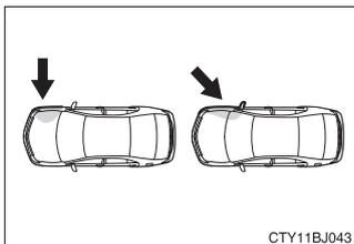
Os airbags laterais e de cortina em geral não deflagram se o veículo for envolvido em uma colisão frontal ou traseira, se capotar, ou ainda em caso de colisão frontal em baixa velocidade.
