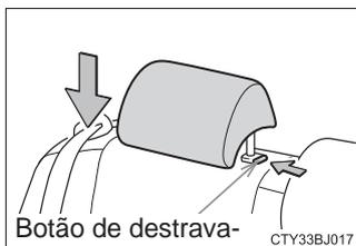
**n Ajustar a altura dos apoios de cabeça (exceto o apoio de cabeça do banco central traseiro)**
