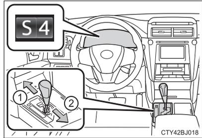
A faixa inicial de mudança do modo S é ajustada automaticamente em 4 ou 5 conforme a velocidade do veículo. Contudo, a faixa de mudança inicial pode ser posta em 3, se o sistema AI-SHIFT for operado enquanto a alavanca de mudança estiver na posição D. (→P. 152)
