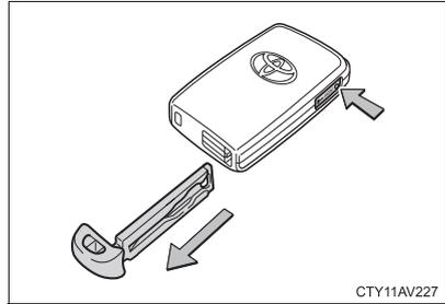
Após usar a chave mecânica, acondicione-a na chave eletrônica. Mantenha a chave mecânica junto com a chave eletrônica. Se a bateria da chave eletrônica descarregar ou a função de entrada não funcionar corretamente, você precisará da chave mecânica. (→P. 299)
