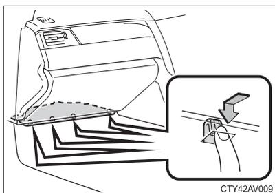
Puxe a tampa para removê-la do painel de instrumentos.
