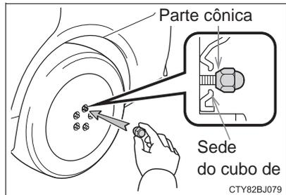
Ao substituir a roda de liga leve por outra equivalente, aperte as porcas até que a parte cônica fique presa e, frouxamente em contato, com o cubo da roda.
