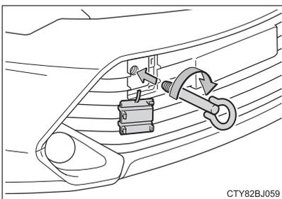
4 Aperte firmemente o olhal de rebocamento usando a chave de roda.
