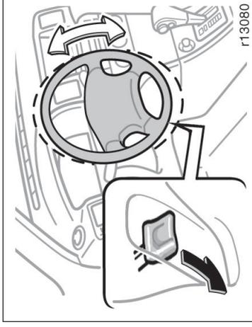
Para alterar o ângulo do volante, abaixe a alavanca de travamento, incline o volante para a posição desejada e retorne a alavanca à posição original.
