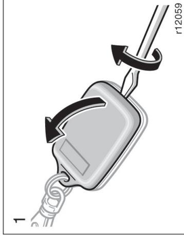
1. Usando chave de fenda, abra a carcaça do controle remoto.
