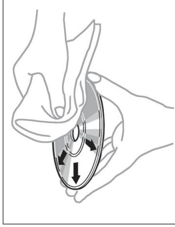
Para limpar um disco: Limpe-o com um pano úmido. Use um pano macio e que não solte fiapos. Limpe o disco começando do centro e indo para a borda em linha reta e não em círculo. Não use limpador de disco convencional ou dispositivo anti-estático.
