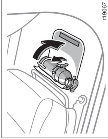
1. O extintor está localizado na parte frontal do banco do passageiro dianteiro. Sua remoção se dá abrindo a capa protetora e soltando a presilha de fixação.
