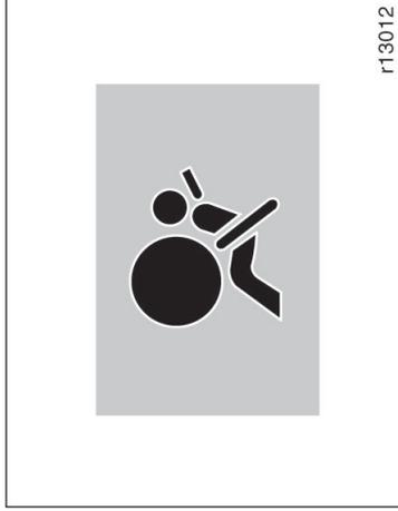
**Este indicador acende-se quando a chave da ignição está na posição "ON". Ele se apaga após aproximadamente 6 segundos. Isto significa que os SRS airbags estão operando adequadamente.**
