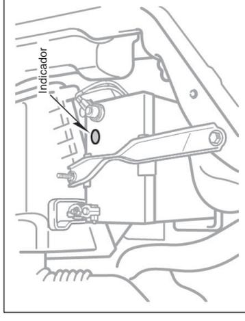
Verifique a condição de carga através da cor do indicador.
