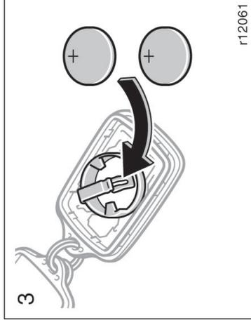
3. Instale as baterias novas, mantendo voltado para cima o lado positivo (+).
