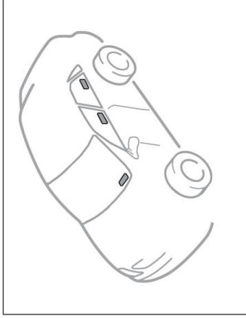
Todos os vidros possuem o número do chassi gravado próximo à identificação do fabricante.
