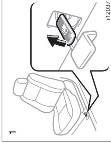
1. Para abrir a porta do bocal de alimentação, puxe a alavanca. Quando estiver abastecendo, desligue o veículo.
