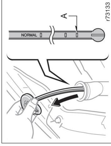
**Caso o lavador não funcione, o reservatório do fluido pode estar vazio. Verifique o nível do fluido na vareta medidora. Caso o fluido esteja abaixo da marca "A", mostre na figura, adicione fluido lavador.**
