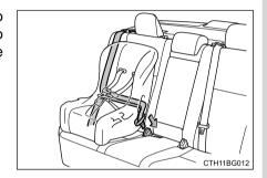
Instale a presilha de travamento próximo à lingueta do cinto de segurança (ombro e quadril) inserindo o cinto nos rebaixos da presilha de travamento. Trave o cinto novamente. Se houver folga no cinto, destrave o fecho e reinstale a presilha de travamento.
