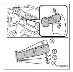
Veículos equipados com ajuste de intervalo: Os intervalos do limpador podem ser ajustados quando for selecionada a operação intermitente.
