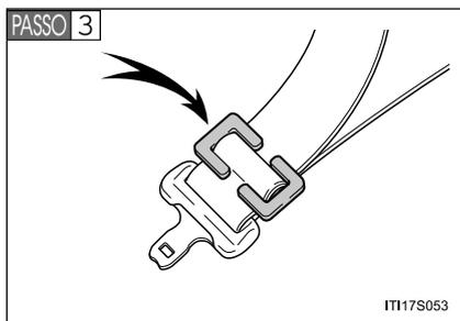
Instale a presilha de travamento próximo à lingueta do cinto de segurança (ombro e quadril) inserindo o cinto nos rebaxos da presilha de travamento. Trave o cinto novamente. Se houver folga no cinto, destrave a fivela e reinstale a presilha de travamento. (→P. 1-1-36)
