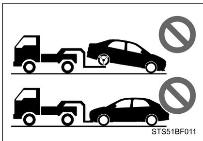
Certifique-se de transportar o veículo com as rodas dianteiras levantadas ou com as quatro rodas fora do solo. Caso o veículo seja rebocado com as rodas dianteiras em contato com o solo, o conjunto de tração e as peças relacionadas poderão ser danificadas.
