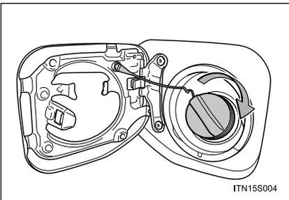
Após o reabastecimento, gire a tampa do tanque de combustível até ouvir um “click”. Após soltar, a tampa irá girar levemente no sentido oposto.
