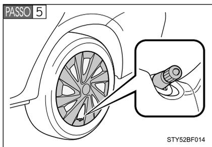
Para veículos com calota integral, reinstale a calota.
