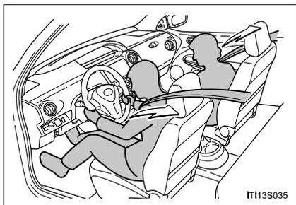
Os pré-tensionadores possibilitam uma maior proteção dos ocupantes ao retrain rapidamente os cintos de segurança quando o veículo é submetido a determinados tipos de colisão frontal grave.
