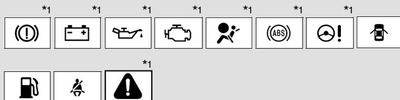
\*1: Estas luzes irão acender quando a chave de ignição for posicionada em “ON” para indicar que a inspeção do sistema está sendo executada. As luzes irão apagar após a partida do motor, ou após alguns segundos. Poderá haver impropriedade em um sistema se uma luz não acender, ou se as luzes não apagarem. Providencie a inspeção do veículo em uma Concessionária Autorizada Toyota.
