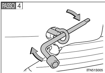
Aperte o olhal de rebocamento firmemente usando uma chave de roda ou barra de metal rígida.
