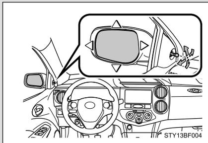
Ajuste o espelho\*\* para cima, para baixo, para a esquerda ou para a direita usando a alavanca.
