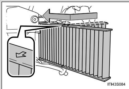
Substitua o filtro do ar condicionado por um novo.
