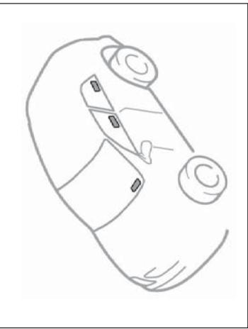
Todos os vidros possuem o número do chassis gravado próximo à identificação do fabricante.
