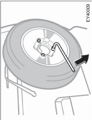
3. Gire as porcas de fixação no sentido anti-horário, utilizando a chave de roda, e remova-as.
