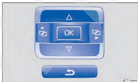
Fig. 15 Veículos com volante multifunções: botões para comandar os menus no instrumento combinado.
