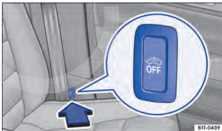
Fig. 25 Ao lado do banco do condutor: botão para desligar o monitoramento do interior do veículo e o alarme antirrebocagem.
