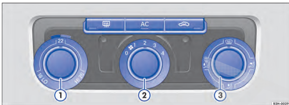
Fig. 121 No painel de instrumentos: comandos do Climatic.
