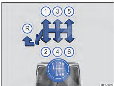
Fig. 101 Esquema de troca de marchas da transmissão manual de 6 velocidades.
