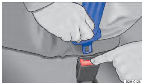
Fig. 54 Soltar a lingueta do cinto de segurança do fecho do cinto de segurança.
