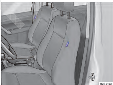
Fig. 65 Na lateral no banco dianteiro: local de instalação do airbag para cabeça e laterais combinado.
