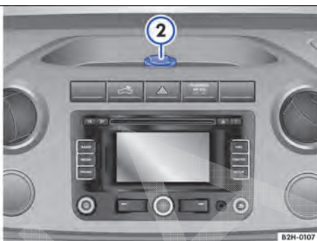
Fig. 96 Direção à esquerda: no console central dianteiro ① (em veículos com direção à direita é espelho) e no porta-objetos no painel de instrumentos ②: tomada 12 V.
