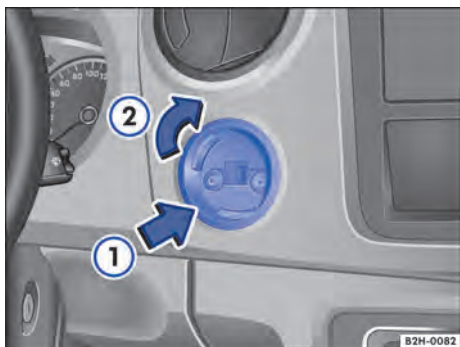
Fig. 90 Posicionar o acessório no ponto de multifixação.
