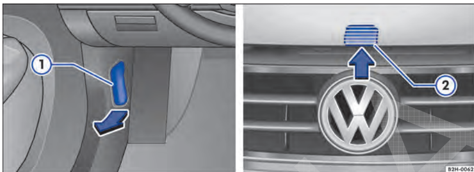
Fig. 130 ① Na área para os pés no lado do condutor: alavanca de destravamento da tampa do compartimento do motor. ② Alavanca de destravamento para abrir a tampa do compartimento do motor na grade do radiador.
