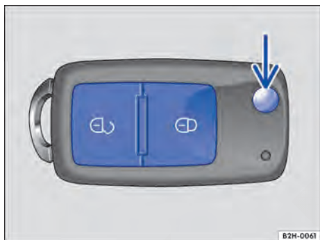
Fig. 23 Botões na chave com comando remoto e botão para rebater a haste da chave para fora.
