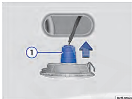
Fig. 177 Lanterna lateral dos indicadores de direção: trocar a lâmpada incandescente.
