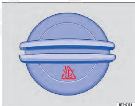
Fig. 137 No compartimento do motor: tampa do reservatório de expansão do líquido de arrefecimento do motor.
