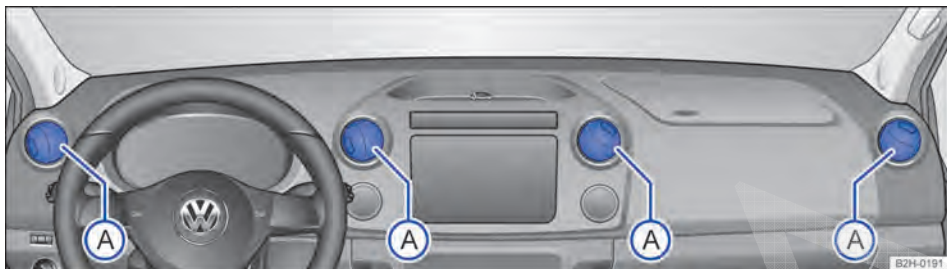
Fig. 123 Difusores de ar no painel de instrumentos.
