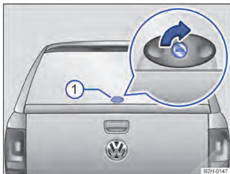
Fig. 32 Abrir a capota rígida do compartimento de carga.
