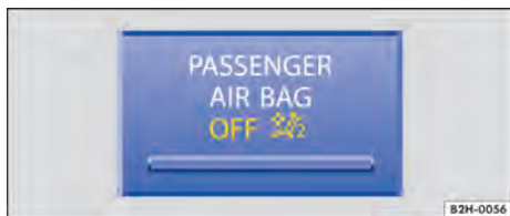
Fig. 60 Luz de controle no painel de instrumentos para o airbag frontal do passageiro dianteiro desativado.
