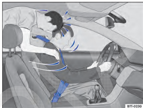
Fig. 49 O passageiro sem cinto de segurança no banco traseiro é lançado para frente sobre o condutor com cinto de segurança.
