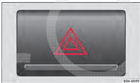
Fig. 143 No centro do painel de instrumentos: botão para ligar e desligar as luzes de advertência.
