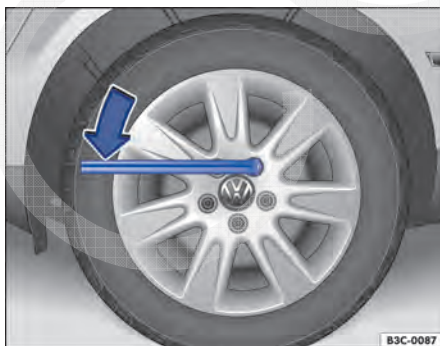
Fig. 155 Troca de roda: soltar os parafusos de roda.
