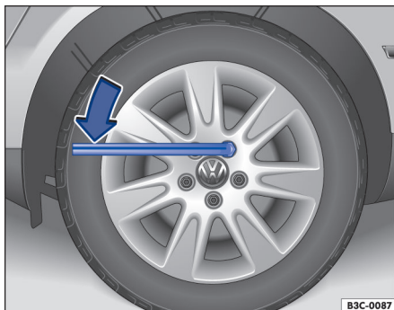
Fig. 196 Troca de roda: soltar os parafusos de roda.
