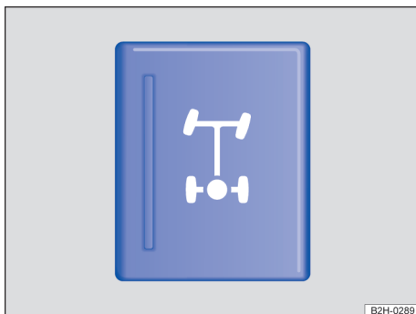
Fig. 110 No console central: botão do bloqueio do diferencial.
