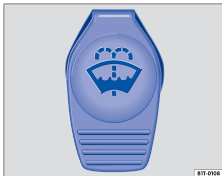
Fig. 174 No compartimento do motor: tampa do reservatório de água dos lavadores do para-brisa.
