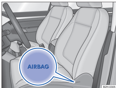
Fig. 38 Na lateral no banco dianteiro: local de instalação do airbag para cabeça e laterais combinado.
