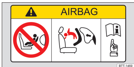
Fig. 41 Representação esquemática: etiqueta do airbag no para-sol.
