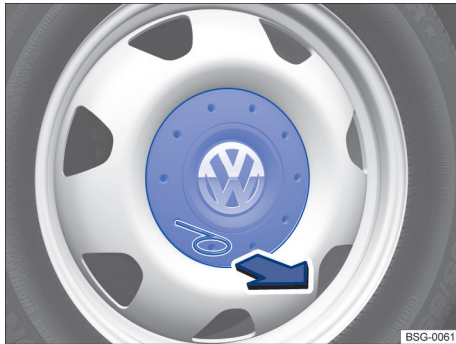
Fig. 194 Retirar a calota central.
