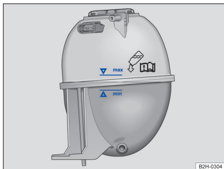
Fig. 177 No compartimento do motor: marcações no reservatório de expansão do líquido de arrefecimento (representação esquemática).
