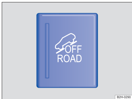
Fig. 107 No console central: botão para ligar e desligar a função off-road manualmente.
