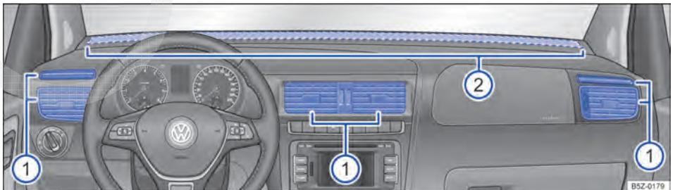
**Fig. 85** No painel de instrumentos: difusores de ar. ▶
