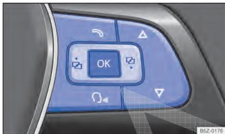
**Fig. 41** Lado direito do volante multifunções: teclas de comando.
