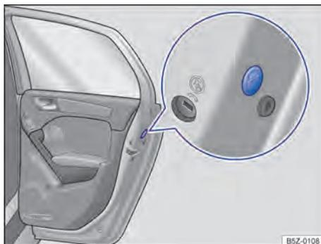
Fig. 52 Na porta traseira: travamento de emergência, coberto por uma vedação de borracha.
