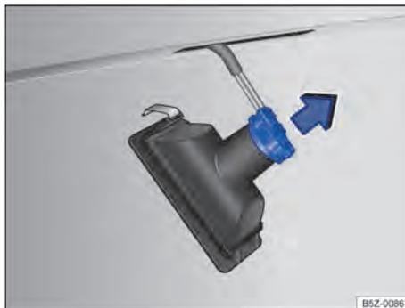
Fig. 146 Lanterna da placa de licença: remover o soquete da lâmpada.
