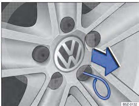
Fig. 178 Retirar as capas de cobertura dos parafusos da roda.
