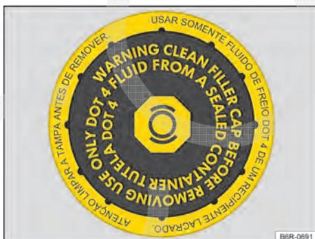
Fig. 168 No compartimento do motor: tampa do reservatório de fluido de freio (variante 1).
