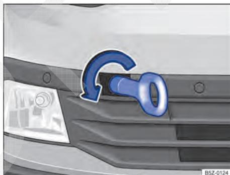
**Fig. 158** No para-choque dianteiro à direita: rosquear a argola de reboque.
