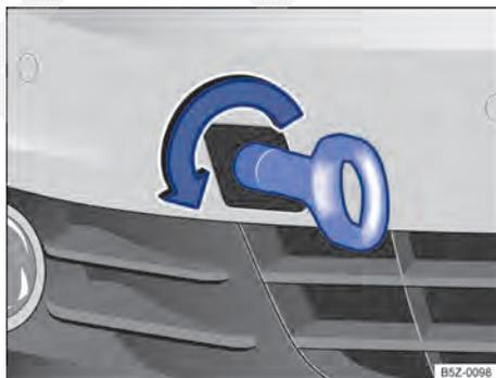
Fig. 156 No para-choque dianteiro à direita: rosquear a argola de reboque.
