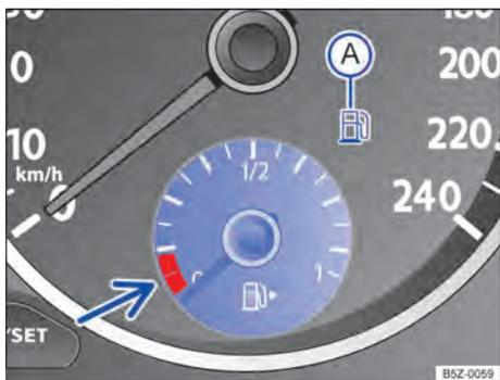
Fig. 34 No instrumento combinado: indicador do nível de combustível.
