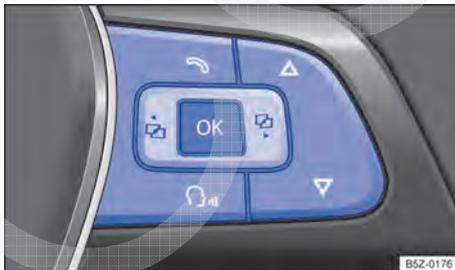
**Fig. 39** Lado direito do volante multifunções: teclas de comando dos menus do instrumento combinado.
