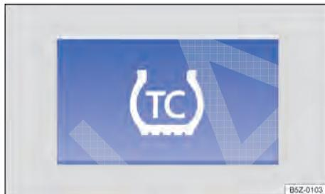
**Fig. 112** No console central: botão para desligar e ligar TC (controle de tração) manualmente.
