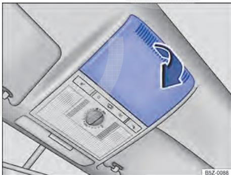
**Fig. 60** No revestimento do teto: remover a cobertura.
