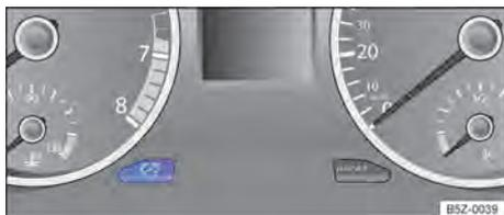
**Fig. 73** No instrumento combinado: botão de regulação da iluminação dos instrumentos e dos interruptores.
