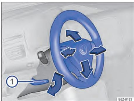
Fig. 62 Ajustar a posição do volante.
