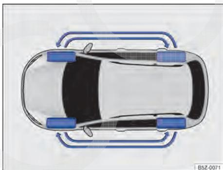
**Fig. 173** Esquema para a troca das rodas.
