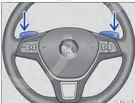
**Fig. 99** Volante com dois seletores para troca de marcha no modo manual.
