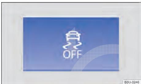
**Fig. 111** No console central: botão para desligar e ligar ASR manualmente.
