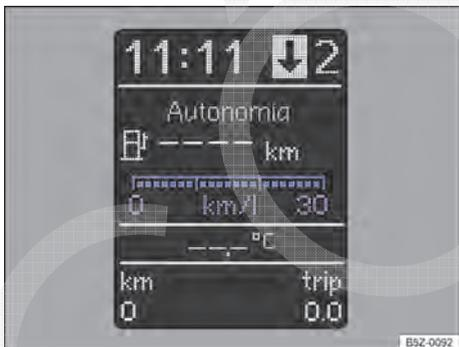
**Fig. 37** No instrumento combinado: indicador de consumo de combustível.
