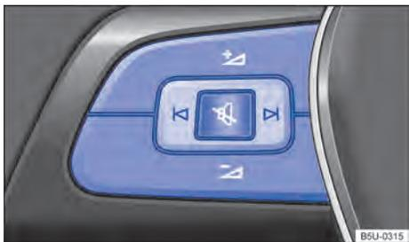
**Fig. 40** Lado esquerdo do volante multifunções: teclas de comando.
