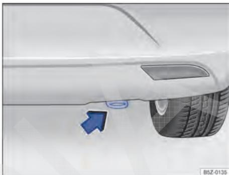
Fig. 159 No para-choque traseiro à direita: argola de reboque.
