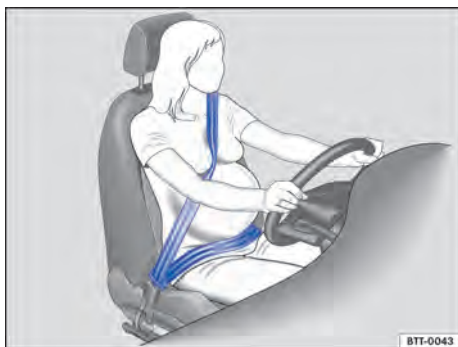
Fig. 28 Posição correta do caderço do cinto de segurança para mulheres grávidas.
