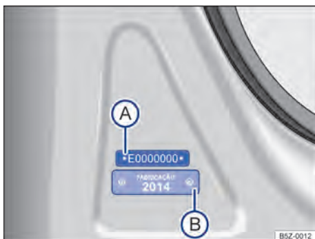
Fig. 197 Na coluna da porta dianteira direita: etiqueta com o número de identificação do veículo parcial (A) e etiqueta de identificação do ano de fabricação (B).
