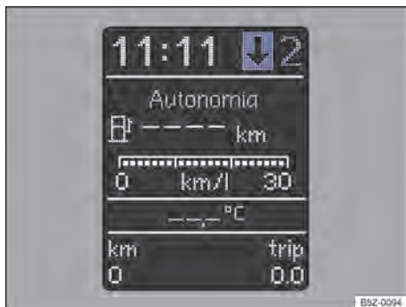
Fig. 81 No instrumento combinado: indicador de troca de marcha (variante 1).
