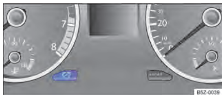
Fig. 69 No instrumento combinado: botão de regulagem da iluminação dos instrumentos e dos interruptores.
