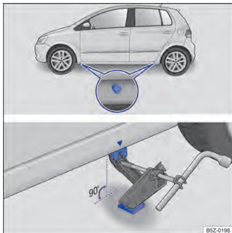
Fig. 193 Pontos de apoio do macaco e macaco posicionado no lado esquerdo traseiro do veículo.
