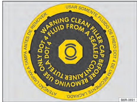
Fig. 180 No compartimento do motor: tampa do reservatório de fluido de freio (variante 1).
