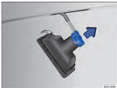
Fig. 158 Lanterna da placa de licença: remover o soquete da lâmpada.
