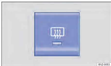
Fig. 79 No console central: botão do desembaçador do vidro traseiro.
