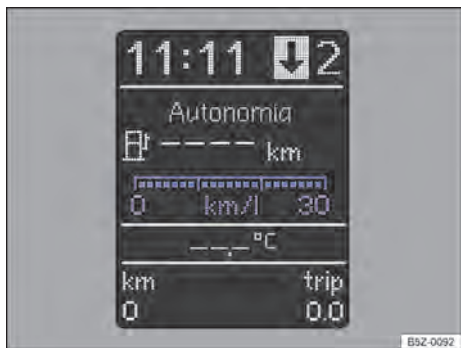
Fig. 14 No instrumento combinado: indicador de consumo de combustível.
