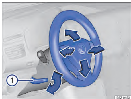
Fig. 58 Ajustar a posição do volante.
