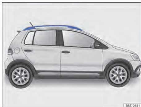
Fig. 140 Suportes longitudinais do bagageiro do teto (ambos os lados)
