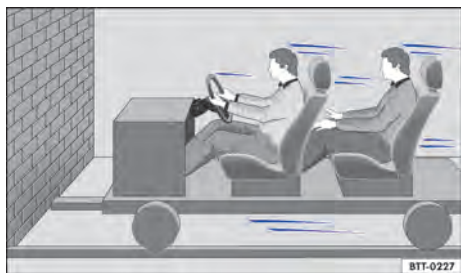
Fig. 20 Um veículo com os ocupantes sem cintos de segurança está em rota de colisão com um muro.
