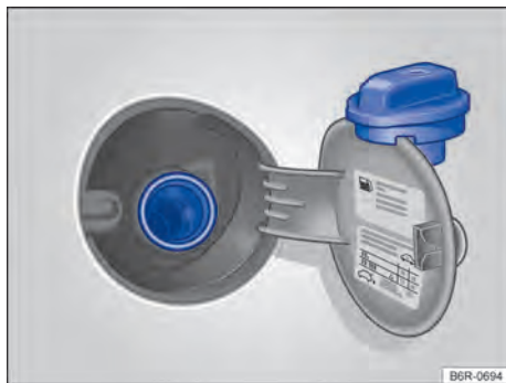
Fig. 142 Portinhola do tanque de combustível aberta com a tampa do tanque de combustível pendurada.
