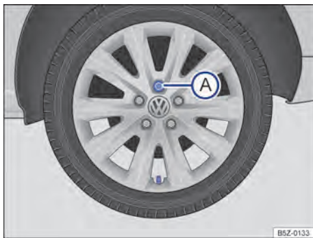
Fig. 191 Retirar a calota integral.
