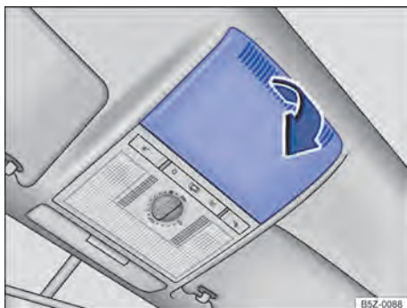
Fig. 56 No revestimento do teto: remover a cobertura.
