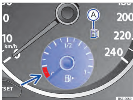
Fig. 11 No instrumento combinado: indicador do nível de combustível.
