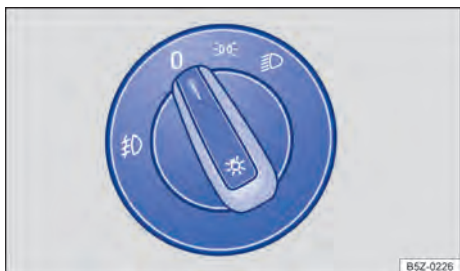
Fig. 67 No painel: interruptor das luzes.
