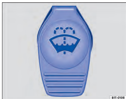
Fig. 175 No compartimento do motor: tampa do reservatório de água dos lavadores dos vidros.
