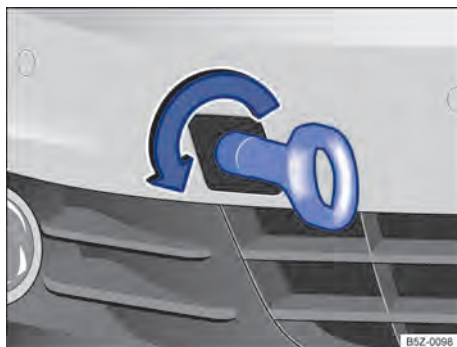
Fig. 168 No para-choque dianteiro à direita: rosquear a argola de reboque.
