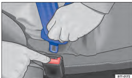
Fig. 26 Soltar a lingueta do cinto de segurança do fecho do cinto de segurança.
