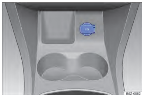
Fig. 106 No console central dianteiro: tomada 12 V.
