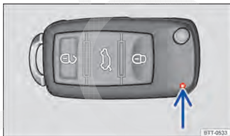
Fig. 23 Luz de controle da chave do veículo.
