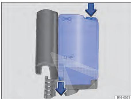
Fig. 218 No compartimento do motor: cobertura da caixa de fusíveis.
