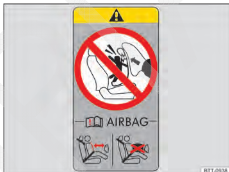
Fig. 77 Na coluna B do lado do passageiro dianteiro: etiqueta adesiva do airbag.
