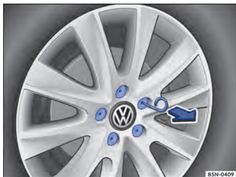
Fig. 210 Remover as capas de cobertura dos parafusos de roda.
