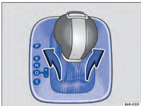
Fig. 203 Desinstalar a cobertura do quadro da alavanca seletora.
