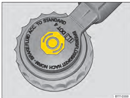
Fig. 141 No compartimento do motor: tampa do reservatório do fluido de freio.
