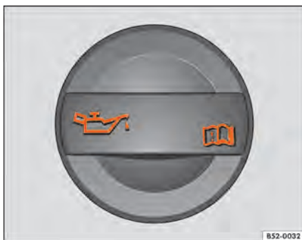
Fig. 179 No compartimento do motor: tampa da abertura de enchimento de óleo do motor.
