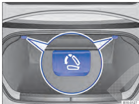
Fig. 95 No compartimento de bagagem: alavanca de destravamento para o encosto do banco traseiro.
