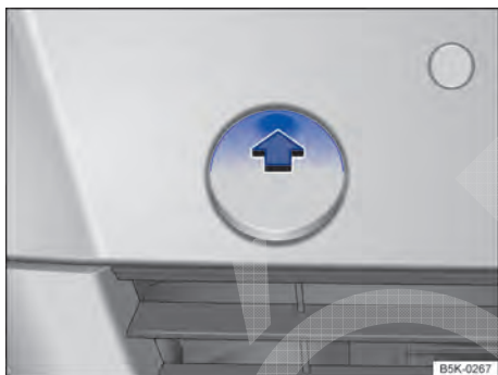
Fig. 238 No para-choque dianteiro à direita: retirar cobertura.
