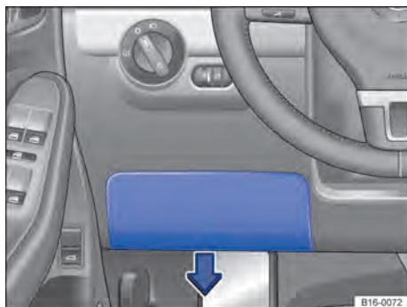
Fig. 217 No lado do condutor do painel de instrumentos: cobertura da caixa de fusíveis.
