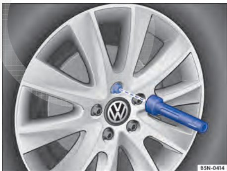
Fig. 215 Troca de roda: desparafusar os parafusos de roda com o punho da chave de fenda.
