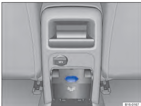
Fig. 124 Na parte traseira do console central: cobertura da tomada Euro de 230 Volt ou de 115 Volt aberta.
