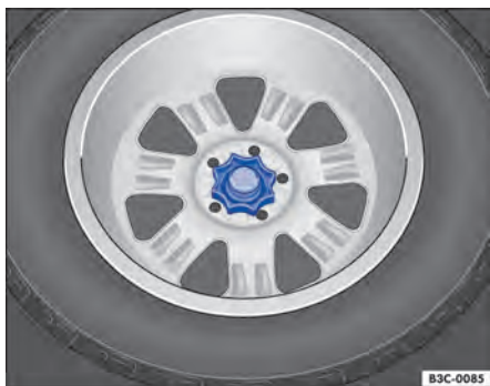
Fig. 189 No compartimento de bagagem: manípulo para fixação da roda sobressalente.
