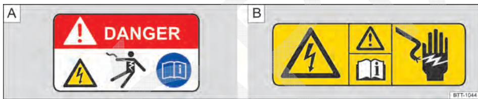
Fig. 148 Placas de advertência: A: componente de alta tensão, B: placa de advertência geral para alta tensão (representação princípio).
