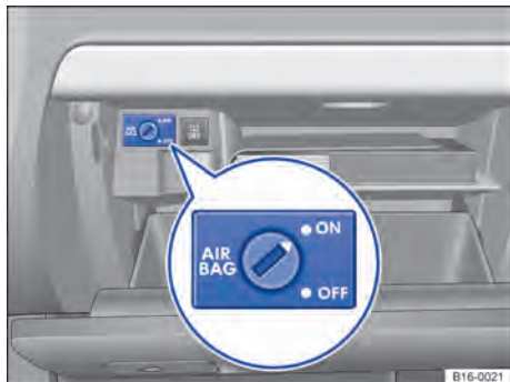
Fig. 71 No porta-luvas: interruptor acionado pela chave para desligar e ligar o airbag frontal do passageiro.
