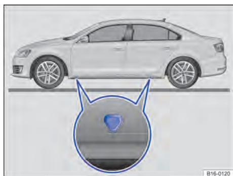
Fig. 213 Pontos de apoio do macaco.
