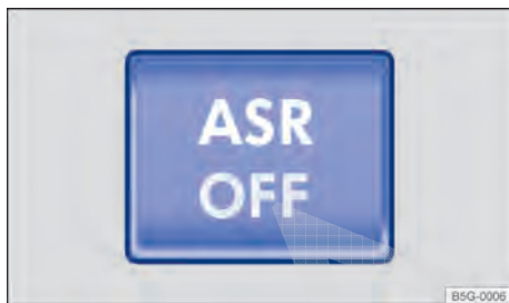
Fig. 140 Na parte inferior do console central: botão para desligar e ligar manualmente o ASR, ASR com ESC ou ESC Sport.
