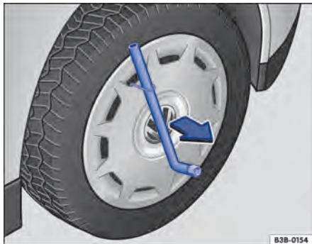
Fig. 209 Retirar a calota integral.
