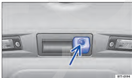
Fig. 158 Na tampa do compartimento de bagagem: local de instalação do assistente de condução em marcha à ré.
