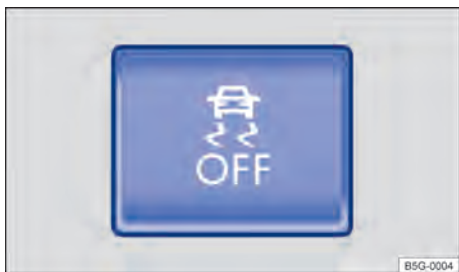
Fig. 139 Na parte inferior do console central: botão para desligar e ligar manualmente o ASR, ASR com ESC ou ESC Sport.
