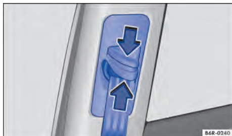
Fig. 67 Ao lado dos bancos dianteiros: regulagem de altura do cinto de segurança.
