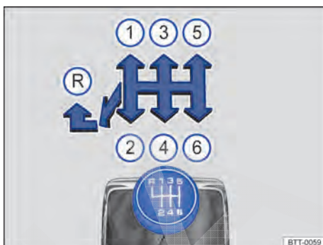
Fig. 133 Esquema de troca de marchas da transmissão manual de 6 marchas.
