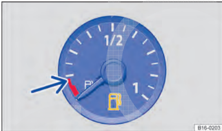
Fig. 171 No instrumento combinado: Indicador de reserva de combustível (variante 1).
