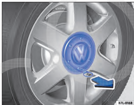
Fig. 207 Retirar a calota central.
