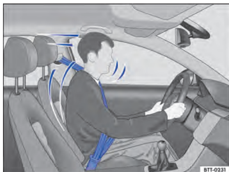
Fig. 62 Conductor protegido pelo cinto de segurança colocado corretamente em uma manobra de frenagem súbita.
