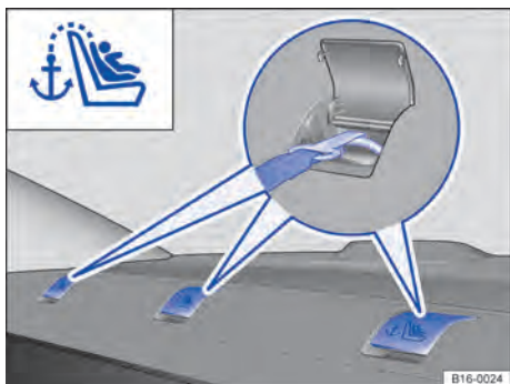
Fig. 79 Olhais de retenção na superfície atrás do encosto do banco traseiro.
