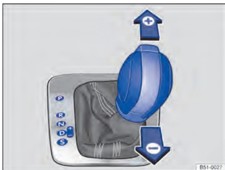
Fig. 136 Alavanca seletora na posição Tiptronic (veículos com direção à esquerda) e as indicações de direção à direita são espelhados.
