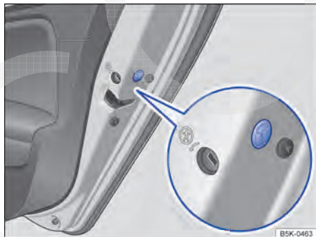
Fig. 197 Na parte dianteira da porta traseira direita: travamento de emergência, coberto por uma vedação de borracha.
