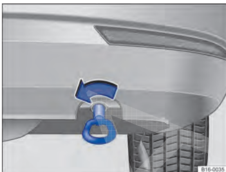
Fig. 241 No para-choque traseiro à direita: rosquear a argola de reboque.
