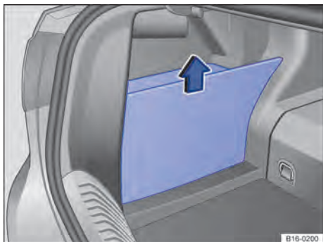
Fig. 184 Bateria do veículo no compartimento de bagagem: remover a cobertura da bateria do veículo.
