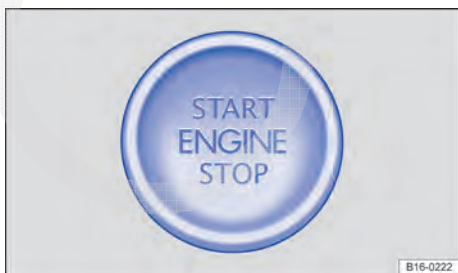
Fig. 127 Na parte inferior do console central: botão de partida do sistema de travamento e de partida Keyless Access. ▶
