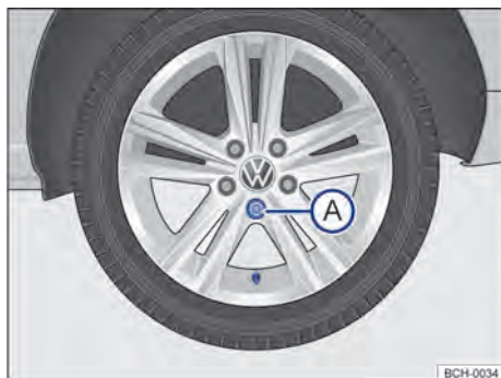
Fig. 193 Troca de roda: sequência de remoção dos parafusos da roda.
