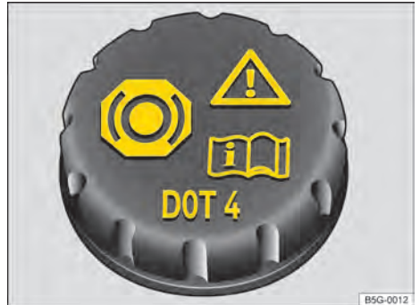
Fig. 181 No compartimento do motor: tampa do reservatório de fluido de freio.
