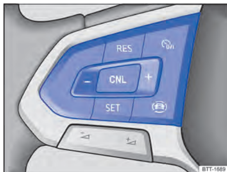
Fig. 94 Lado esquerdo do volante multifunções: botões para comandar o limitador de velocidade.
