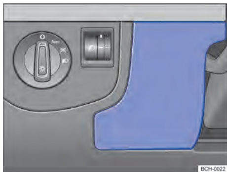
Fig. 165 No lado do condutor do painel de instrumentos: cobertura da caixa de fusíveis.
