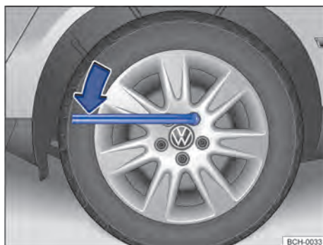
Fig. 190 Troca de roda: soltar os parafusos da roda.
