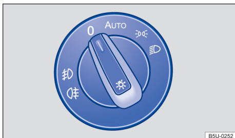
Fig. 79 No painel: interruptor das luzes.
