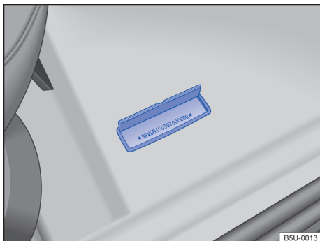
Fig. 206 Em frente ao banco do passageiro: número de identificação do veículo (número do chassi) no assoalho, em frente ao banco do passageiro dianteiro.
