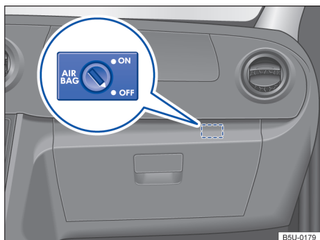
Fig. 46 No porta-luvas (Nova Saveiro Robust): interruptor desacionado pela chave para desligar e ligar o airbag frontal do passageiro.
