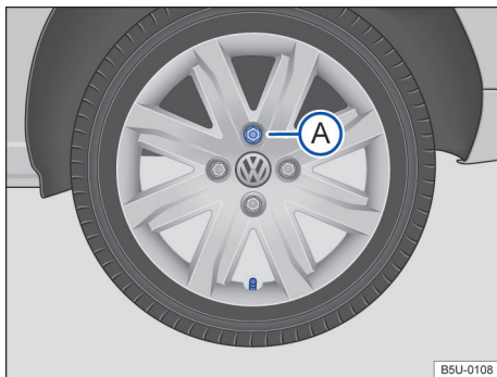
Fig. 196 Retirar a supercalota.
