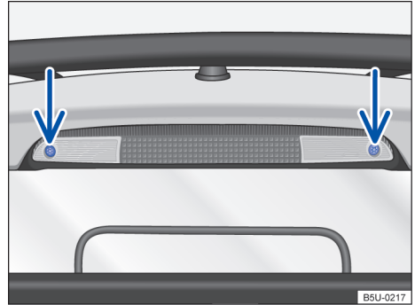
Fig. 168 No compartimento de carga: remover a lanterna de freio elevada.
