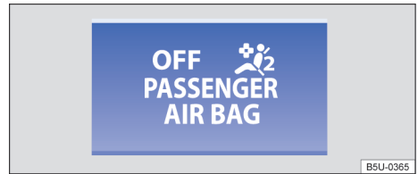
Fig. 40 Luz de controle no painel de instrumentos para o airbag frontal do passageiro desligado.
