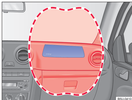
Fig. 44 Local de instalação e área de expansão do airbag frontal do passageiro. ▶
