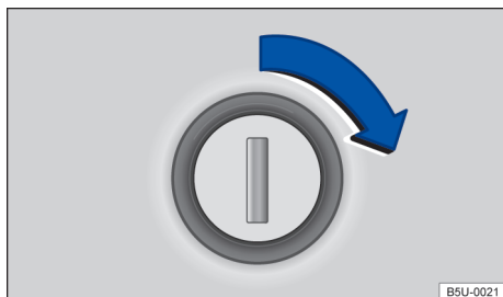
Fig. 63 Cilindro da fechadura para trancar e destrancar a tampa do compartimento de carga.
