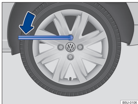
Fig. 197 Troca de roda: soltar os parafusos da roda.
