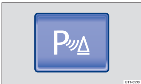
Fig. 110 Na parte superior do console central: botão para ligar e desligar o controle de distância de estacionamento (Park Pilot).
