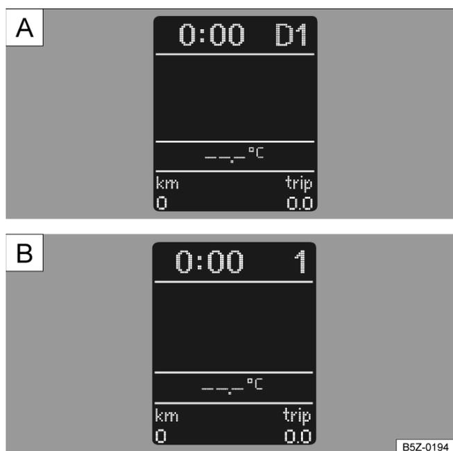
**Fig. 99** (A) Posições da alavanca seletora no display: indicação da alavanca no modo de condução automatizada (Modo normal), com a 1ª marcha engatada. (B) Posições da alavanca seletora no display: modo de condução manual, com a 1ª marcha selecionada.
