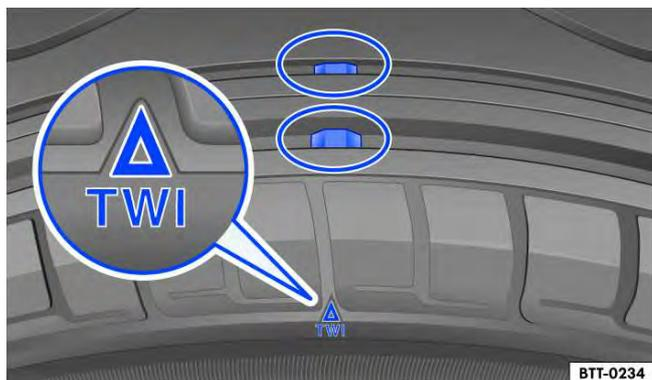
Fig. 174 Perfil do pneu: indicadores de desgaste.
