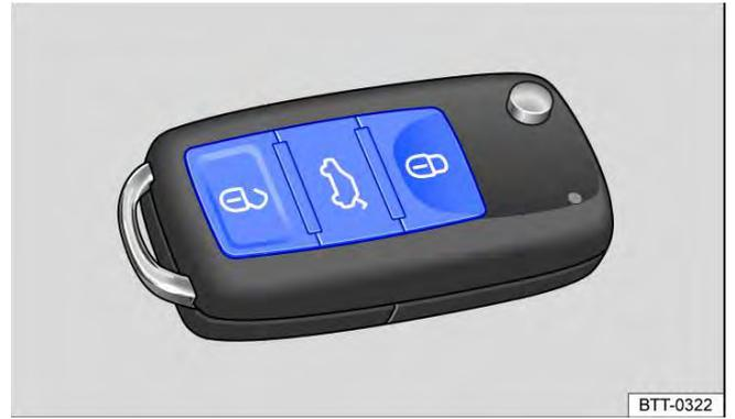
Fig. 51 Teclas na chave do veículo com comando remoto.
