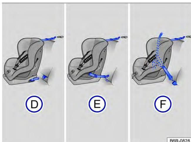
**Fig. 18** No banco traseiro: as figuras (D) e (E) mostram o princípio da fixação do sistema de retenção para crianças nos olhais de retenção inferiores e com o cinto de fixação superior. A figura (F) mostra a fixação do sistema de retenção para crianças com o cinto de segurança do veículo e com o cinto de fixação superior.
