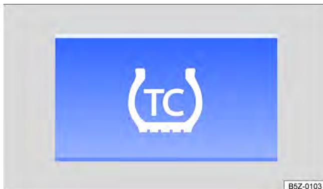
**Fig. 113** No console central: botão para desligar e ligar TC (controle de tração) manualmente.
