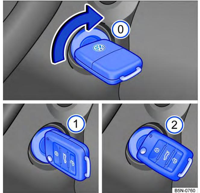
Fig. 95 Ao lado do volante, à direita: posições da chave do veículo no cilindro da ignição.
