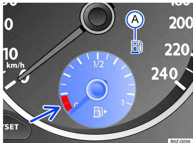
**Fig. 38** No instrumento combinado: indicador do nível de combustível.
