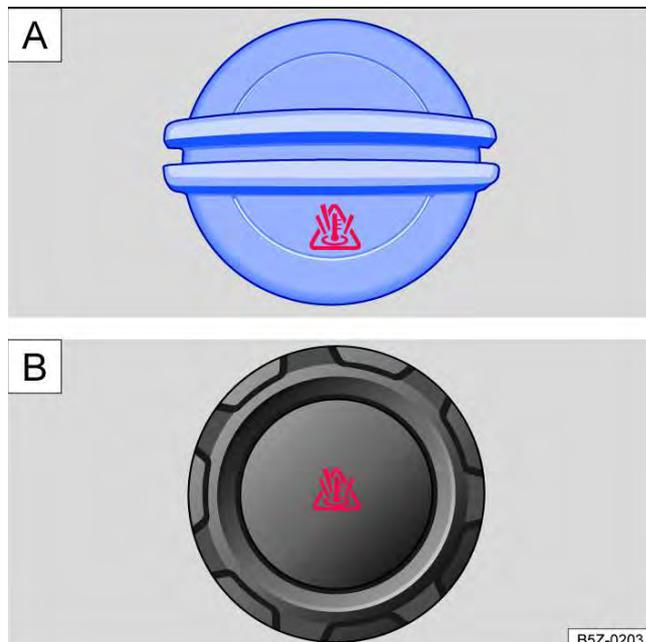
**Fig. 166** No compartimento do motor: **A** tampa do reservatório de expansão do líquido de arrefecimento do motor (variante 1) ou **B** tampa do reservatório de expansão do líquido de arrefecimento do motor (variante 2).
