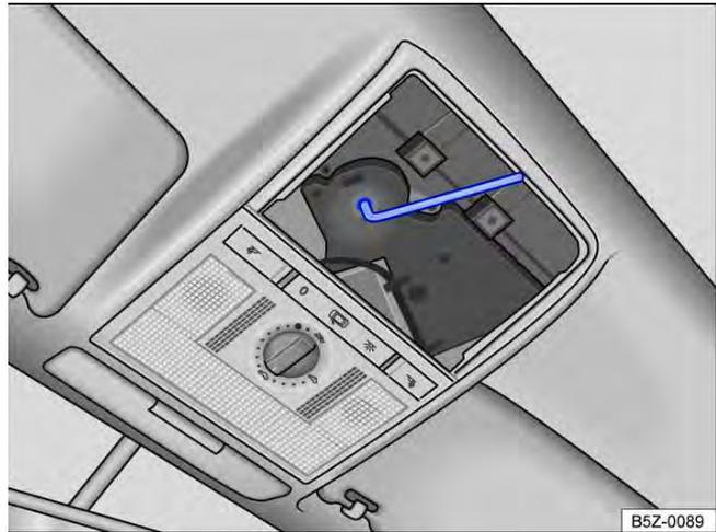
**Fig. 64** Parafuso sextavado para fechamento do teto solar.
