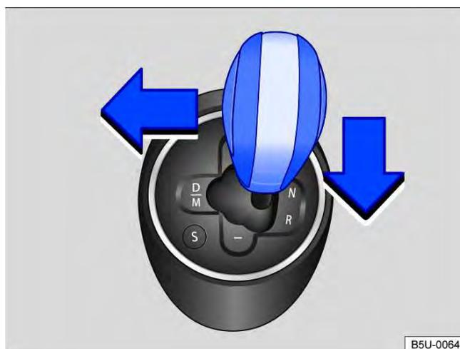
**Fig. 100** Alavanca seletora da transmissão automatizada ASG.
