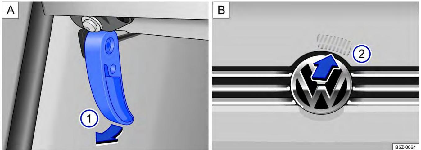
**Fig. 160** A: alavanca de destravamento na área para os pés do lado do condutor (1). B: alavanca de destravamento na parte interna da tampa do compartimento do motor (2).
