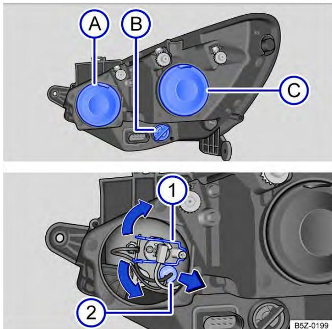
**Fig. 137** No compartimento do motor: vista traseira do farol dianteiro direito com cobertura de borracha (esquerda): **A** farol alto e luz de posição, **B** indicadores de direção e **C** farol baixo. Vista traseira do farol dianteiro direito sem cobertura de borracha (direita): **1** farol alto, **2** luz de posição.
