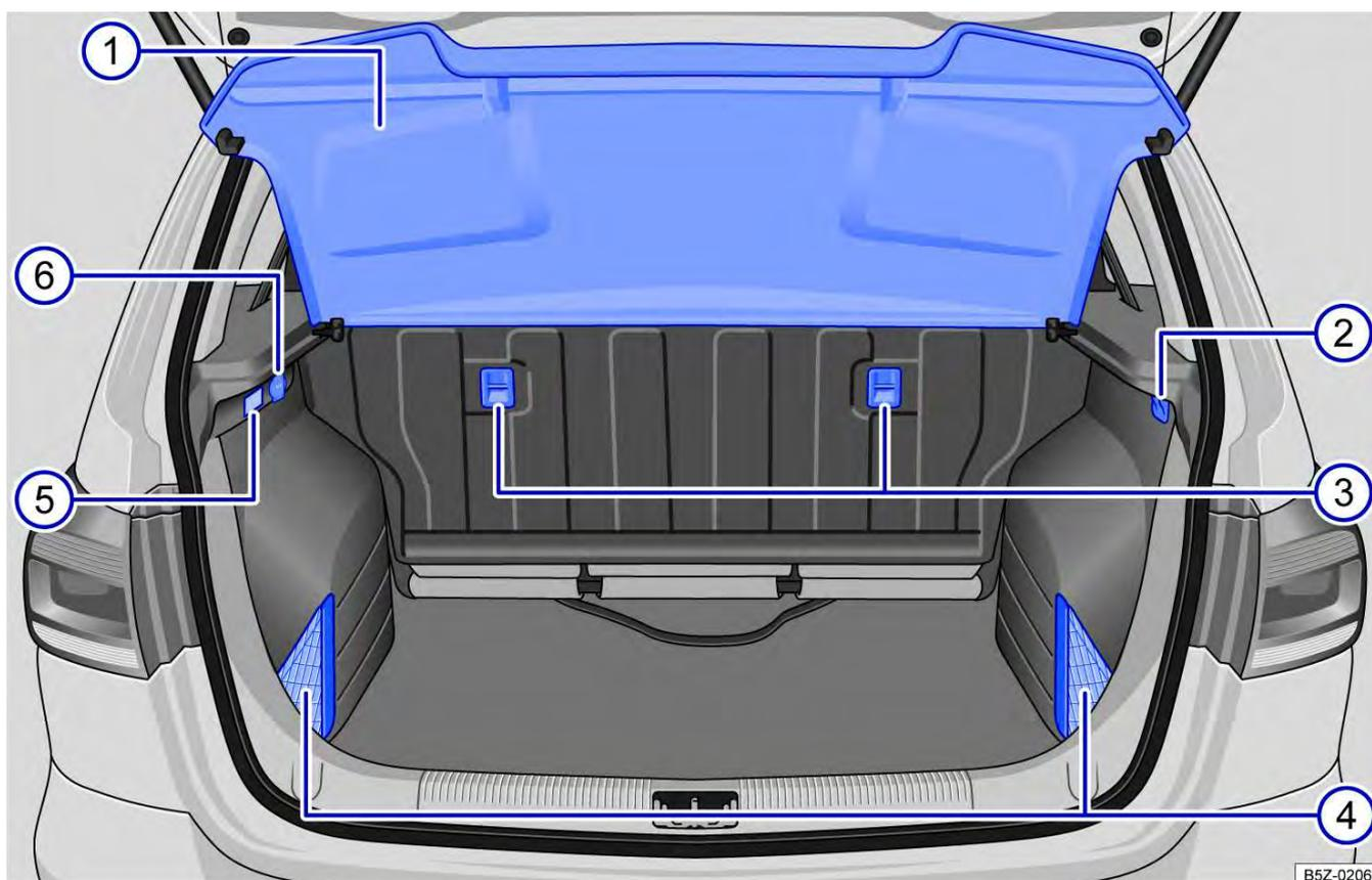
Fig. 34 Vista geral do compartimento de bagagem.
