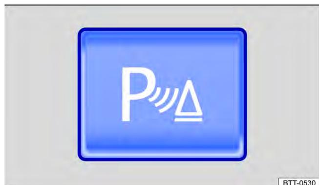
**Fig. 109** Na parte superior do console central: botão para ligar e desligar o controle de distância de estacionamento (Park Pilot).
