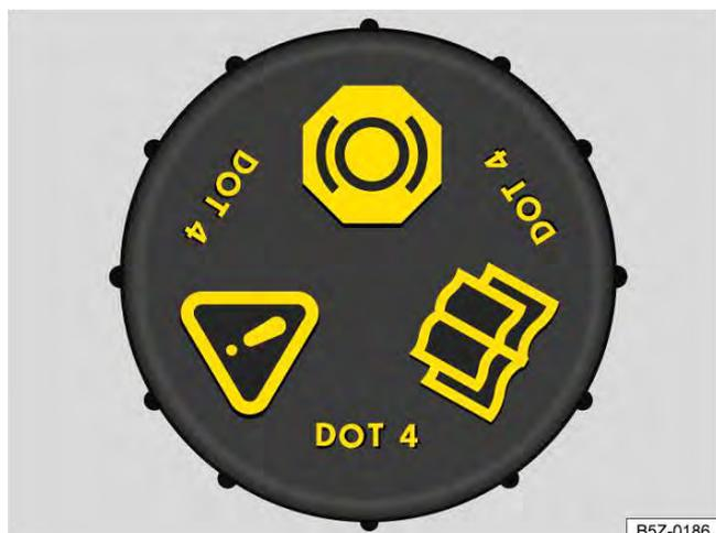
Fig. 168 No compartimento do motor: tampa do reservatório de fluido de freio (variante 2).
