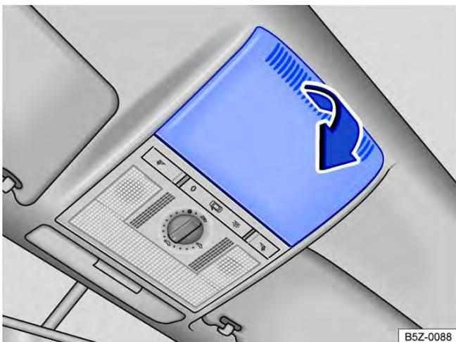
**Fig. 63** No revestimento do teto: remover a cobertura.
