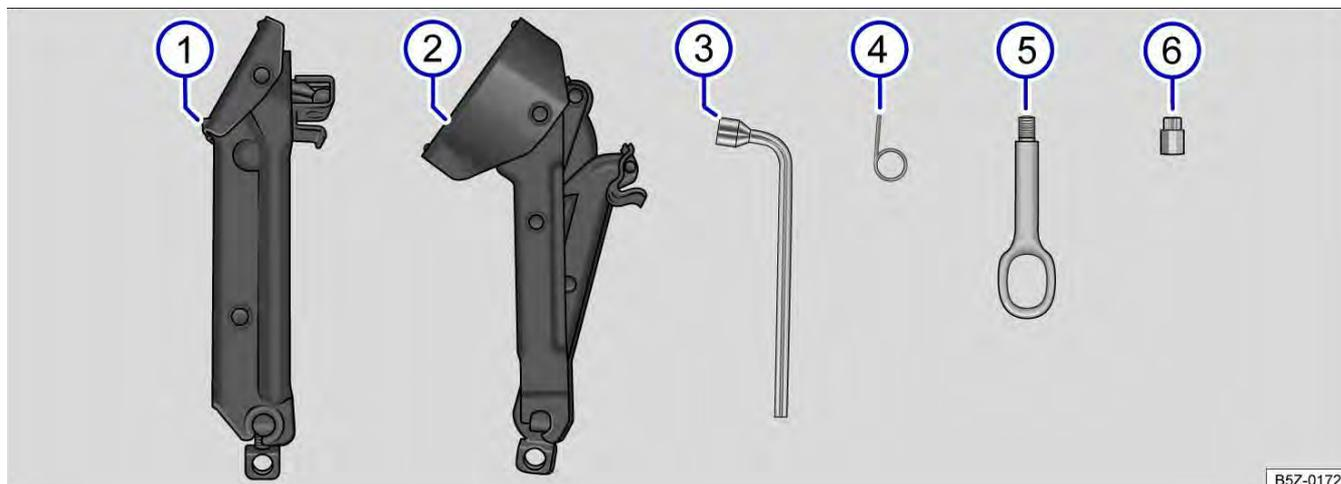
**Fig. 133** Representação esquemática: componentes das ferramentas de bordo.
