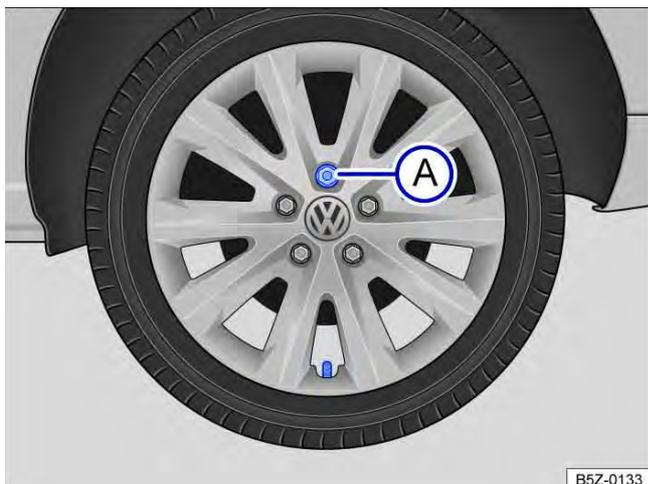
Fig. 178 Retirar a calota integral.
