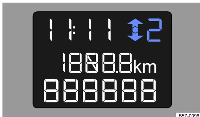
Fig. 93 No instrumento combinado: indicador de troca de marcha (variante 2).
