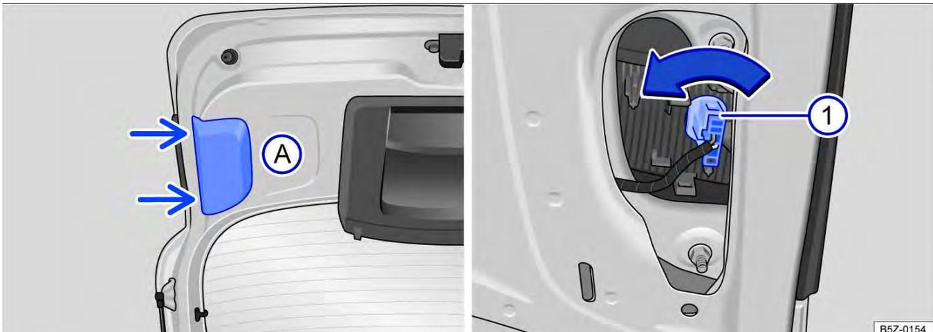
**Fig. 144** Na tampa traseira: remover a cobertura e lâmpada da lanterna direita e/ou da lanterna esquerda - para veículos sem lanterna de neblina.
